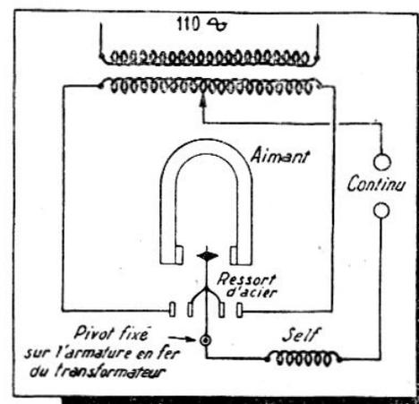
Le secondaire comprend un enroulement de 134 tours de fil de 16/10 millimètres de diamètre (isolé sous coton), le point milieu, donc, au potentiel zéro, formant un des pôles du courant continu et les deux extrémités du fil allant aux deux contacts de chaque côté de la lame vibrante. Le primaire, enroulé en quatre couches par-dessus le secondaire, comprend 520 tours
