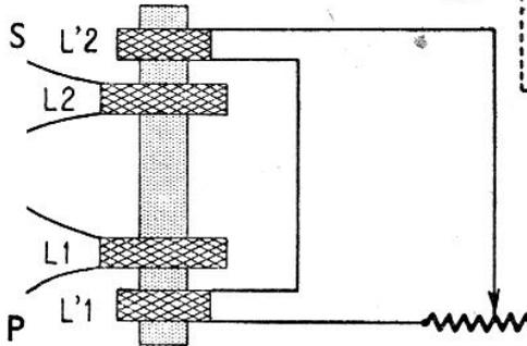
Le nombre de spires est assez faible : 275 spires pour chacune des bobines L1 et L2. La largeur du bobinage est de 6 millimètres. Le blindage a un diamètre de 50 millimètres. Les bobines de couplage ont chacune 40 spires et sont écartées de 5 millimètres des bobines L1 et L2.
