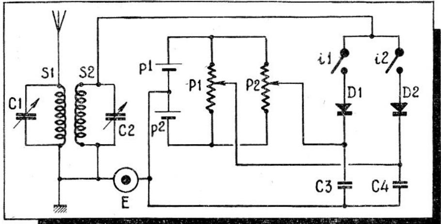
de recevoir sur la même longueur d'onde une émission faible au milieu de plusieurs transmissions puissantes. Pratiquement même, si le réglage du potentiomètre est fait soigneusement, les émissions fortes seront entièrement éliminées, seule l'émission faible demeurera audible.
