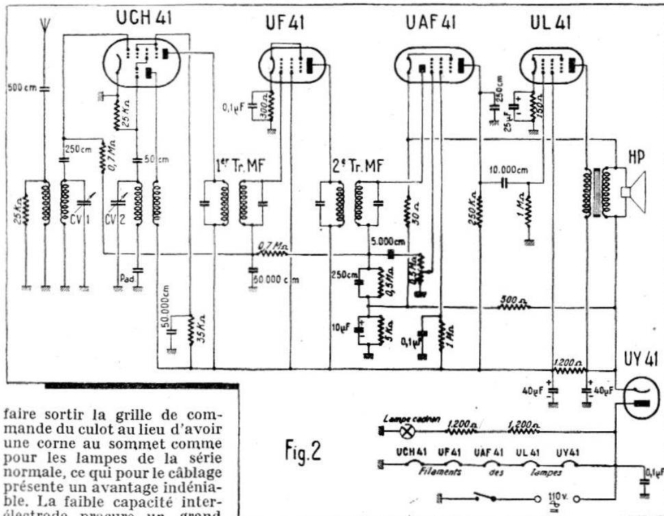
faire sortir la grille de commande du culot au lieu d'avoir une corne au sommet comme pour les lampes de la série normale, ce qui pour le câblage présente un avantage indéniable. La faible capacité inter-électrode procure un grand
