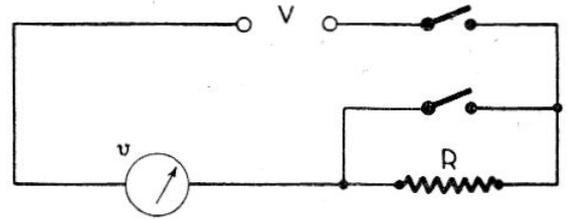
Pour être placé dans de bonnes conditions de mesure, il est indiqué de prendre une résistance de l'ordre de grandeur de celle du voltmètre. Des mesures faites sur un contrôleur n'ont pas permis de conclure formellement, l'expérimentation ayant été effectuée avec une pile de lampe de poche de 4,5 volts et des résistances quelconques. Néanmoins, voici les résultats :
