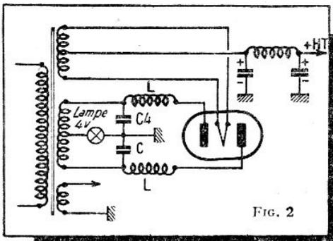
utilisé pour arrêter les parasites à l'entrée d'un récepteur, mais dans ce cas, quatre condensateurs, C1, C2, C3 et C4 et deux bobines L1 et L2 suffisent généralement, mais, bien entendu, il n'agit que sur les parasites transmis par le secteur et n'a aucun effet sur ceux, les plus nombreux, qui sont captés par l'antenne.
