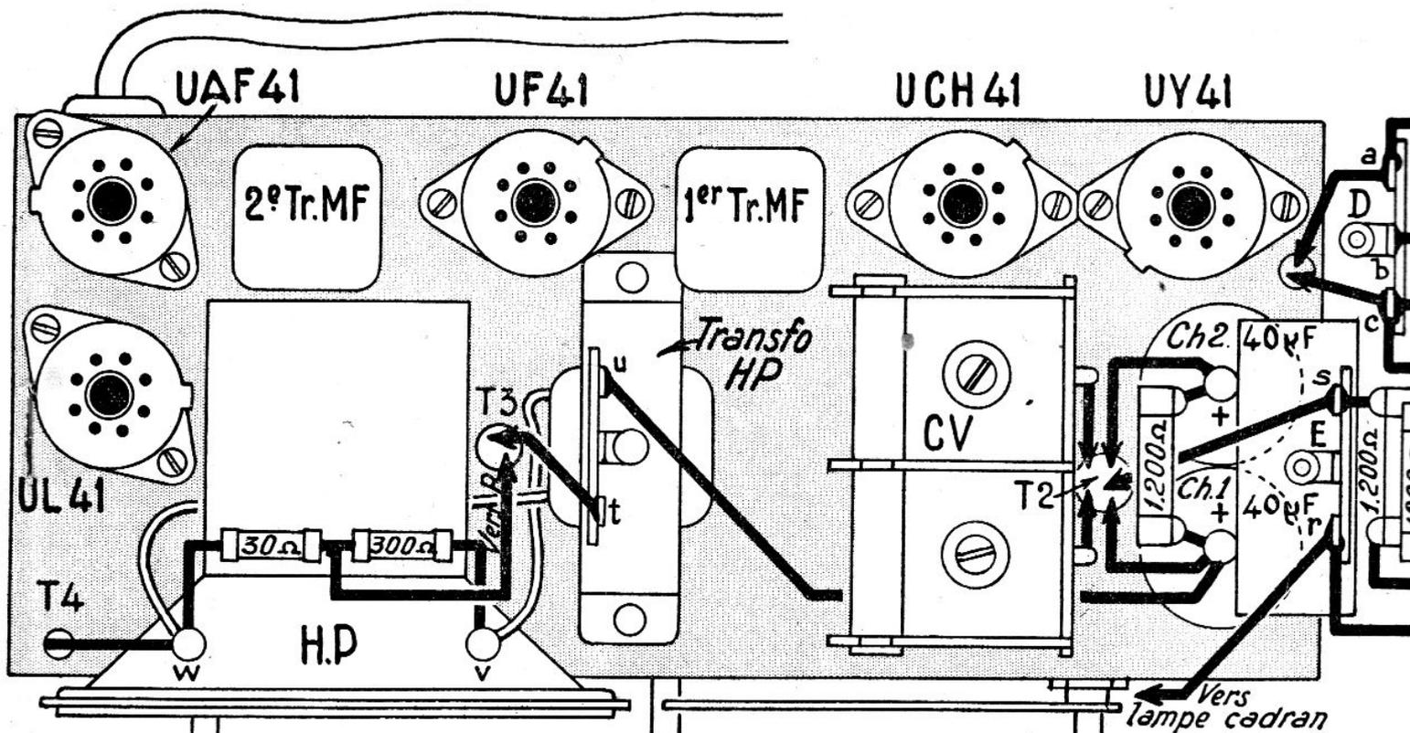
on soude aussi un fil qui passe par le trou T4 et qui aboutit à la cosse 7 du support de la UAF41. Au point de jonction des résistances de 300 et 30 ohms, on soude un fil qui passe par le trou T3 et qui vient se souder sur la cosse p du relais B.
