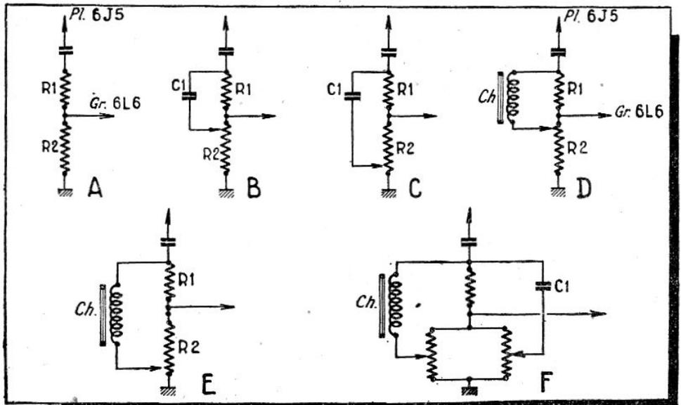
sont transmises à la lampe de sortie que par l'intermédiaire d'un diviseur de tension dont la branche inférieure est constituée par les deux potentiomètres de 0,5 mégohm en parallèle et la branche supérieure par une résistance fixe de 2 mégohms.
