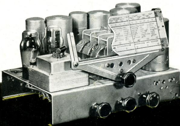
**Caractéristiques :** Changeur de fréquence à 4 lampes plus une valve. - 3 gammes de longueur d'ondes : 19 à 53 m., 190 à 570 m. et 1.000 à 2.000 m. - *Dispositif antiparasites et antifading.* *Contrôle de tonalité variable.* - Haut-parleur électrodynamique, avec dispositif *supra-sonore.*
