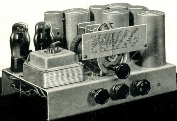
**Caractéristiques :** Changeur de fréquence à 4 lampes plus une valve. - Gamme de 190 à 2.000 m. de longueur d'ondes. - Circuit antifading. Deux tonalités. - Haut-parleur électrodynamique, excellente musicalité.
