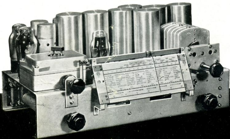
**Caractéristiques :** Changeur de fréquence à 9 lampes plus 1 valve. - Gamme de 10 à 2.000 m. de longueur d'ondes. - Changement de fréquence par 2 lampes. - Lampes et dispositif *antifading*. - Détectrice diode et penthode à *réglage silencieux*. - Musicalité inégalée grâce à la basse fréquence équipée avec 2 lampes en push-pull. - *Relief musical* obtenu grâce à 2 haut-parleurs électrodynamiques donnant des tonalités différentes. - *Contrôle de tonalité*.
