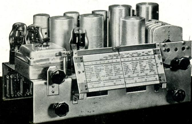
**Caractéristiques :** Changeur de fréquence à 6 lampes plus une valve. - Basse fréquence sortie en push-pull. - 3 gammes de longueur d'ondes : 19 à 53 m., 190 à 570 m. et 1.000 à 2.000 m. - *Dispositif antiparasites et antifading. Contrôle de tonalité variable.* - Haut-parleur électrodynamique 240 <sup>HP</sup> avec dispositif *supra-sonore.*
