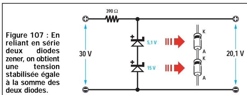
Figure 107 : En reliant en série deux diodes zener, on obtient une tension stabilisée égale à la somme des deux diodes.
