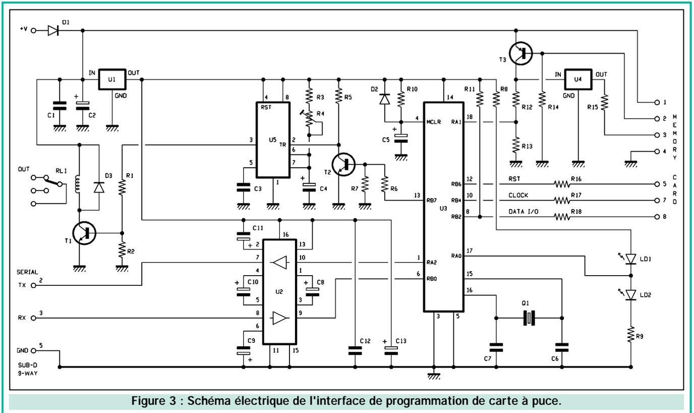
Figure 3 : Schéma électrique de l'interface de programmation de carte à puce.
