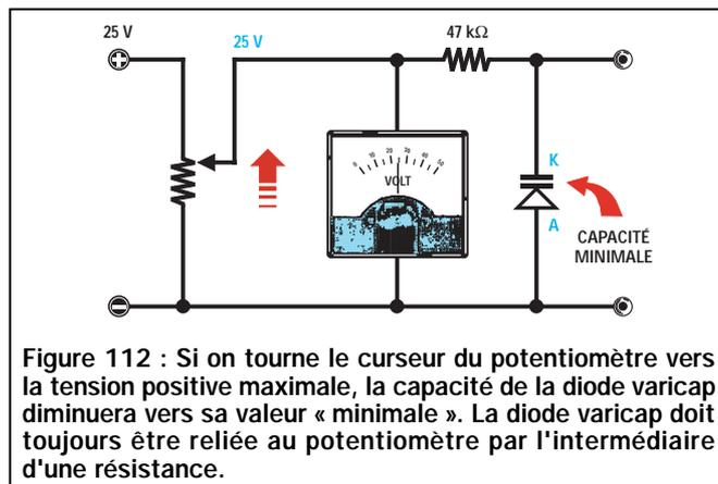
Figure 112 : Si on tourne le curseur du potentiomètre vers la tension positive maximale, la capacité de la diode varicap diminuera vers sa valeur « minimale ». La diode varicap doit toujours être reliée au potentiomètre par l'intermédiaire d'une résistance.
