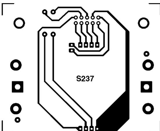
Figure 7 : Circuit imprimé échelle 1/1 de la platine interface PC-lecteur/enregistreur.
