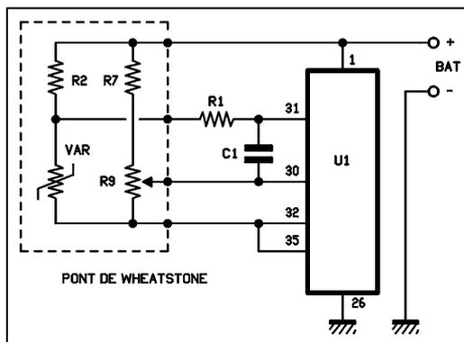
A  $-50^\circ\text{C}$ , il y a une baisse de  $-50 \text{ mV}$ . A  $0^\circ\text{C}$ , il n'y a pas de chute de tension, alors qu'à  $+150^\circ\text{C}$ , la hausse est d'au moins 150 millivolts ( $150.0$  sur l'écran).
