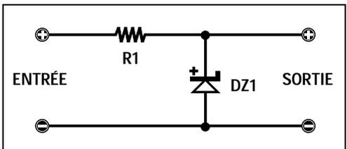
Figure 104 : La diode zener doit toujours être reliée à une tension par l'intermédiaire d'une résistance.
