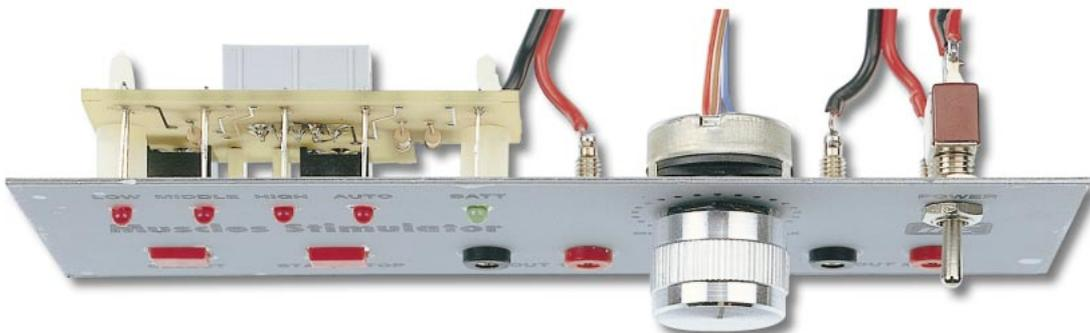
Figure 12 : Vous devez fixer au dos de la face avant du boîtier le petit circuit imprimé LX.1408/B avec deux entretoises en plastique auto-adhésives. Contrôlez, avant de souder les pattes des diodes LED sur le circuit imprimé, que leur tête dépasse bien des trous correspondants sur la face avant.
