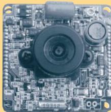
Contrôle de l'image par DSP. Élément sensible : CCD 1/4".
