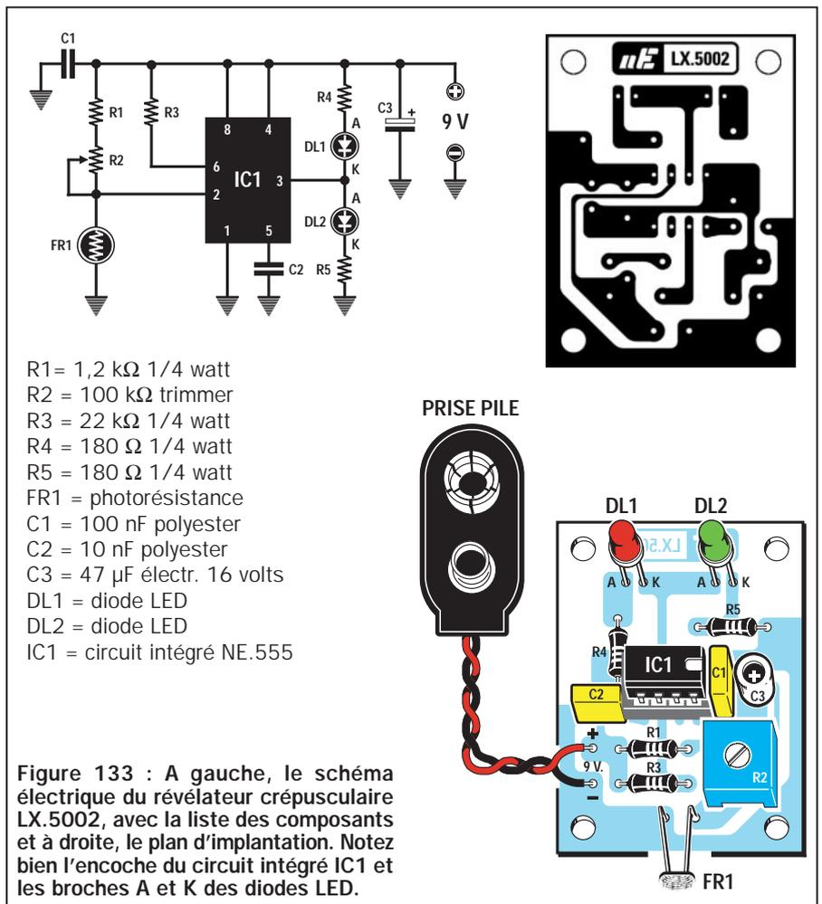
Figure 133 : A gauche, le schéma électrique du révélateur crépusculaire LX.5002, avec la liste des composants et à droite, le plan d'implantation. Notez bien l'encoche du circuit intégré IC1 et les broches A et K des diodes LED.
