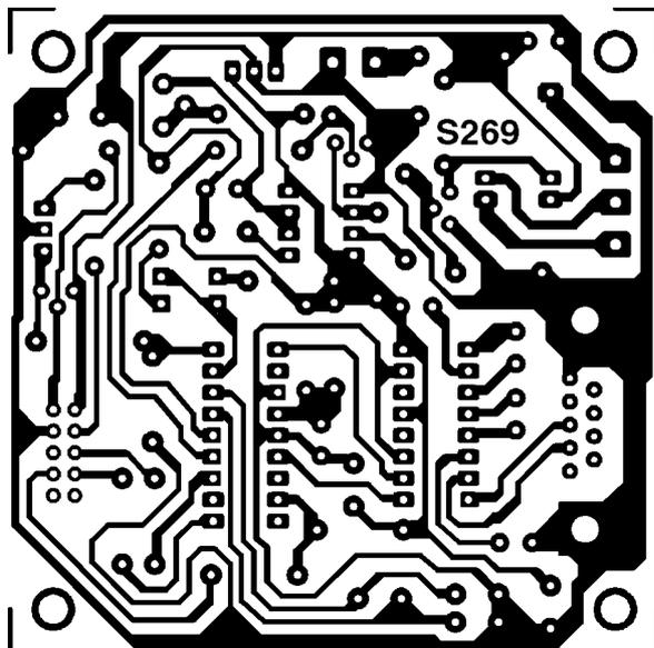
Figure 5 : Circuit imprimé échelle 1/1 de la platine de lecteur/enregistreur.
