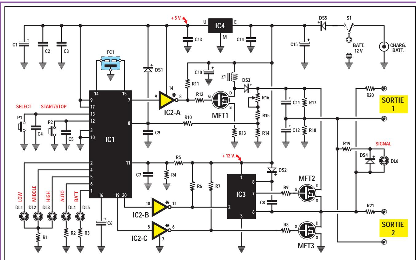
Figure 7 : Schéma électrique du stimulateur musculaire LX.1408. Le bouton poussoir P1 sert à sélectionner la vitesse Lente, Moyenne ou Rapide, ou à passer en mode automatique. Après avoir sélectionné l'une des quatre fonctions, avoir appliqué les plaques de caoutchouc sur son corps et réglé le potentiomètre R16 au minimum, vous pouvez actionner P2 (START/STOP).
