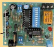
Pour radiocommande. Très bonne portée. Le nouveau module AUREL permet, en champ libre, une portée entre 2 et 5 km. Le système utilise un circuit intégré codeur MM53200 (UM86409). Décrit dans ELECTRONIQUE n° 1.
