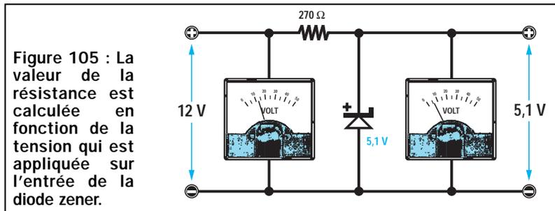
Figure 105 : La valeur de la résistance est calculée en fonction de la tension qui est appliquée sur l'entrée de la diode zener.
