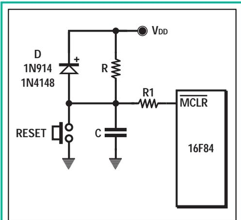
Figure 6 : Un circuit de reset manuel qui reste fort simple.
