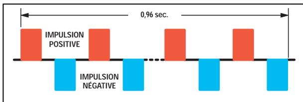
Figure 1 : Pour tonifier les muscles de façon efficace, il faut un train d'impulsions d'une durée totale de 0,96 seconde, composé de demi-ondes positives et négatives, séparées par une pause pour éviter l'électrolyse du sang.
