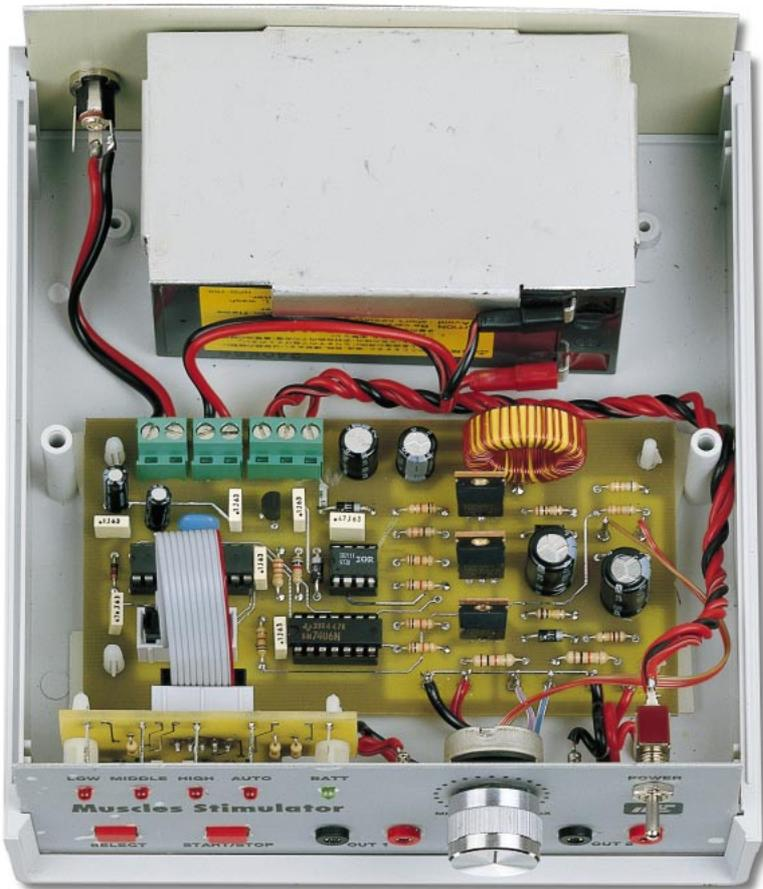
Figure 13 : Fixez la batterie rechargeable de 12 volts sur la face arrière avec le couvercle métallique fourni dans le kit. Fixez le circuit imprimé LX.1408 à l'intérieur du boîtier avec des entretoises auto-adhésives en plastique.
