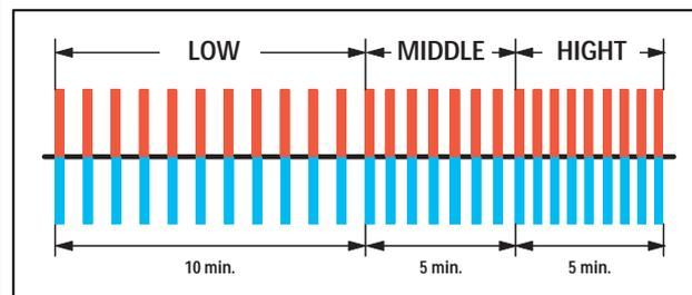
Figure 6 : Automatique. Avec cette fonction, après 10 minutes à vitesse lente on passe automatiquement en vitesse moyenne pendant 5 minutes, puis en vitesse rapide pendant 5 autres minutes.
