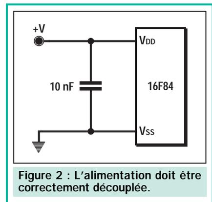
Figure 2 : L'alimentation doit être correctement découplée.
