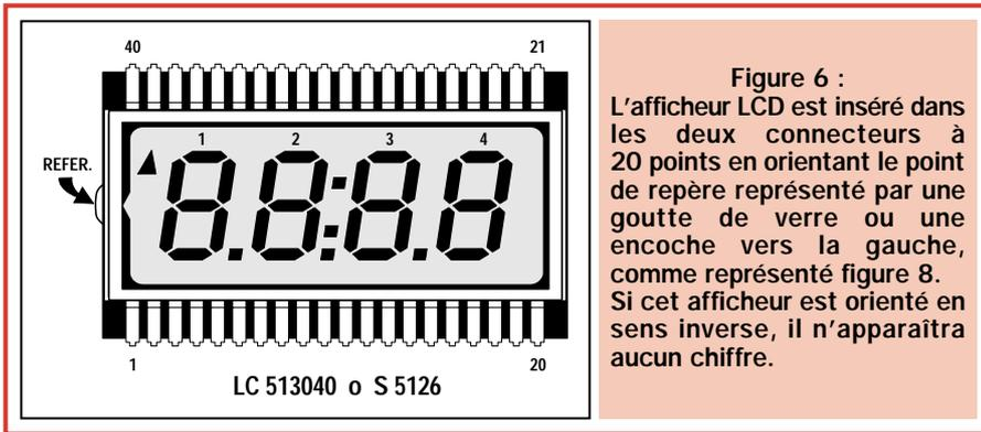
Figure 6 : L'afficheur LCD est inséré dans les deux connecteurs à 20 points en orientant le point de repère représenté par une goutte de verre ou une encoche vers la gauche, comme représenté figure 8. Si cet afficheur est orienté en sens inverse, il n'apparaîtra aucun chiffre.
