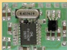
Pour rendre incompréhensible n'importe quelle communication via radio ou téléphone. Idéal pour CB, VHF et téléphone. Le circuit est basé sur le principe de l'inversion de bande et utilise l'intégré FX118DX. Le module fonctionne en full duplex et est réalisé en CMS. Ses dimensions sont de 2,5 x 3 cm. Les connexions sont au pas de 2,54 mm. Décrit dans ELECTRONIQUE n° 1.
