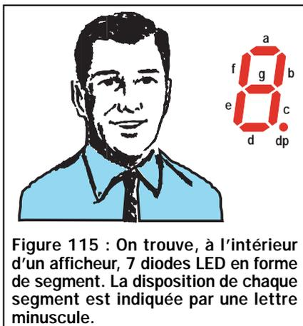
Figure 115 : On trouve, à l'intérieur d'un afficheur, 7 diodes LED en forme de segment. La disposition de chaque segment est indiquée par une lettre minuscule.
