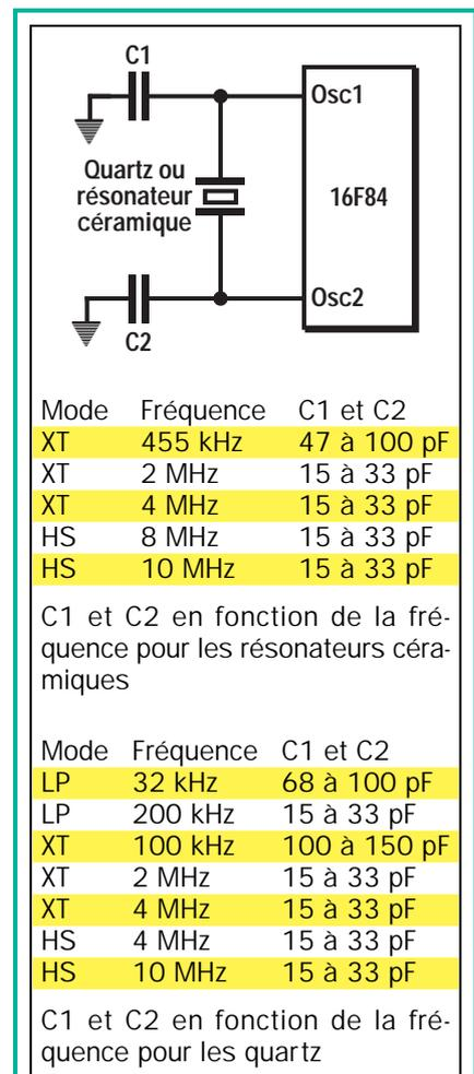
Figure 3 : Utilisation d'un quartz pour piloter l'oscillateur d'horloge.
