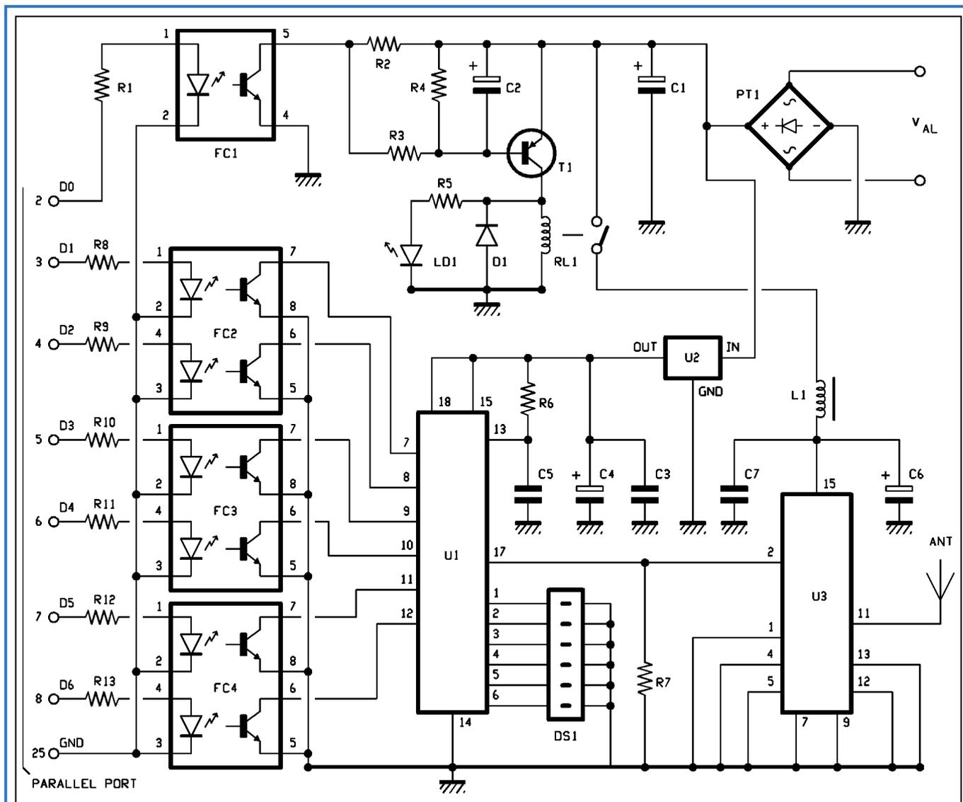
Figure 2 : Schéma électrique de la radiocommande 32 canaux.
