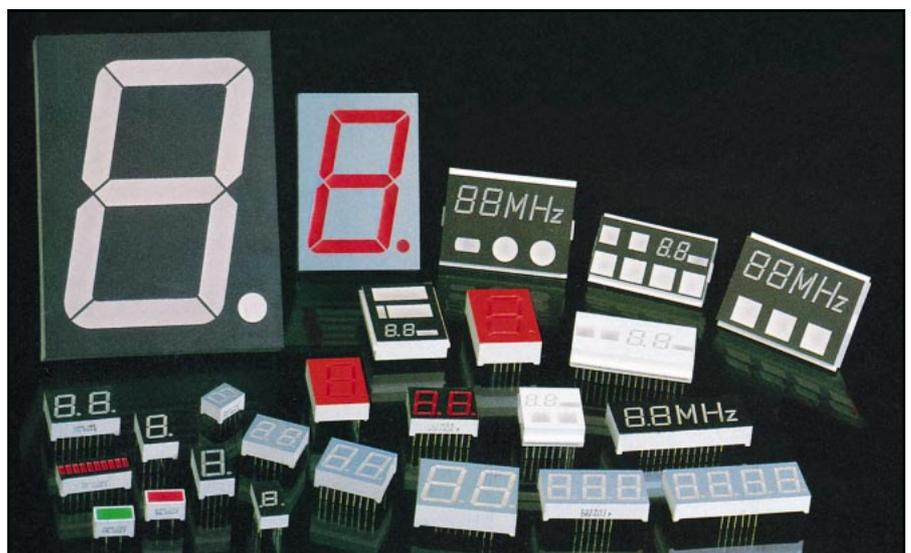
ficheur – nous permettent de connaître le segment qui s'allume quand on applique une tension continue sur la broche correspondante.
