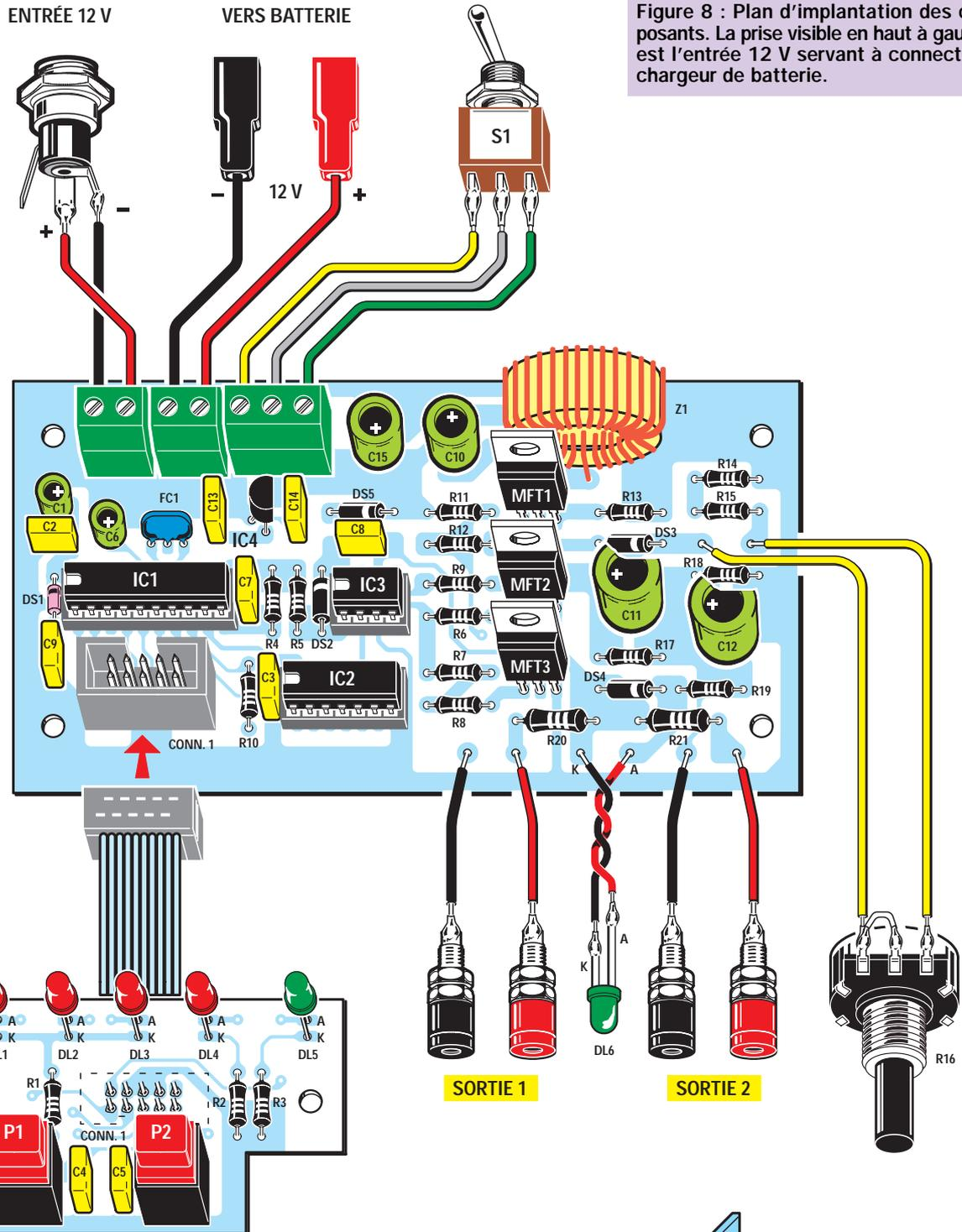
Figure 8 : Plan d'implantation des composants. La prise visible en haut à gauche, est l'entrée 12 V servant à connecter le chargeur de batterie.
