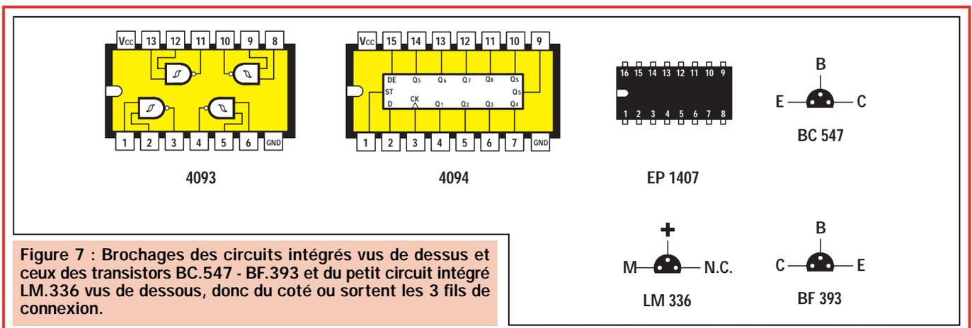
Figure 7 : Brochages des circuits intégrés vus de dessus et ceux des transistors BC.547 - BF.393 et du petit circuit intégré LM.336 vus de dessous, donc du côté où sortent les 3 fils de connexion.
