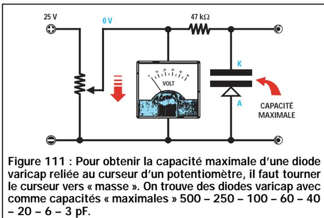
Figure 111 : Pour obtenir la capacité maximale d'une diode varicap reliée au curseur d'un potentiomètre, il faut tourner le curseur vers « masse ». On trouve des diodes varicap avec comme capacités « maximales » 500 - 250 - 100 - 60 - 40 - 20 - 6 - 3 pF.
