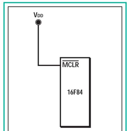
Figure 5 : Utilisation du circuit de reset interne à la mise sous tension.
