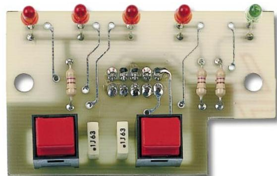
Figure 11 : Insérez, sur le circuit imprimé LX.1408/B, les deux boutons poussoirs et les diodes LED, ainsi que, sur le côté opposé, le connecteur pour le câble plat.
