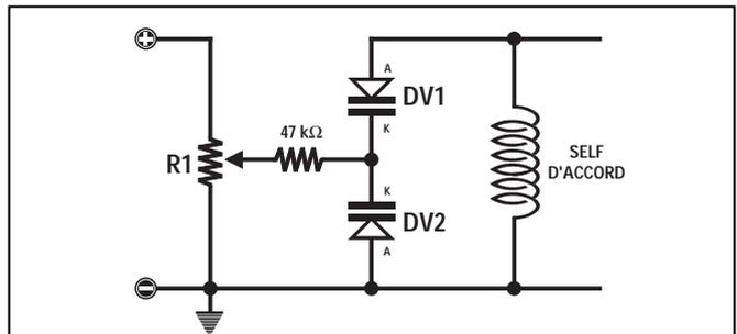
Figure 114 : Si on utilise une « double » diode varicap, en reliant les deux cathodes vers la résistance de 47 kΩ, on pourra éviter d'utiliser un condensateur C1, mais alors la capacité des deux diodes varicap sera diminuée.
