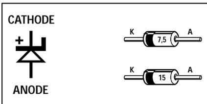
Figure 103 : Symbole graphique de la diode zener. La cathode se trouve du côté de la bague noire.
