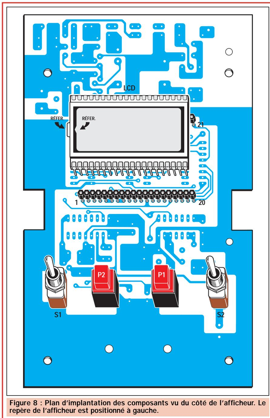
Figure 8 : Plan d'implantation des composants vu du côté de l'afficheur. Le repère de l'afficheur est positionné à gauche.
