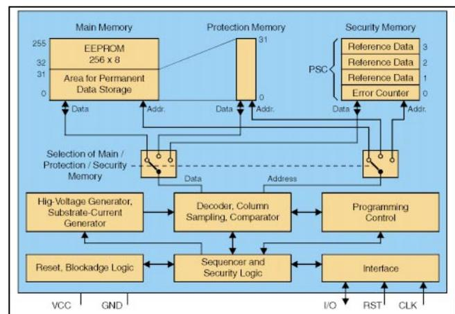
Figure 2 : Schéma de principe de la puce Siemens SLE4442.
