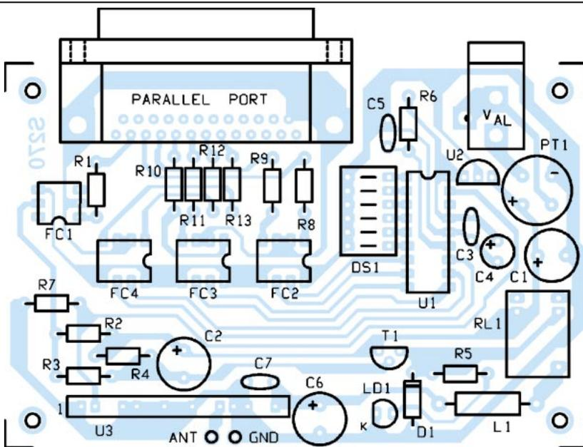
Figure 4 : Plan d'implantation des composants.
