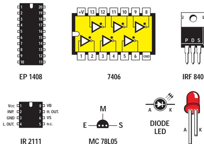
Figure 14 : Connexions des circuits intégrés, vues du dessus. Seul le circuit régulateur MC78L05 est vu du dessous, c'est-à-dire d'où sortent les trois pattes E-M-S. Souvenez-vous, pour les diodes LED, que la patte la plus longue est l'anode (A), et la plus courte la cathode (K).
