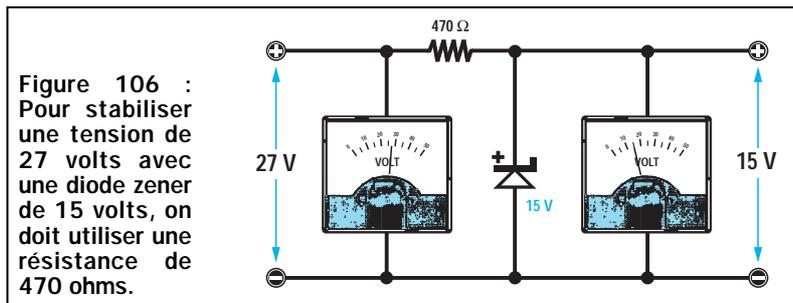
Figure 106 : Pour stabiliser une tension de 27 volts avec une diode zener de 15 volts, on doit utiliser une résistance de 470 ohms.
