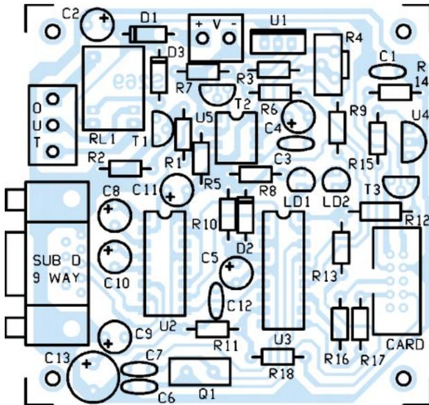
Figure 4 : Plan d'implantation des composants de l'interface.
