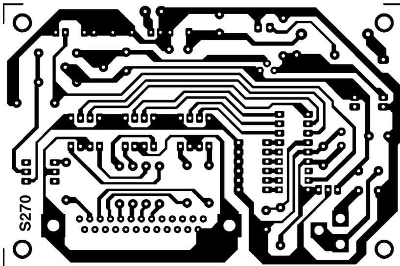
Figure 5 : Circuit imprimé à l'échelle 1/1.
