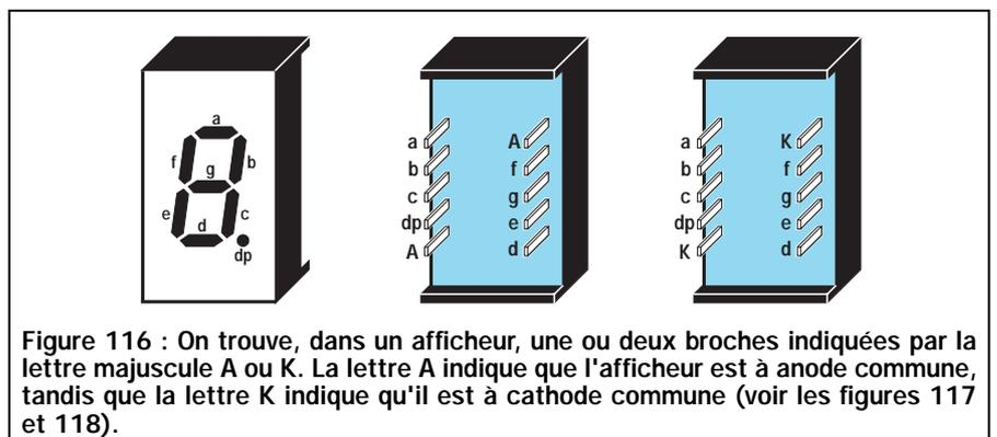
Figure 116 : On trouve, dans un afficheur, une ou deux broches indiquées par la lettre majuscule A ou K. La lettre A indique que l'afficheur est à anode commune, tandis que la lettre K indique qu'il est à cathode commune (voir les figures 117 et 118).
