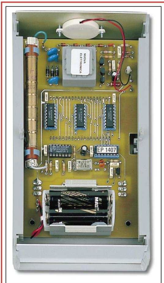
**Figure 9 :** Sur cette photo vous pouvez voir comment est installé, à l'intérieur du coffret, le circuit imprimé du compteur Geiger. Sur le panneau métallique du haut vous devez visser le buzzer après avoir percé un trou pour faire sortir le son du crépitement des impulsions radioactives en cours de détection.
