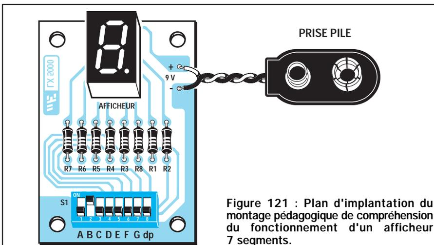
Figure 121 : Plan d'implantation du montage pédagogique de compréhension du fonctionnement d'un afficheur 7 segments.
