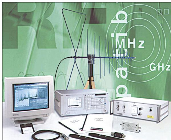
3 GHz et comporte un grand nombre de filtres de résolution. L'environnement PC et le lecteur de disquettes 3" 1/2 permettent l'archivage et l'exploitation des résultats de mesures (en format .TXT ou BMP). ◆
