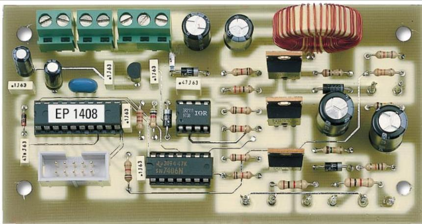
Figure 10 : Photo de la platine principale LX.1408 de notre prototype. Vous trouverez, sur le circuit imprimé que nous vous fournirons, la sérigraphie complète avec des pistes étamées protégées par un vernis antioxydant.
