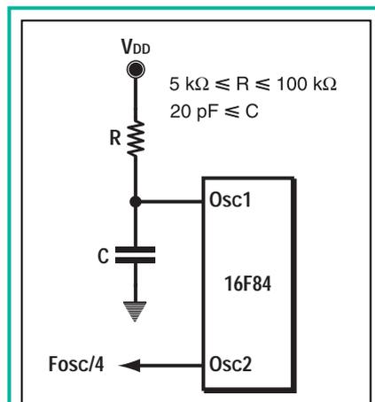
Figure 4 : Une horloge économique avec une simple cellule R - C.
