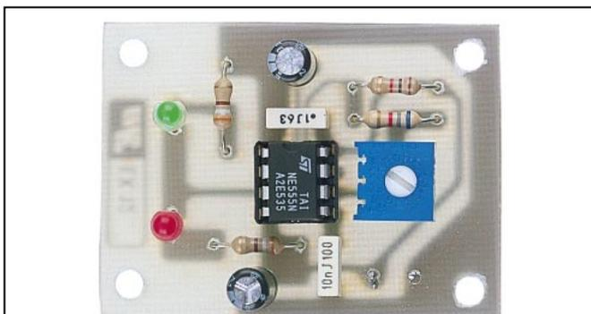
Figure 129 : L'indicateur à deux diodes LED une fois monté.
