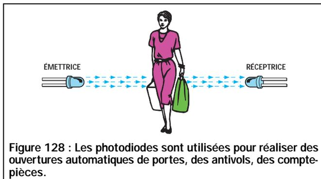
Figure 128 : Les photodiodes sont utilisées pour réaliser des ouvertures automatiques de portes, des anti-vols, des compte-pièces.
