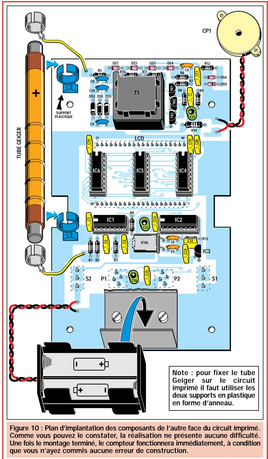
Figure 10 : Plan d'implantation des composants de l'autre face du circuit imprimé. Comme vous pouvez le constater, la réalisation ne présente aucune difficulté. Une fois le montage terminé, le compteur fonctionnera immédiatement, à condition que vous n'ayez commis aucune erreur de construction.
