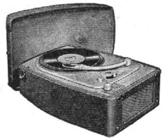
**AG9129.** Electrophone 4 transistors (2-OC71, 2-OC72), HP 10,5 cm type AD 2400Z. Puissance 0,24 W (distorsion 10 % à 400 c/s). Tonalité : 2 positions, combinées avec réglage puissance. Platine tourne-disque AG2075, 4 vitesses. Tête AG 3010 à 2 saphirs, interchangeable. Alimentation : 4 piles 1,5 V, débit 0,1 A à puissance sonore moyenne. Valise gainée gris, couvercle amovible. H 160 - L 377 - P 272 mm, 5,4 kg avec piles. Prix piles comprises.
