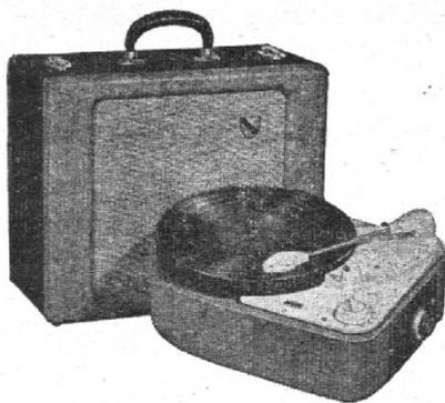
**S4 portable.** Electrophone 3 lampes (2-ECL80, 6X4). Push-pull 4 W modulés à < 1 % de distorsion. Gamme de fréquence 40 à 15 000 c/s. HP 17 cm. Tonalité réglable. Tourne-disque 4 vitesses, platine T64. Alternatif 110/130 ou 220 V par commutateur 2 positions, 50 c/s, 28 + 12 VA. Socle platine-ampli bois : H 145 - L 365 - P 260 mm, incorporable pour le transport dans la valise gainée vinyle lavable 2 tons, contenant le HP : H 210 - L 390 - P 330 mm, 10 kg. Avec cordon 5 m.
