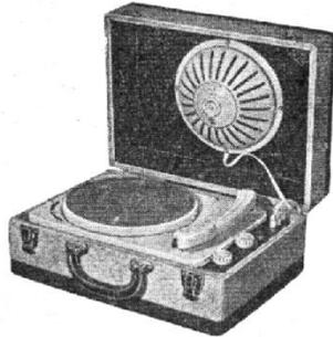
**Jacky.** Electrophone 3 lampes (6AU6, EL84, EZ80). Puissance 4 W. HP 19 cm. Prise micro. Tonalité réglable. Contre-réaction. Tourne-disque 4 vitesses. Alternatif 110-220 V, 50 c/s, 30 + 10 VA. Valise gainée 2 tons vert ou bordeaux, couvercle amovible contenant le HP. H 170 - L 360 - P 260 mm. Prix T.T.C. 29.718
