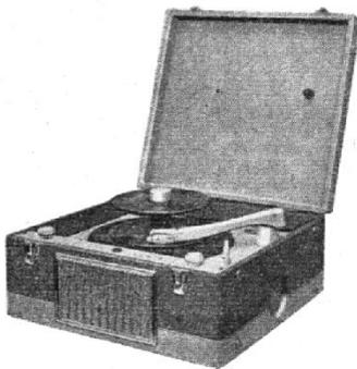
**356.** Electrophone 3 lampes (EF41, EL84, EZ80). Puissance 3 W. 2 HP : 12-18 cm, et tweeter 8 cm. Prise HPS basse impédance. Tonalité réglable. Contre-réaction fixe. Tourne-
