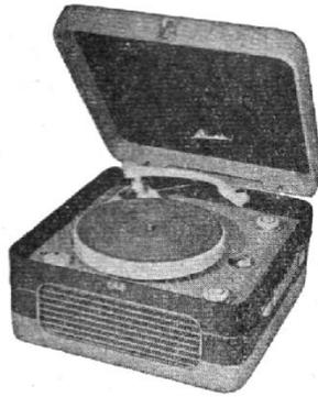
**Bush RP20.** Electrophone 3 lampes (ECC81, EL84, EZ80). Puissance 2,8 W. 3 HP: 2 de 15-10 cm et tweeter électrostatique. Tourne-disques Garrard 4 vitesses. Alternatif 120-250 V, 50 c/s, 45 VA. Valise gainée rouge et beige. H 205 - L 580 - P 380 mm, 8 kg.
