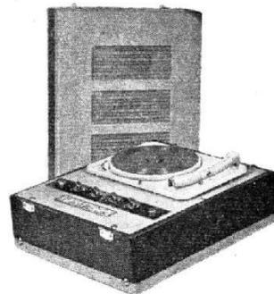
**Micro Select 58.** Electrophone 3 lampes (ECC81, EL84, EZ80). Puissance 5,5 W. 2 HP : 21 cm et tweeter 12 cm. Prises micro et HPS basse impédance. Mixage PU - micro. 2 réglages de tonalité : graves et aiguës. Tournedisques 4 vitesses. Alternatif 100/240 V, 50 c/s, 55 + 10 VA. Valise gainée 2 tons, avec casier pour 15 disques incorporé. Couvercle amovible contenant les HP. H 210 - L 450 - P 340 mm, 9,5 kg. Prix T.T.C. 53.800
