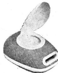
**Conque PM.** Réflecteur de forme ellipsoïde surmontant une enceinte anti-résonnante basée sur les propriétés du résonateur de Heimholtz. HP 120 mm, impédance 2,5 Ω. Puissance admissible 1,5 W. Utilisable comme HPS à la suite d'un récepteur radio, télévision ou amplificateur puissance en rapport.
