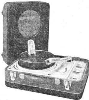
**Tapetop LP560.** 3 lampes (6AU6, ECL82, EZ80). Puissance 2-3 W. HP 19 cm. Double usage comme électrophone et lecteur magnétique Tapetop. Tonalité réglable. Inverseur Tapetop-PU. Prise HPS basse impédance par jack coupant le HP de l'appareil. Tourne-disques 3 vitesses avec bras de pick-up et lecteur Tape-top. Alternatif 120/220 V, 50 c/s, 8 + 4 VA. Valise gainée 2 tons, jonc or, grille HP dorée. Couvercle amovible contenant le HP avec cordon 1 m. H 190 - L 375 - P 290 mm.
