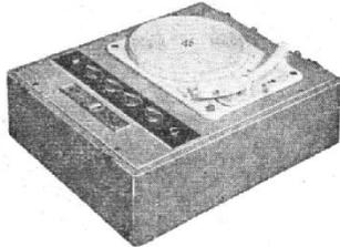
**Electrophone-Salon.** 3 lampes (12AX7, EL84, EZ80). Puissance 6 W. HP 21 cm. Prises HPS et micro. Réglages de puissance pour PU et micro. 2 réglages de tonalité : graves et aigus. Tourne-disque 4 vitesses. Alternatif 110/240 V, 50 c/s, 50 + 10 VA. Valise gainée, couvercle amovible. H 220 - L 450 - P 350 mm, 11,5 kg.
