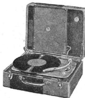
**NG2470.** Electrophone 2 lampes (UCL82, UY85). HP 17 cm aimant inversé. Puissance 1,3 W (distorsion 10 % à 400 c/s). Platine tourne-disque NG2072, 4 vitesses. Tête AG 3010 à 2 saphirs, interchangeable. Alternatif 120 V, 50 c/s, 16 + 7 VA. Valise gainée pégamoïd 2 tons rouge et beige, poignée bakélite, couvercle détachable contenant le HP. H 140 - L 345 - P 315 mm, 5,6 kg.
