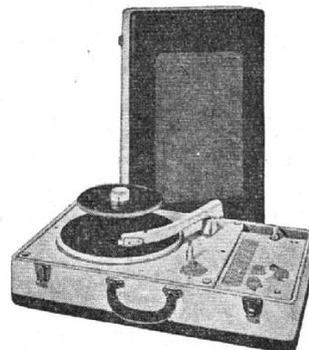
**Super 3478.** Electrophone 4 lampes (EBC81, ECC82, 2-EL84) + redresseur. Push-pull 7 W avec taux de distorsion < 0,5 %. 3 HP 24 cm et 2 de 10-14 cm. Voyant lumineux de mise sous tension. Prise HPS basse impédance et prise micro ou adaptateur MF. 2 réglages de tonalité : graves et aiguës. Tourne-disques 4 vitesses fonctionnant en changeur automatique pour les disques 45 tours. Alternatif 120-220 V, 50 c/s, 50+12 VA. Valise bois gainée parchemin et façon lézard,
