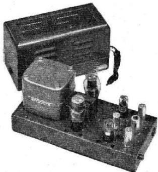
**FR203.** Amplificateur 6 lampes (12AT7, 2-6SN7, 2-6B4, 5Z3). Push-pull 15 W avec taux de distorsion 0,3 % à 8 W. Sensibilité 300 mV. Réponse 20 à 80 000 c/s à  $\pm 1$  db. Impédance sortie de 0,95 à 60  $\Omega$  (à préciser en passant commande). Contre-réaction non sélective. Alternatif 120/240 V, 50 c/s, 80 VA. Présentation en 2 coffrets tôle, émaillés gris. Ampli : H 210 - L 410 - P 185 mm. Alimentation : H 200 - L 330 - P 155 mm. Prix T.T.C. 130.590
