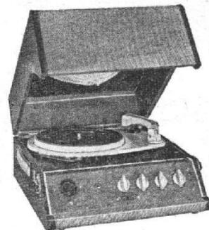
**Electrophone luxe GM.** 4 lampes (2-EF86, EL84, EZ80). Puissance 4 W. HP 21 cm blindé. Prise micro. Mixage micro - PU. Prise HPS impédance. 2 réglages de tonalité : graves et aiguës : Tourne-disque 4 vitesses. Alternatif 110-220 V, 50 c/s, 35 + 10 VA. Valise gainée. Rexine 2 tons divers coloris, couvercle détachable formant baffle HP, avec cordon 5 m. H 185 - L 330 - P 400 mm. Prix T.T.C. 38.561
