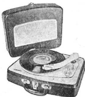
**2458.** Electrophone 2 lampes (EBC81, EL84) + redresseur. Puissance 4 W. 2 HP de 12-17 cm. Voyant lumineux de mise sous tension. Prise pour micro ou adaptateur MF. Tonalité réglable. Tourne-disques 4 vitesses. Alternatif 120-220 V, 50 c/s, 24+12 VA. Mallette gainée façon cuir vert ou havane,
