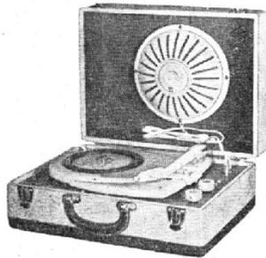
**Elite.** Electrophone 3 lampes (2-ECL82, EZ80). Push-pull 6 W. HP 21 cm. Prise micro ou adaptateur FM. Tonalité réglable par contre-réaction. Tourne-disques 4 vitesses. Alternatif 110-220 V, 50 c/s, 35 + 10 VA. Valise gainée 2 tons vert ou bordeaux, couvercle amovible contenant le HP. H 180 - L 400 - P 300 mm. Prix T.T.C. 34.800
