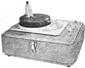
**Tapetop LP562.** Comporte le tourne-disque 3 vitesses sans bras de pick-up, le bloc sélecteur de lecture de bande magnétique double piste en chargeur Tapetop et le préamplificateur 3 lampes (2-EF86, EZ80). Sortie 500 mV pour raccordement prise PU d'un amplificateur ou récepteur radio. Interrupteur secteur et voyant lumineux. Réglage de puissance. Alternatif 120-220 V, 50 c/s, 5 + 4 VA. Coffret métal givré gris, avec couvercle amovible, pieds caoutchouc. H 223 - L 410 - P 375 mm.
