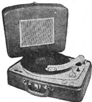
**1458.** Electrophone 3 lampes (UY92, UL84, UBC81). Puissance 1,8 W. HP 17 cm. Tonalité réglable. Contre-réaction sélective. Tourne-disques 4 vitesses. Alternatif 120-220 V, 50 c/s, 19+12 VA. Mallette gainée façon cuir gold patiné, couvercle détachable contenant le HP, avec cordon 1,80 m. H 150 - L 380 - P 300 mm, 5 kg.
