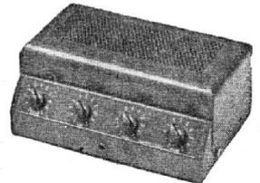
**FR107F.** Amplificateur 6 lampes (EF40, 2-ECC40, 2-EL41, GZ41). Push-pull 6 W avec taux de distorsion 1% à 4 W. Sensibilité 10 mV. Réponse 60 à 12 000 c/s à  $\pm 1$  db. Impédance de sortie 3-15  $\Omega$ . 2 réglages de tonalité: graves de + 7 à + 15 db, aiguës de - 6 à + 13 db. Contre-réaction non sélective. Alternatif 120/240 V, 50 c/s, 50 VA. Coffret tôle, martelé gris. H 150 - L 350 - P 230 mm.
