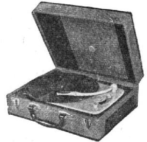
**RA7024.** Electrophone 2 lampes (UCL82, UY85). HP 17 cm aimant, inversé. Puissance 1,3 W (distorsion 10 % à 400 c/s). Platine tourne-disque 4 vitesses. Alternatif, 120 V, 50 c/s, 16 + 7 VA. Valise gainée « Rexine », couvercle détachable contenant le HP. H 130 - L 345 - P 285 mm.
