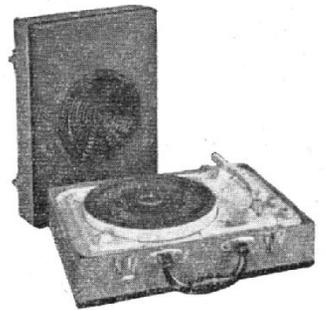
**Valise électrophone.** 2 lampes (ECL82, EZ80). Puissance 3 W. HP 17 cm. Tonalité réglable. Tourne-disques 4 vitesses, platine Teppaz. Alternatif 110-125-245 V, 50 c/s, 25+10 VA. Mallette gainée plastique gold, vert ou rouge, grille plastique dorée, poignée plastique, couvercle amovible formant baffle. HP avec cordon 2 m. H 150 - L - 375 - P 280 mm, 6 kg.
