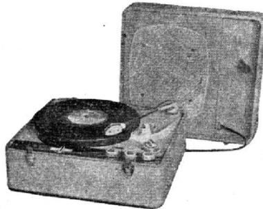
**E624.** Electrophone 3 lampes (ECC83, 6BM5, 6BX4). Puissance 2,5 W. HP 19 cm. 2 réglages de tonalité: graves et aiguës. Contre-réaction sélective à 3 circuits. Voyant lumineux de mise sous tension. Tourne-disques 4 vitesses, platine T 64. Alternatif 115/245 V, 50 c/s 40+12 VA. Valise gainée façon porc ou bicolore, ferrures laiton poli, poignée de transport, couvercle amovible formant baffle HP, avec cordon. H 200 - L 360 - P 320 mm. 9,2 kg.
