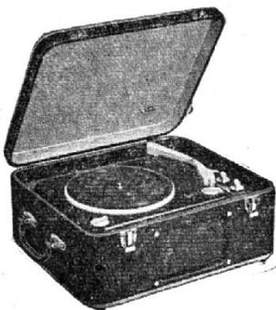
**J3. Electrophone 2 lampes (ECL80, EZ80).** Puissance 2 W. HP 16-19 cm. Prise HPS basse impédance. Tonalité réglable. Tourne-disques Lenco J55, 4 vitesses : 16, 33, 45 et 78 tours. Alternatif 110-220 V, 50 c/s, 33 + 7 VA. Valise gainée simili cuir 2 tons, lavable, gris clair et bordeaux. H 170 - L 410 - P 350 mm, 6,5 kg. Prix T.T.C., port en sus 31.800
