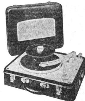
**2478.** Electrophone 2 lampes (EBC81, EL84) + redresseur. Puissance 4 W. 2 HP: 12 et 17 cm. Voyant lumineux de mise sous tension. Tonalité réglable. Tourne-disques 4 vitesses fonctionnant en changeur automatique pour les disques 45 tours. Alternatif 120-220 V, 50 c/s, 25+12 VA. Mallette gainée façon cuir vert ou havane, couvercle détachable contenant les HP, avec cordon 1,80 m. H 160 - L 410 - P 340 mm, 10 kg.
