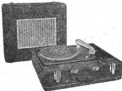
**DS-580.** Electrophone 3 lampes (ECC82, EL84, EZ80). Puissance 3 W (4 W en pointe). 3 HP : 21 cm et 2 tweeters. Voyant lumineux de mise sous tension. Prises pour magnétophone, micro haute impédance et HPS basse impédance. 2 tonalités réglables : graves et aiguës. Tourne-disques 4 vitesses. Alternatif 110/220 V, 50 c/s, 25 + 10 VA. Valise gainée vert, couvercle amovible. H 225 - L 410 - P 360 mm. Prix approximatif 40.000
