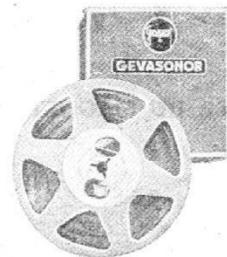
**Gevasonor M.** Bande magnétique à support chlorure de vinyle recouvert oxyde de fer. Largeur 6,35 mm, épaisseur 52 microns. Courbes de réponse : 8 000 c/s à 9,5 cm/s, 12 000 c/s à 19 cm/s, et 15 000 c/s à 38 cm/s. Distorsion harmonique 1 %. Dynamique d'effacement — 70 dB. Rapport signal-bruit de fond — 65 dB pour distorsion harmonique 2 % à 1 000 c/s. Allongement élastique  $< 1,5$  % après une minute pour une charge de 1 kg. Charge de rupture  $> 2$  kg.
