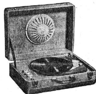
**Electrophone.** 3 lampes (EBF80, EL84, EZ80). Puissance 3,5 W. Voyant lumineux de mise sous tension. Prise pour micro. 2 réglages de tonalité : graves et aigus. Tourne-disques 3 vitesses, avec chercheur de sillon. Dispositif de court-circuit du PU avec arrêt automatique. Alternatif 110/245 V, 50 c/s, 40 + 12 VA. Valise gainée 2 tons : vert et gris. Couvercle amovible contenant le HP avec cordon 1,5 m. H 165 - L 430 - P 315 mm, 7 kg.
