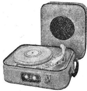
Electrophone Eden 20. 3 lampes (6AV6, EL84, EZ80). Puissance 4 W. HP 17 cm. Tonalité réglable. Contre-réaction corrigée. Câblage par circuits imprimés. Tourne-disques 4 vitesses platine 4 T. Alternatif 115-220 V, 50 c/s, 40 + 12 VA. Mallette simili peau de porc ou gris, poignée rigide, couvercle détachable contenant le HP, avec cordon 2 m. H 155 - L 330 - P 270 mm.
