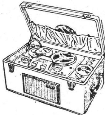
**Radiomagnétophone Mikmatic.** Magnétophone avec récepteur radio incorporé. Caractéristiques: Magnétophone 2 vitesses de défilement 9,5 cm/s et 4,75 cm/s. 3 réglages de tonalité et puissance. Contrôle de l'enregistrement par l'œil cathodique. Grande vitesse AV et AR par commande à touches. Entrées Micro et PU. Mixage. Radio-récepteur alternatif 4 gammes. Cadre incorporé. Grande sensibilité. Haute musicalité. Dimensions: 42 x 28 x 19 cm. Prix T.T.C. 79.950
