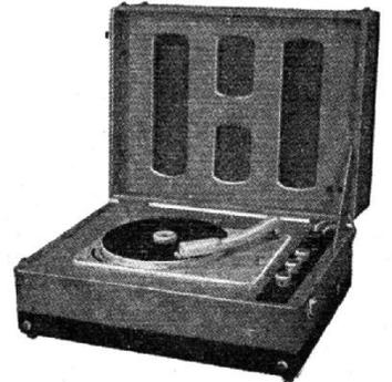
**Super Magnétique MD Electrophone 5 l.** (12AX7-2-EF86, EL84, EZ80). Puissance 4 W. HP 21 cm. Réponse droite de 20 à 20 000 c/s ± 1 db, distorsion 0,5 % à 3 W, taux de C.R. 20 db. Prise HPS, micro ou magnétophone par jack inverseur. 2 réglages de tonalité: graves et aiguës ± 20 db. Tourne-disque 4 vitesses, tête à réluctance variable Goldring 500. Alternatif 110/130 et 220/260 V, 50 c/s, 40 VA. Mallette gainée sanglar, couvercle amovible. H 245 - L 450 - P 345 mm, 12 kg.
