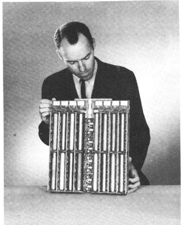
Photo 7. — Des fils magnétiques, plus fins qu'un cheveu humain, sont employés dans la nouvelle mémoire de Hughes. D'après les premiers tests, il apparaît que cette mémoire est imperméable aux conditions environnementales les plus sévères.
