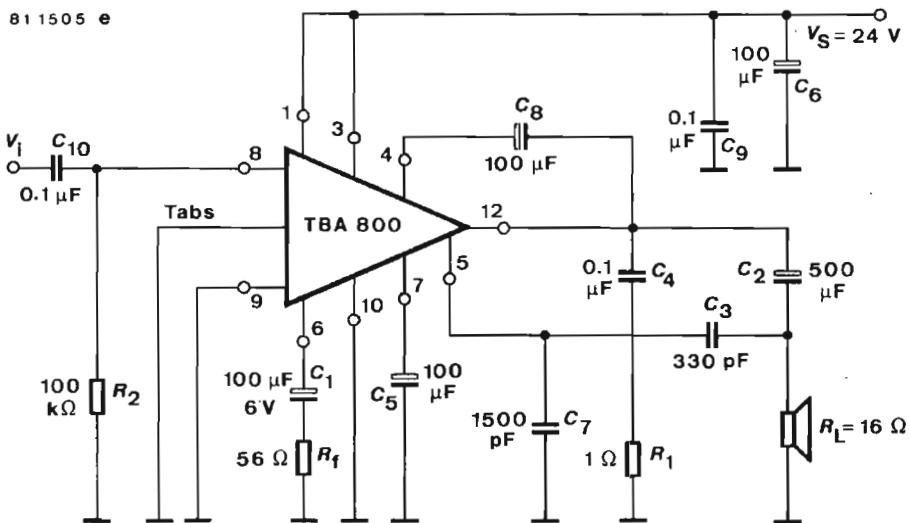
Fig. 4 Test circuit for:  $P_o$ ,  $P_{tot}$ ,  $d$ ,  $\eta$
