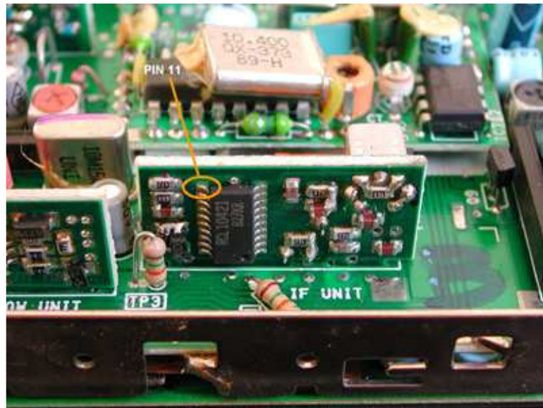
Pin 11 contient de l'audio non filtré
