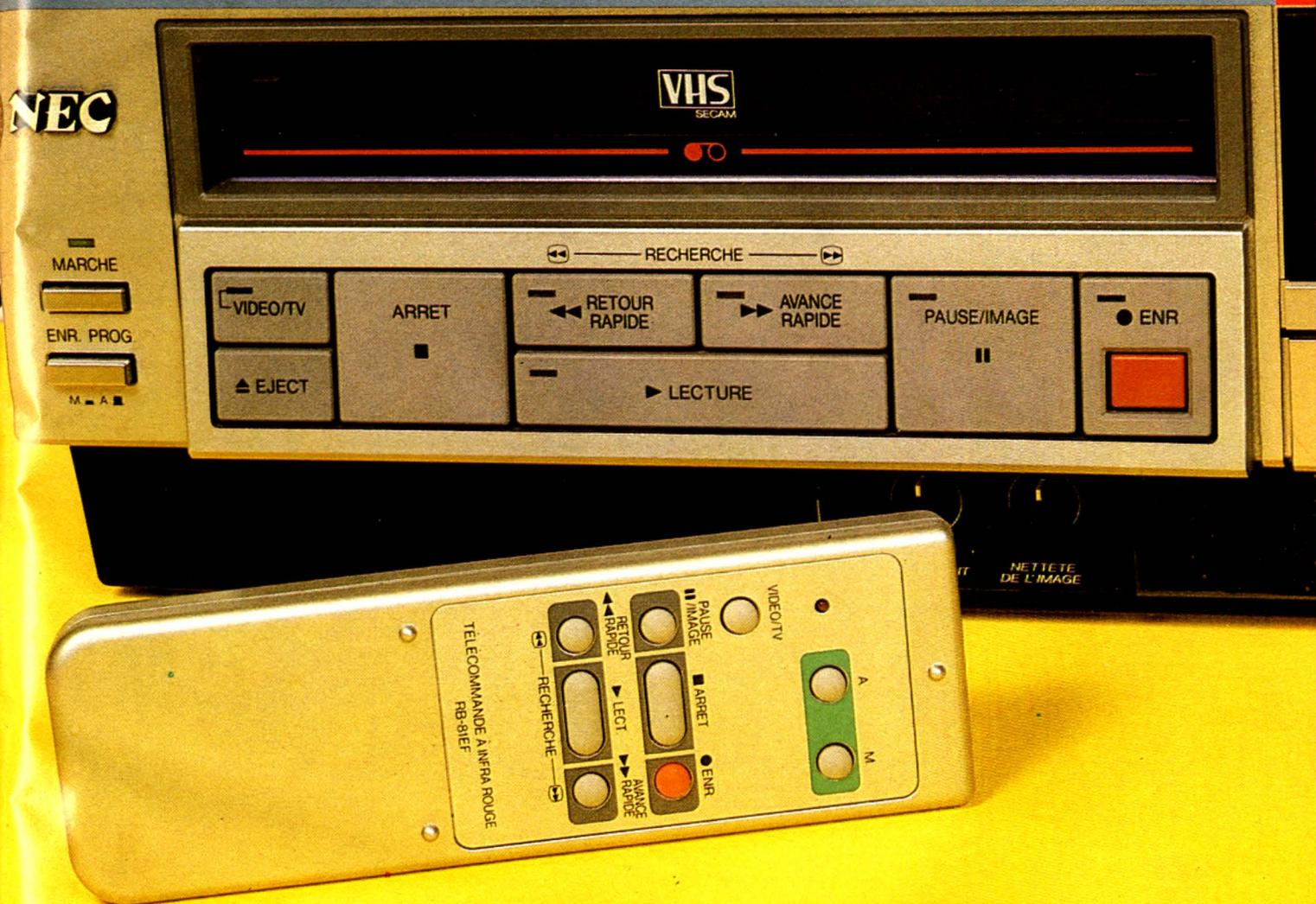
Photo 1. - Les commandes du magnéscope et de sa télécommande.
