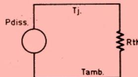
Fig. 7. — Représentation classique de l'écoulement de la chaleur.
