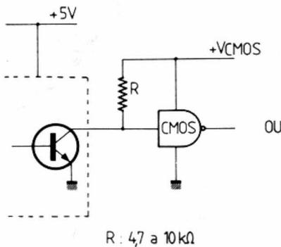
Fig. 3. - Interface TTL - C-MOS, alimentations séparées.
