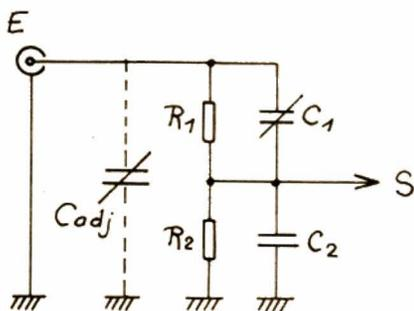
Fig. 3. - Cellule d'atténuation.
