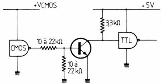
Fig. 4. - Interface C-MOS - TTL, alimentations séparées.
