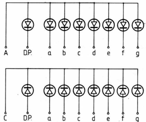
Fig. 10. - Câblage des LED des segments dans un afficheur à anodes communes et à cathodes communes.
