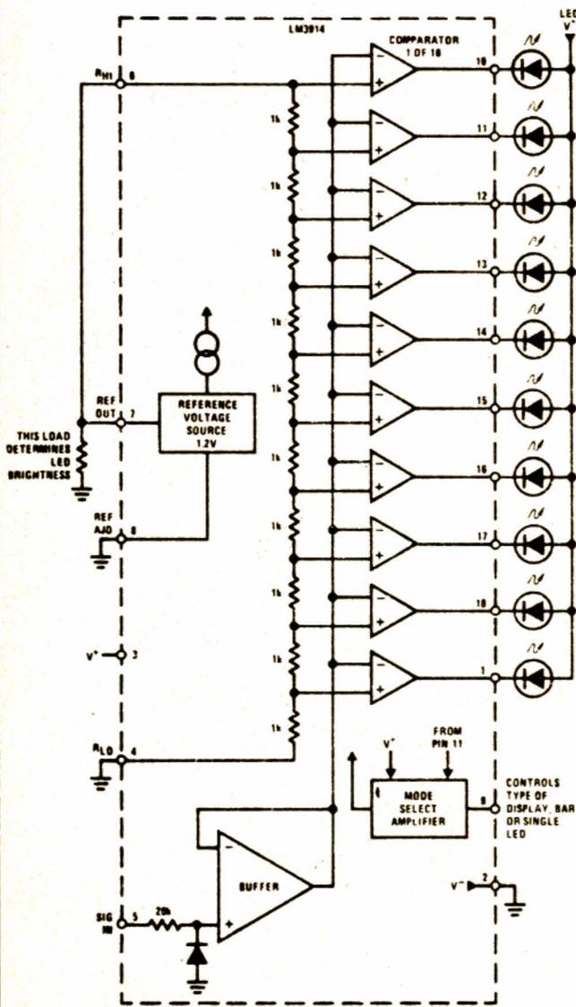
Fig. 1. - Schéma de structure du LM 3914.
