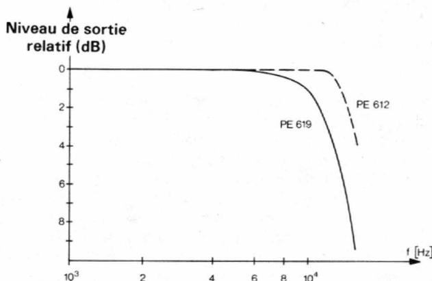
Fig. 4. — Comparaison de la réponse en fréquence dans le haut du spectre entre la PE 619 et la PE 612 (niveau ajusté pour  $-1 \text{ dB}$  à  $10 \text{ kHz}$  pour la PE 619).
