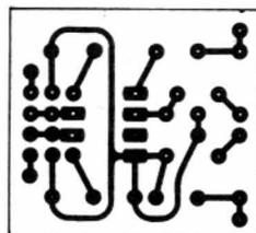
Fig. 2. - Dessin du circuit imprimé à l'échelle 1.
