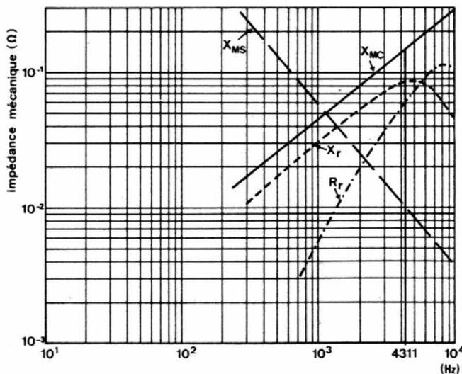
Fig. 6. — Comme figure 5, mais pour un haut-parleur d'aigu (diamètre :  $25,4 \cdot 10^{-3} \text{ m}$ ; masse du cône :  $15 \cdot 10^{-6} \text{ kg}$ ; masse de la bobine mobile :  $15 \cdot 10^{-6} \text{ kg}$ ). La fréquence est indiquée pour  $kr = 1$ .
