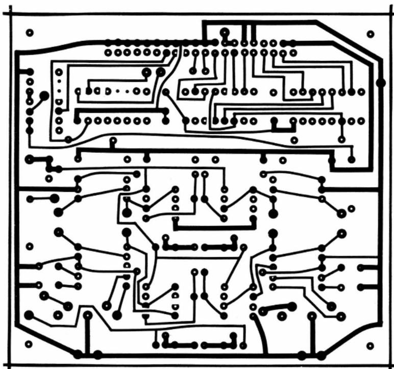
Fig. 3. - Circuit imprimé vu côté cuivre, échelle 1.
