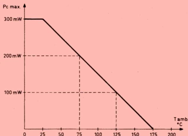
Fig. 3. — Variation de la puissance collecteur limitée en fonction de la température ambiante.
