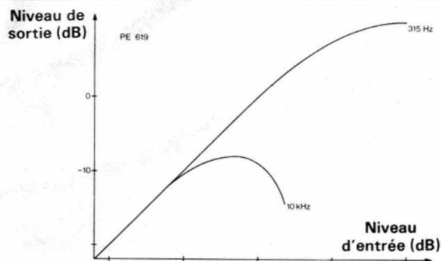
Fig. 1. — MOL d'une bande PE 619 à 4,76 cm/s ; égalisation  $120 \mu s$ , polarisation IEC, type I.
