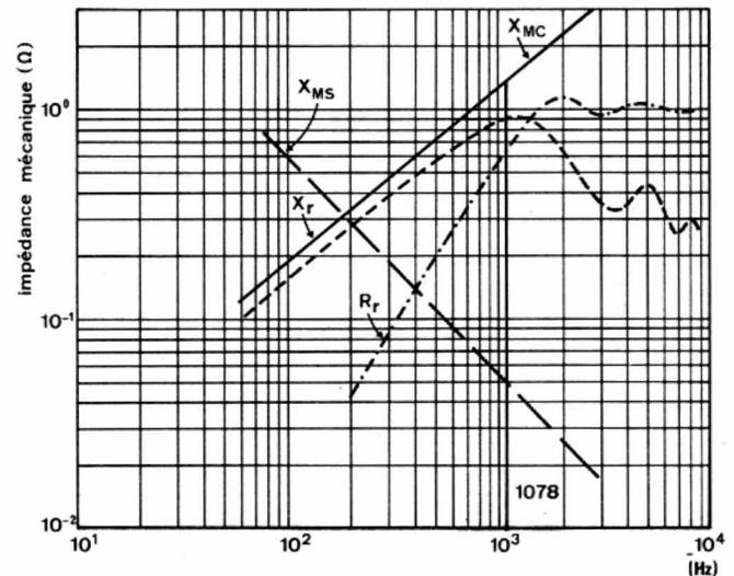
Fig. 5. - Comme figure 4, mais pour un haut-parleur de médium (diamètre :  $101,6 \cdot 10^{-3} \text{ m}$  ; masse du cône :  $10^{-3} \text{ kg}$  ; masse de la bobine mobile :  $0,35 \cdot 10^{-3} \text{ kg}$ ). La fréquence est indiquée pour  $kr = 1$ .
