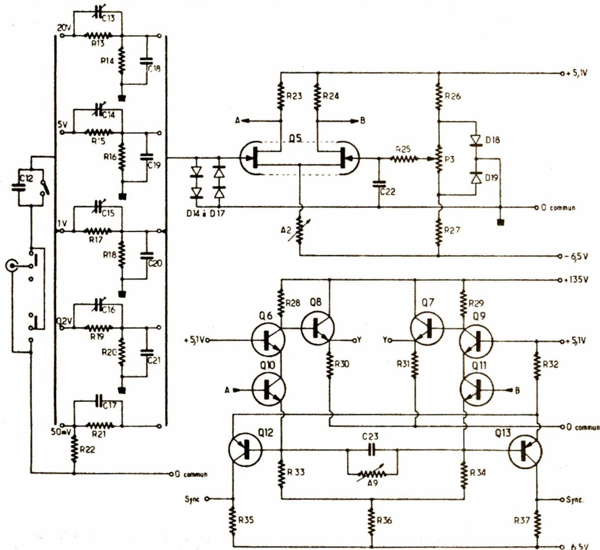
Fig. 2. — Un schéma d'amplificateur vertical d'oscilloscope.
