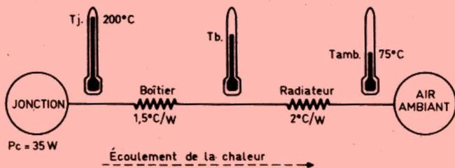
Fig. 10. - Schéma du refroidissement de l'ensemble transistor-radiateur.
