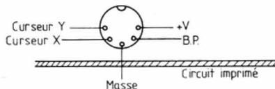
Fig. 5. — Schéma d'un manche.
