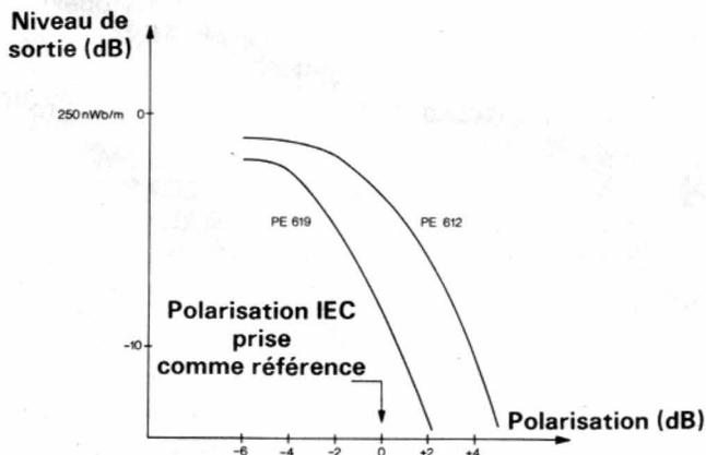
Fig. 3. — Niveau de sortie à la limite de la saturation à  $10 \text{ kHz}$ .
