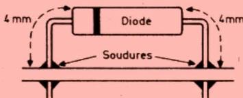
Fig. 5. — La résistance thermique de la diode est donnée pour une certaine longueur des connexions.
