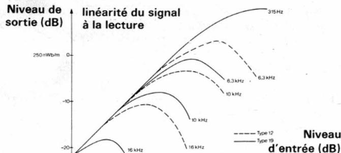
Fig. 2. — MOL (maximum output Level) comparé des bandes PE 612 et PE 619.
