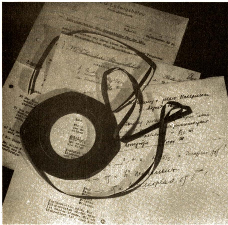
Photo 2. — Une bande provenant de la première fabrication d'essai de BASF en 1932 : que de chemin a-t-il encore fallu parcourir pour en arriver à la souplesse aujourd'hui bien connue des bandes magnétiques ! (Photo BASF.)
