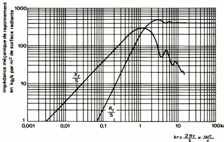
Fig. 3. — Résistance  $R_r$  et réactance mécaniques  $X_r$  (en ohms mécaniques) par unité de surface  $S$  (en m<sup>2</sup>) d'un piston rayonnant sur une charge infinie, en fonction de  $kr$ .
