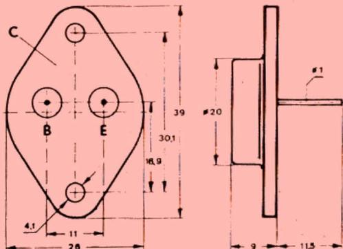
Fig. 11. - Boîtier TO3 et ses dimensions.
