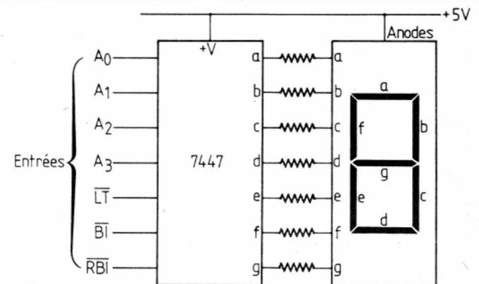
Fig. 12. - Table de vérité du 7447 et schéma d'utilisation.
