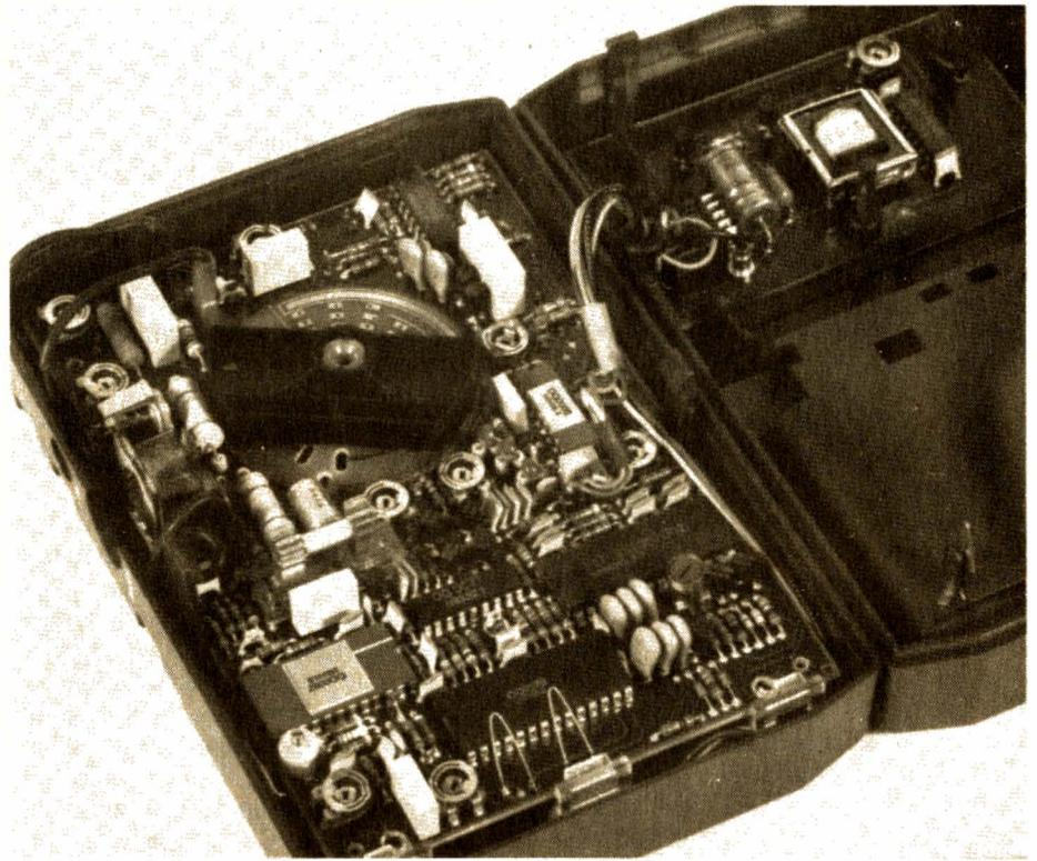
Photo A. — L'électronique avec, à droite, le circuit d'allumage de l'afficheur. Cinq des circuits intégrés ont été fabriqués « sur mesures »...
