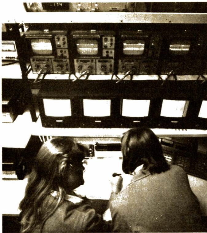
**Photo 8. – Contrôle des défauts de bandes vidéo, visualisés sur un écran. (Photo BASF.)**
