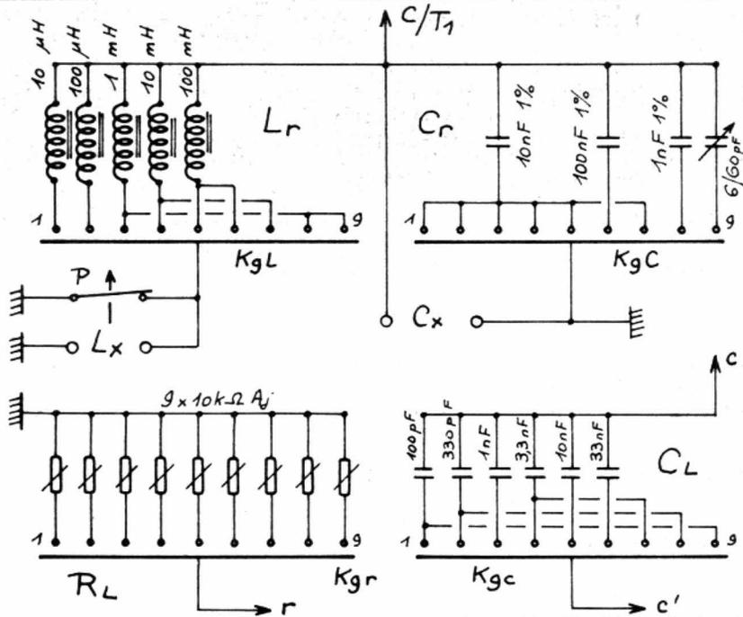
Fig. 3. - Schéma des commutations de gammes de 1 à 9 : 10 μH ; 100 μH ; 1 mH ; 10 mH ; 100 mH ; 0,1 μF ; 10 nF ; 1 nF ; 100 pF.
