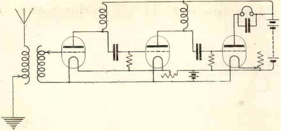
Fig. 17. Impedance Amplifier.
