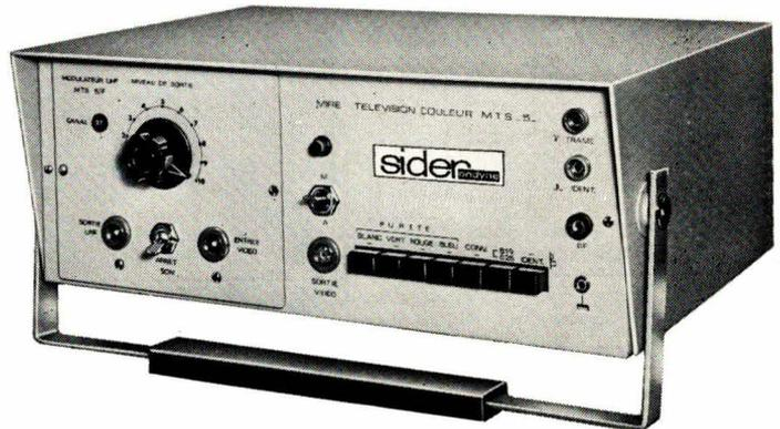
Caractérisée par sa concordance aux normes de l'émission, la mire M T S 5 constitue un outil de travail techniquement et fonctionnellement sûr, tant en atelier de fabrication que dans les stations-service et les services d'installation.
