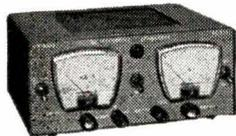
Intégralement transistorisée Dimensions réduites : 230 x 110 x 143 millimètres. Permet un réglage de la tension de sortie à variation continue de 0 à 25 volts sous 1 A. Dispositif limiteur de courant évitant la détérioration des transistors en cas de fausse manœuvre.
