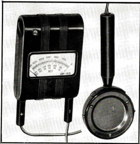
A gauche : Luxmètre portatif TRX (RADIO - CONTRÔLE).
