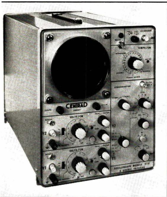
A gauche : Oscilloscope double canon, 20 MHz, transistorisé, type 678 (CENTRAD).
