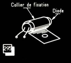
Fig. 295. — La fixation à l'aide d'un collier permet d'abaisser la résistance thermique d'une diode.
