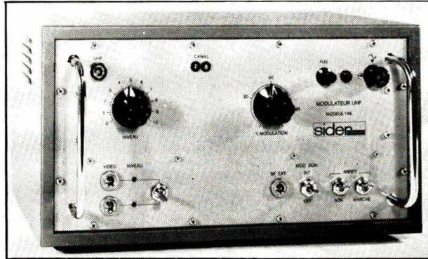
Ci-contre : Modulateur U.H.F. stabilisé par quartz, type 145 (SIDER).
