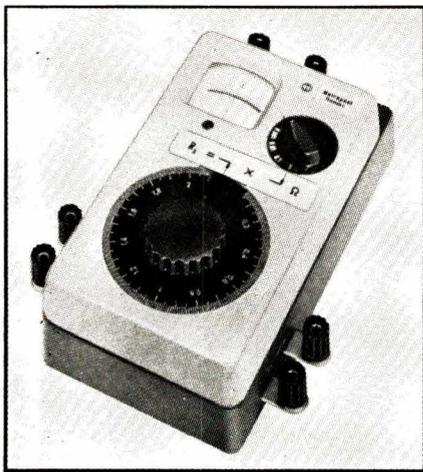
A gauche : Pont de mesure « Metrapont Thomson » (METRAWATT).
