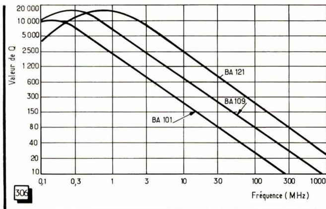
Fig. 306. — Variation du coefficient de surtension en fonction de la fréquence, pour les diodes BA 101, BA 109 et BA 121.
