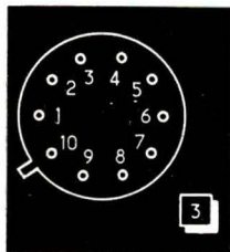
Fig. 3. — Disposition des connexions du CA 3011. La sortie 8 se trouve reliée au boîtier.
