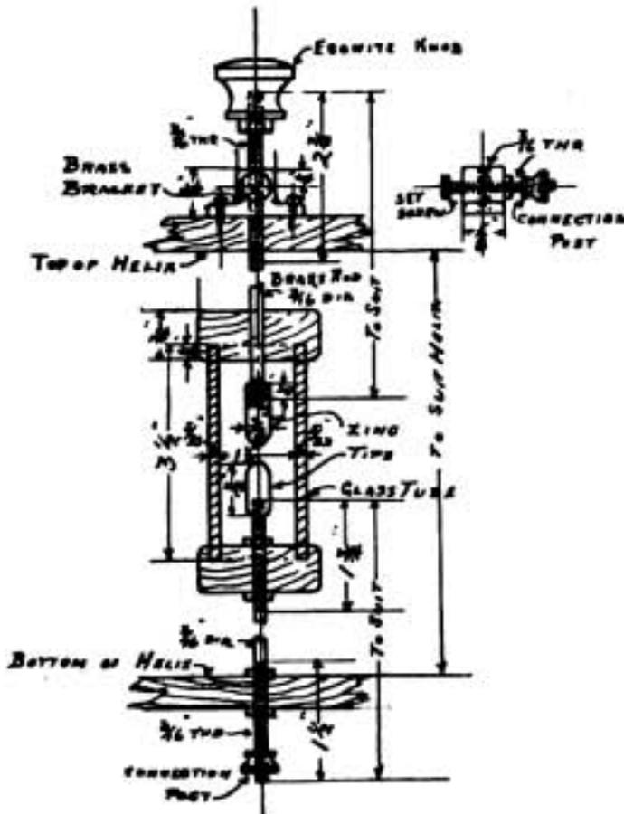
Fig. 3.—Spark Gap Muffler.
