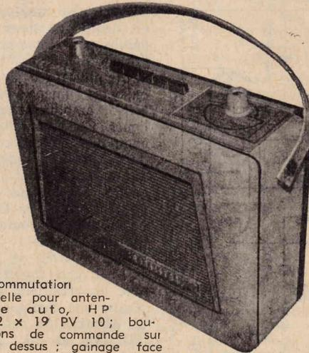
Commutation réelle pour antenne auto. HP 12 x 19 PV 10; boutons de commande sur le dessus; gainage face jaune, fond noir; décors plastiques gris ou noir.
