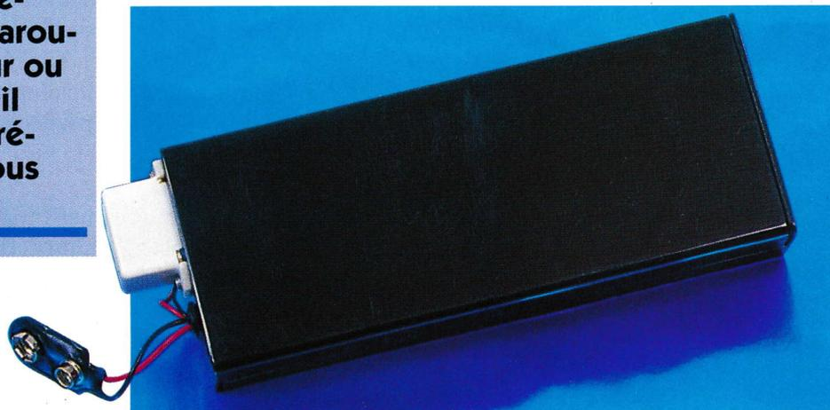
Lorsqu'un tel problème surgit, de deux choses l'une: ou bien la télécommande n'émet pas de signal I.R. ou alors le récepteur I.R. de l'appareil incriminé est défaillant. Le testeur proposé permet de vérifier si la télécommande émet un signal I.R. Précisons néanmoins un point important: le testeur, très simple, ne permet pas de contrôler la validité du codage du signal émis.
