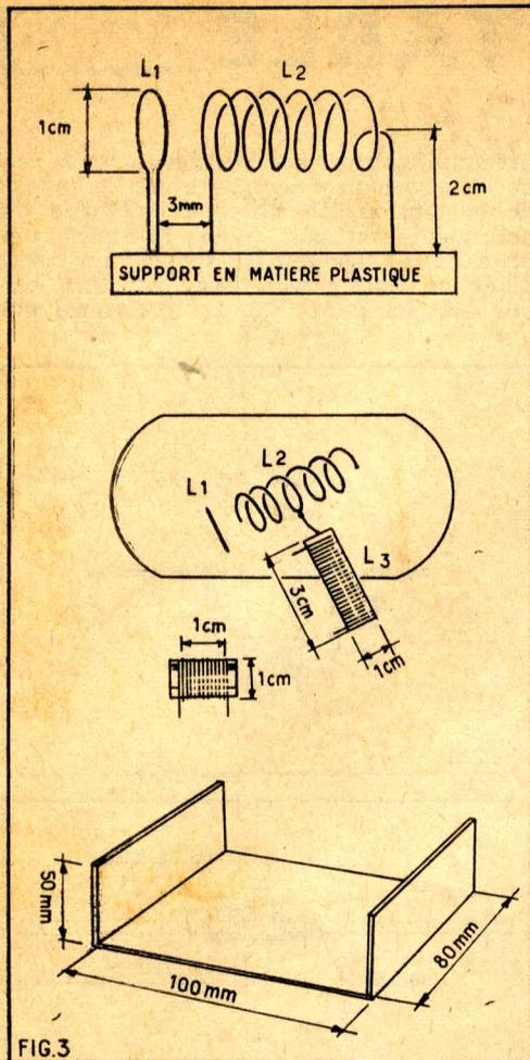
FIG. 3. — Conseil pour le bobinage :
