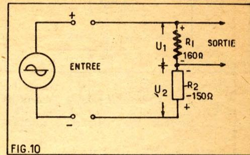
FIG. 10. — La mise en série d'une résistance positive et d'une résistance négative permet d'obtenir une amplification de tension. On notera que l'impédance d'entrée est rendue plus faible par la présence de la résistance négative diminue l'impédance d'entrée.
