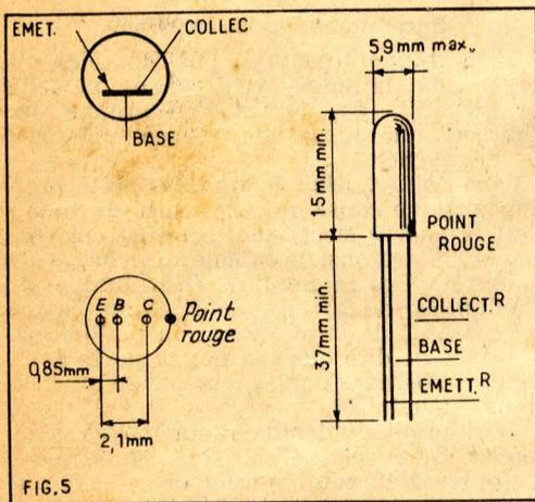
Ces transistors triodes du type PNP se montent à l'aide de soudures effectuées aux extrémités des fils.
