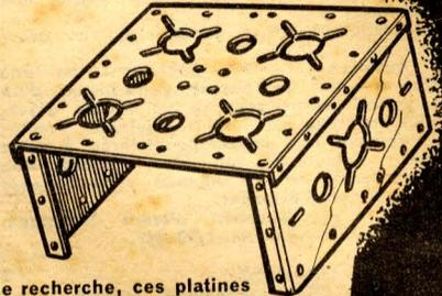
Véritable jeu de construction, qui développe l'esprit de création et de recherche, ces platines aux possibilités infinies permettent, sans aucuns frais, la transformation immédiate de tout montage sans travail de dessoudure.
