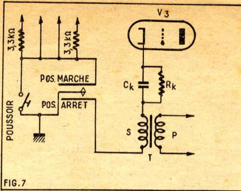
est intercalé du côté masse du circuit cathodique de l'amplificatrice V<sub>3</sub> au lieu d'être monté du côté cathode.
