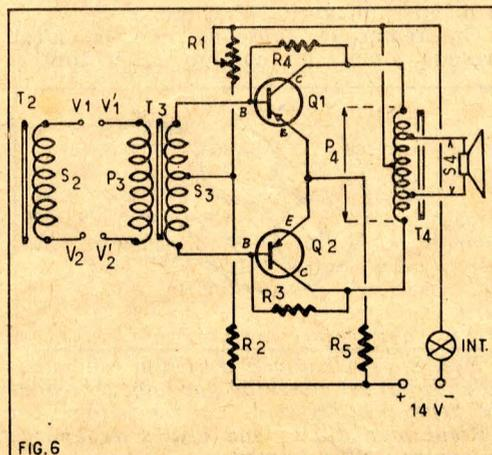
au circuit d'entrée du push-pull des deux transistors  $Q_1$  et  $Q_2$  tous deux du type OC16.
