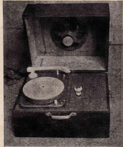
Platine tourne-disque, pick-up et HP.
