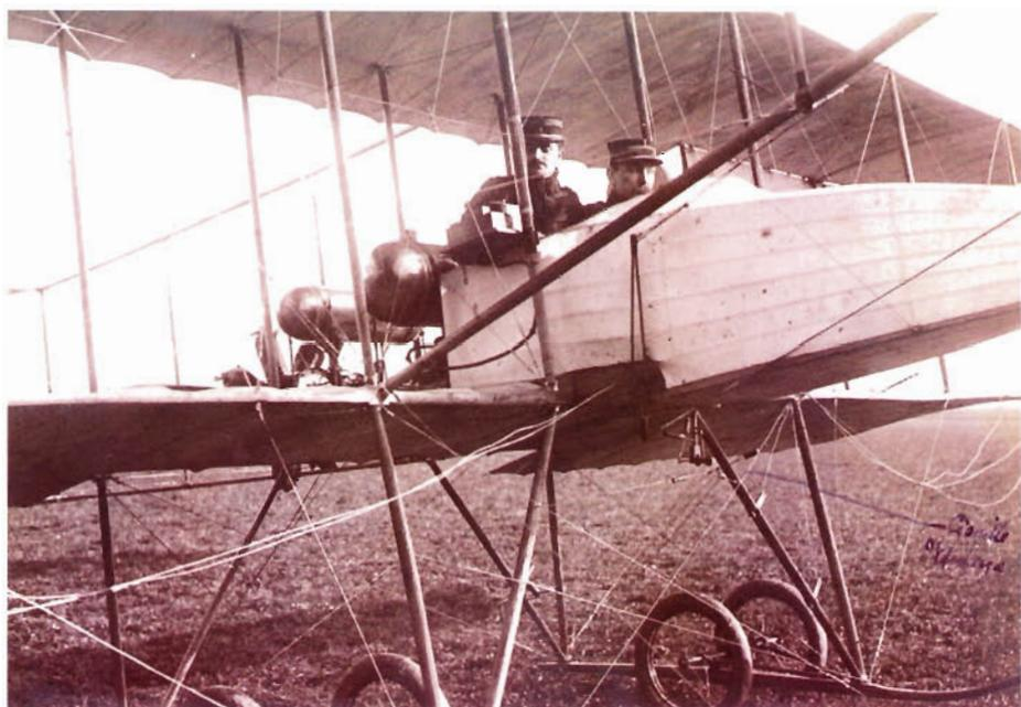
Villacoublay 1911, l'adjutant Ménard et Paul Brenot sur le Farman prêt à décoller, on distingue l'émetteur et sous la cellule la cisaille de coupure d'antenne, Collection 8<sup>e</sup> RT.
