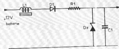
Figure 5 : Filtrage du 12 V (batterie) 12V filtré vers compteur
