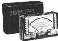
Protection électronique du galvanomètre. Fusible renouvelable sur calibre ohmmètre X1 et X10. Miroir antiparallaxe. Classes 1,5 CC et 2,5 CA.
