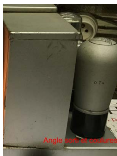
Figure 4 : Le bloc de condensateurs.
