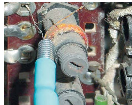
Figure 21. Présentation de la baguette auprès du bobinage à régler, côté fer.
