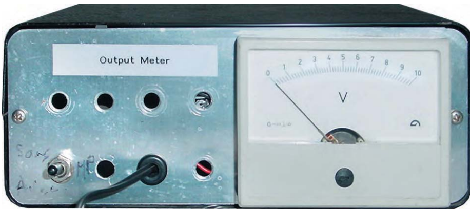
Figure 15. — Aspect de la réalisation de l' outputmètre .
