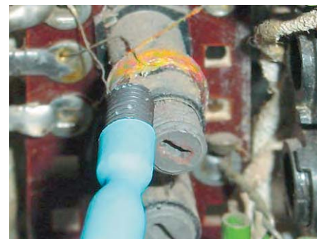
Figure 22. Présentation de la baguette auprès du bobinage à régler, côté ferrite.
