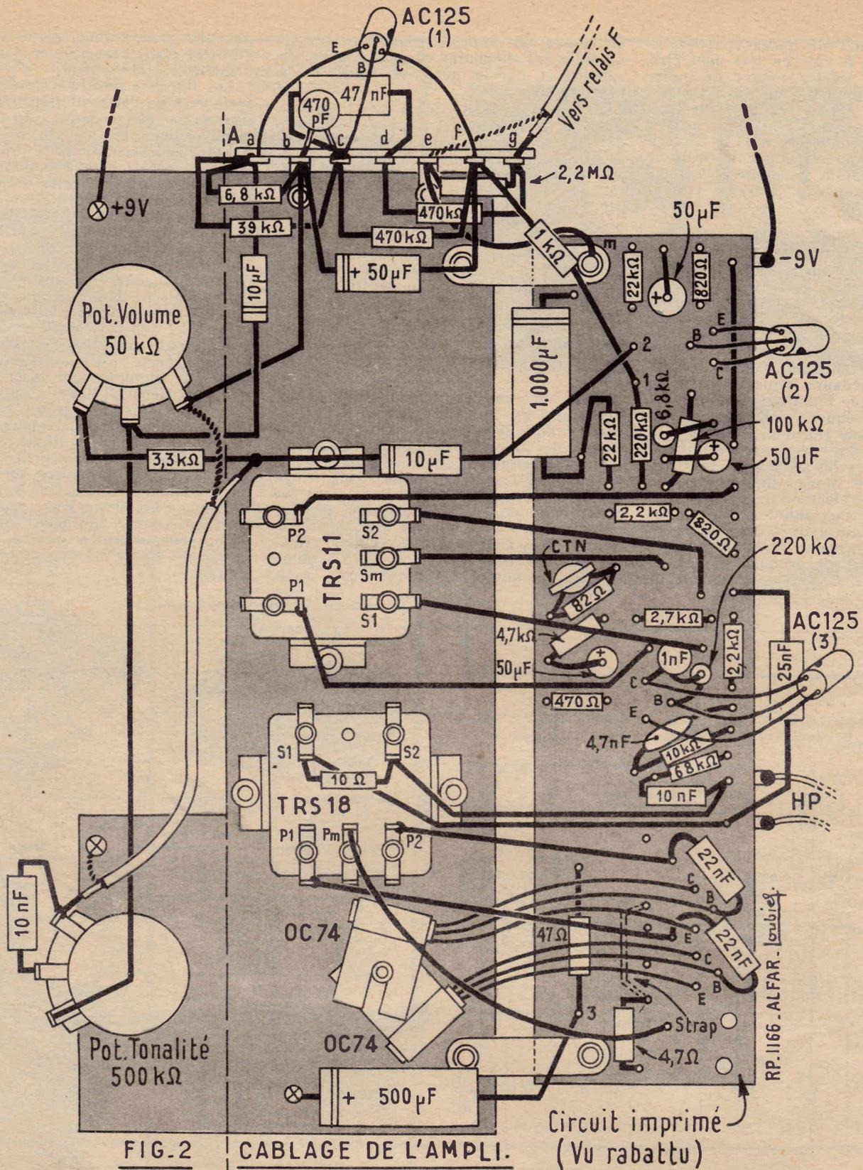
FIG. 2 CABLAGE DE L'AMPLI.
