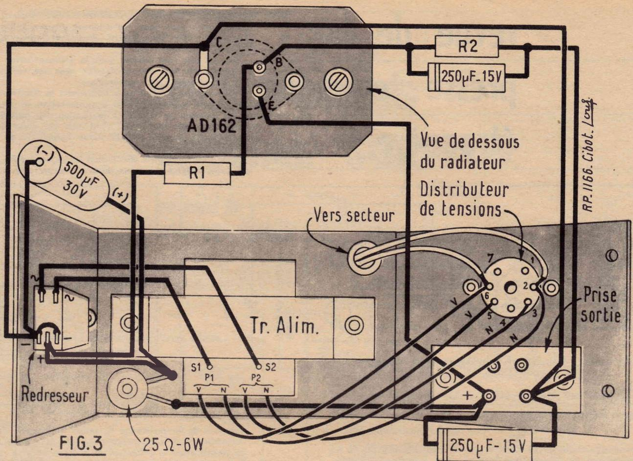
émetteur du transistor et par voie de conséquence la chute dans la 25 ohms. Avec  $R_1 = 300$  ohms et  $R_2 = 180$  ohms la tension de sortie est de 6 V avec  $R_1 = 220$  ohms et  $R_2 = 250$  ohms elle est de 9 V et avec  $R_1 = 150$  ohms et  $R_2 = 330$  ohms elle est de 12 V.
