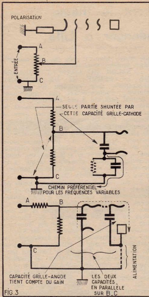
potentiomètres et de ces capacités (fig. 3) qui, dans certaines triodes, ne restent même pas fixes puisqu'elles varient d'après l'effet Miller, avec le gain de l'étage.
