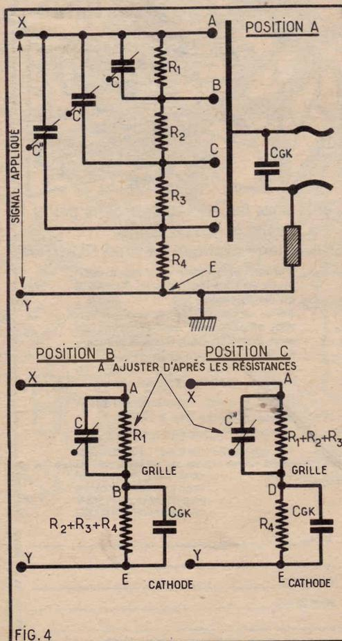
Le problème correspond, dans son essence, aux circuits d'entrée des oscilloscopes (bien conditionnés) et le fait de ne pas trouver toujours des signaux complexes, mais parfois des fréquences isolées, ne change rien à la préférence marquée (fig. 4) pour des atténuateurs à plots, plutôt que pour des potentiomètres à variation continue.
