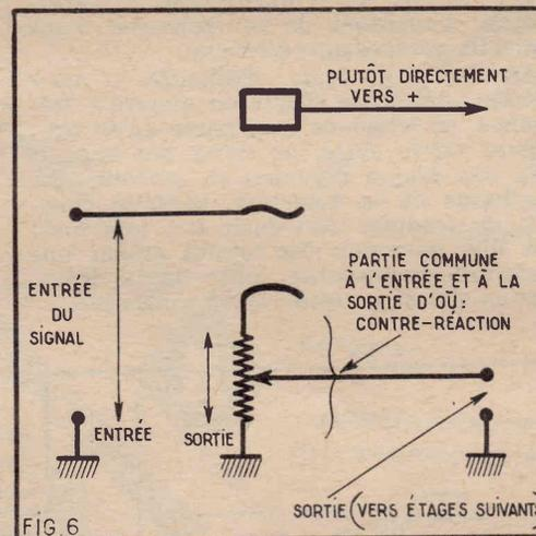
pour des fréquences déterminées, donc uniquement pour des positions précises du potentiomètre.
