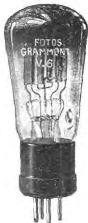
**Valves de redressement.** — Les valves monoplaques sont munies du culot n° 1, les biplaques (indiquées dans le tableau ci-dessous par 2×Vp) du culot n° 3. (Voir page 40.)
