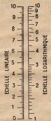
FIG. 6. — Comparaison entre une échelle ordinaire ou linéaire et une échelle logarithmique. On notera que cette dernière ne comporte pas de zéro.
