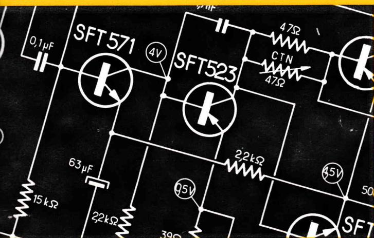
1° petit ampli 1 watt à transistors pour électrifier une guitare
