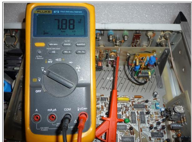
J'ai construit un module diviseur par 2 à base de bascule D, car la sortie du **Pilote** fonctionne en 5MHz. J'ai utilisé une plaque PCB percée pour câbler le montage.
