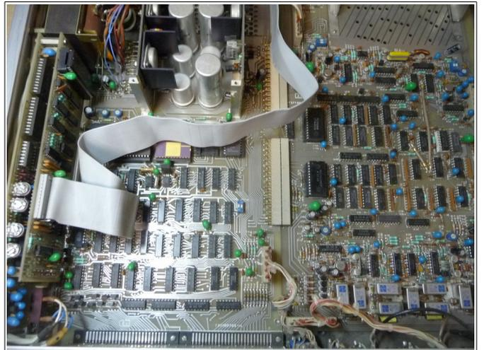
L'appareil contient beaucoup de condensateurs tantale goutte. Le vieillissement de ces pièces se caractérise généralement par un court-circuit franc qui peut être fatal sur les lignes d'alimentation. Le choix s'est donc porté de remplacer tous ces condensateurs, par des condensateurs chimiques non tantale.
