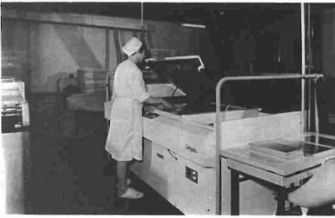
Fabrication des circuits imprimés : salle d'exposition aux ultra-violet.
