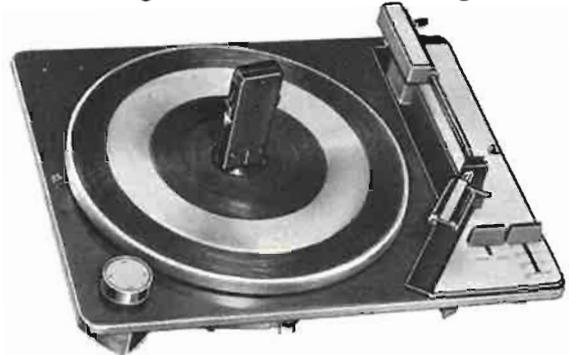
Changeur automatique tous disques, tous diamètres (17, 25 ou 30 cm), vitesses 16 - 33 - 45 - 78 tours, plateau grand diamètre à équilibrage dynamique, bras tubulaire compensé, pression réglable, moteur 110/220 V, dim. 380 x 305 mm, haut. sur platine 55, sous platine 85 mm, suspension souple en trois points. Fournie avec cellule stéréo céramique et les centreaux 33 et 45 tours (simples et chang.).
