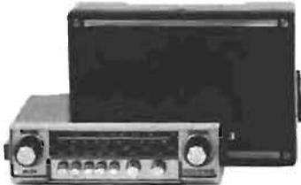
**L'AR31V.** - 8 transistors PO - GO - 4 stations préréglées - 6 W - Eclairage cadran - Alimentation : 6 - 12 V positif ou négatif - Contrôle de tonalité - Livré avec accessoires de fixation, antiparasitage et haut-parleur séparé - L 180 - H 50 - P 125 mm.
