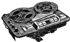
2 pistes, bobines de 150 mm. Compte-tours incorporé. Bandes passantes de 60 à 10 000 p/s. Vitesse 9,5. Commandes par clavier. Alimentation HT 250 volts, filament 6,3 V. Secteur 110 V pour le moteur. Complet, en ordre de marche, avec préampli ..... **288,00**
