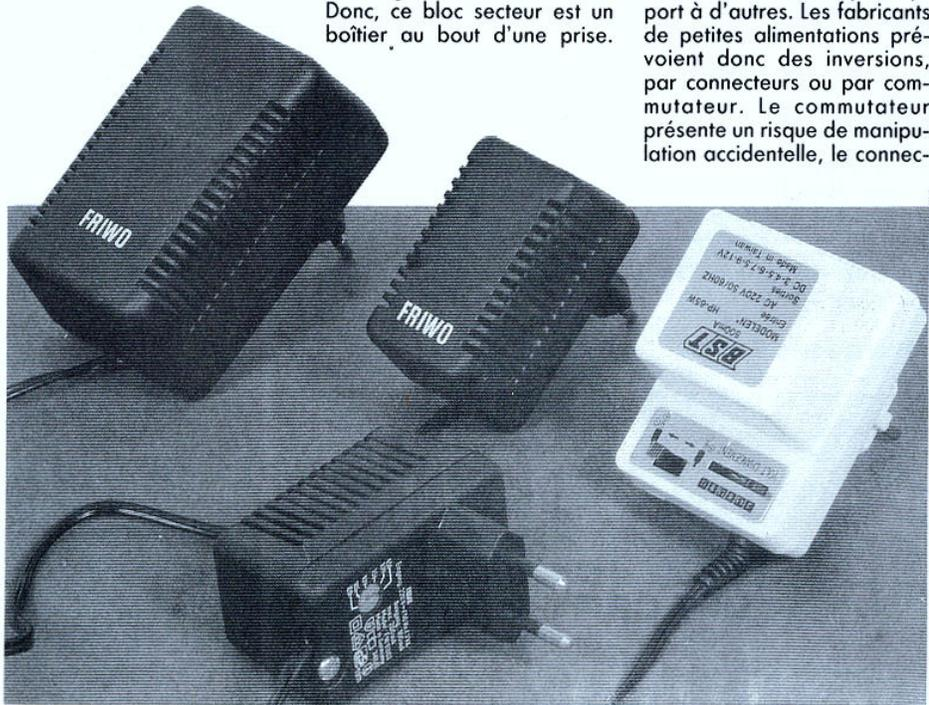
teur, un risque de débranchement accidentel et de connexion inversée, lors du rétablissement de la liaison. Donc, le fait qu'il y ait plusieurs possibilités implique des risques de courts-circuits par des fils ou des pièces métalliques ; ainsi, il sera bon de prévoir cette éventualité, par exemple en installant une gaine sur les terminaisons qui ne sont pas utilisées, les fabricants de ces petites alimenta-
