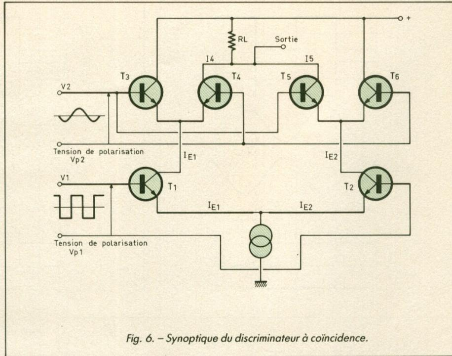
Fig. 6. - Synoptique du discriminateur à coïncidence.
