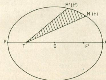
Fig. 2. - La « loi des aires » dit que la droite qui joint le centre de la Terre,  $T$ , au mobile  $M$ , balaye en un temps  $t'-t$  une surface (ici hachurée) proportionnelle au temps  $t'-t$  employé pour la balayer.
