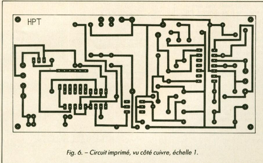
Fig. 6. - Circuit imprimé, vu côté cuivre, échelle 1.
