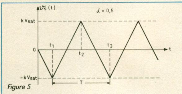
On obtient ainsi, en sortie, une tension en dents de scie symétriques d'amplitude  $kV_{sat}$ .
