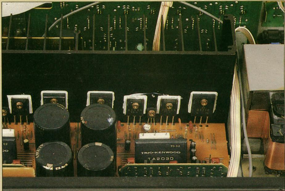
Kenwood : une technologie qui associe des transistors traditionnels et des circuits hybrides.
