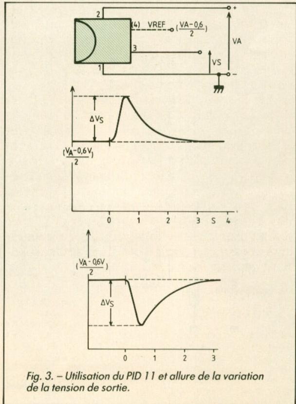
Fig. 3. - Utilisation du PID 11 et allure de la variation de la tension de sortie.
