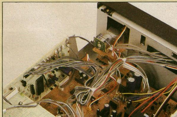
Sur l'amplificateur Sony, au fond, sur la platine verticale, se trouve le circuit de réverbération artificielle.
