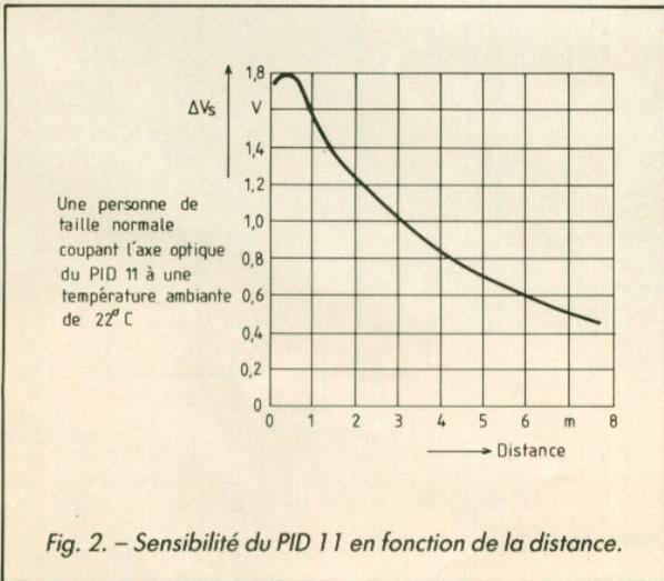
Fig. 2. - Sensibilité du PID 11 en fonction de la distance.
