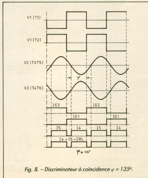
Fig. 8. - Discriminateur à coïncidence  $\varphi = 135^\circ$ .
