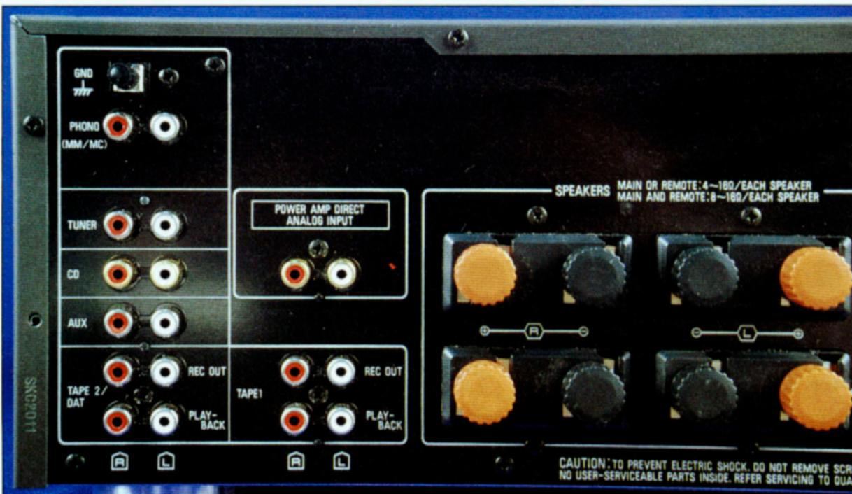
Généreux pour les raccordements audio, Technics a pensé aussi aux utilisateurs de gros câbles pour enceintes.
