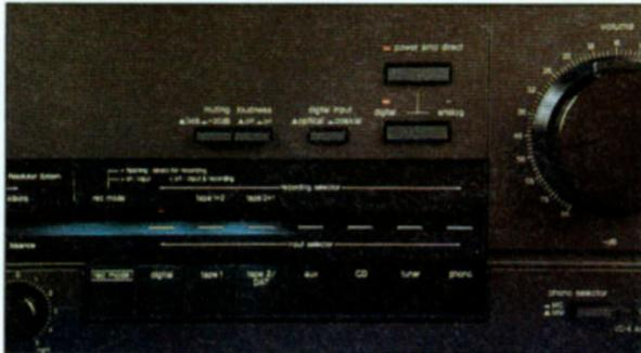
Chez Technics, le clavier de sélection des sources fait également office de sélecteur d'enregistrement, grâce à une logique intégrée.
