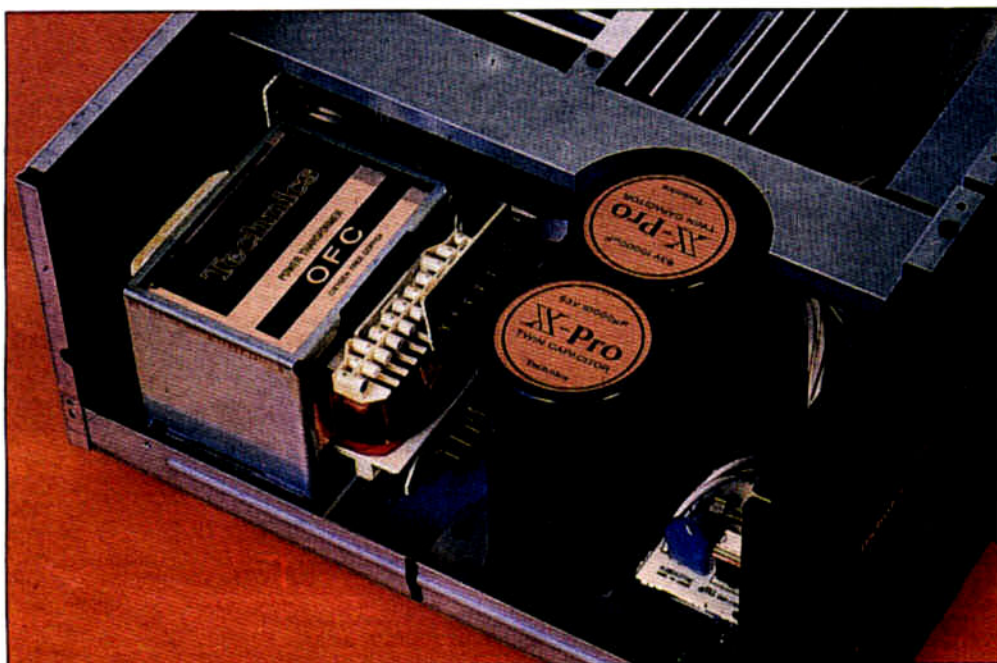
Technics. Deux condensateurs de filtrage très spéciaux, électrodes, électrolytes sont optimisés en fonction des exigences audio. Les enroulements du transformateur sont en cuivre pur, sans oxygène.
