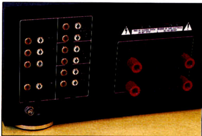
Kenwood. Des prises dorées pour toutes les entrées, des bornes de sortie surdimensionnées, on raffine le contact.
