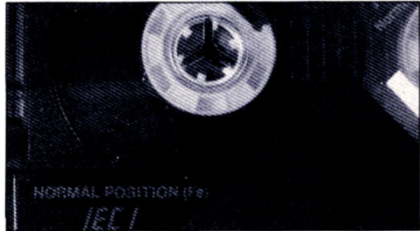
Marquage en clair à l'extérieur d'une cassette à l'oxyde de fer. Les mentions IEC I, Normal Position, Type I, 120 \mu s sont équivalentes.
