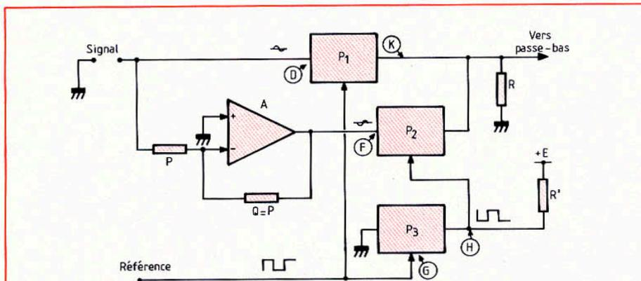
Fig. 31. - Démodulation cohérente permettant d'obtenir, vers l'entrée du filtre passe-bas (non représenté) un signal à deux alternances par période. L'amplificateur opérationnel A de gain - 1, fournit, en (F), l'opposé du signal (D) à démoduler. La porte analogique P<sub>1</sub> est commandée par la référence (G) et P<sub>2</sub> par son complément (haut quand la référence est basse et vice versa). La porte P<sub>3</sub> sert uniquement à obtenir ce complément.
