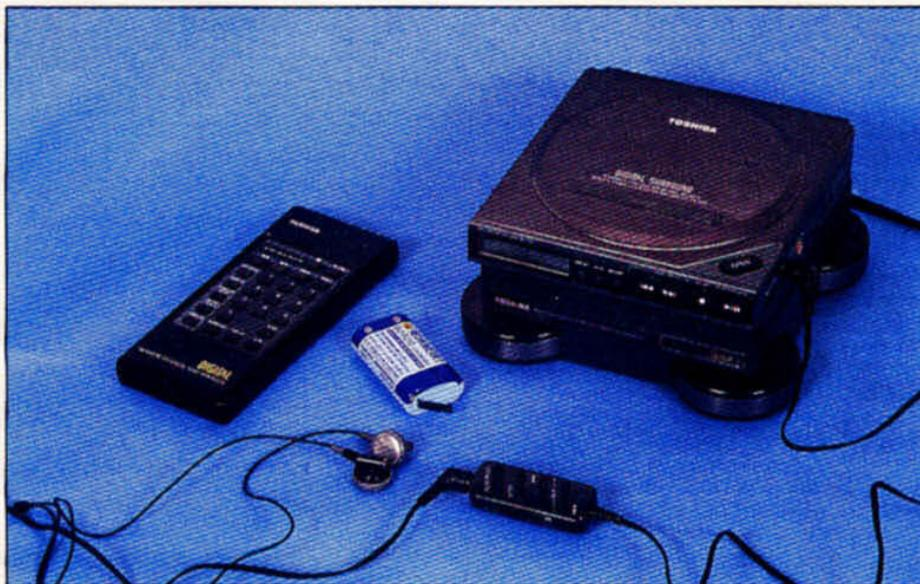
Le XR-9471 de Toshiba est fourni avec un support servant d'alimentation secteur et de récepteur de télécommande infrarouge. Il devient ainsi lecteur de salon...
