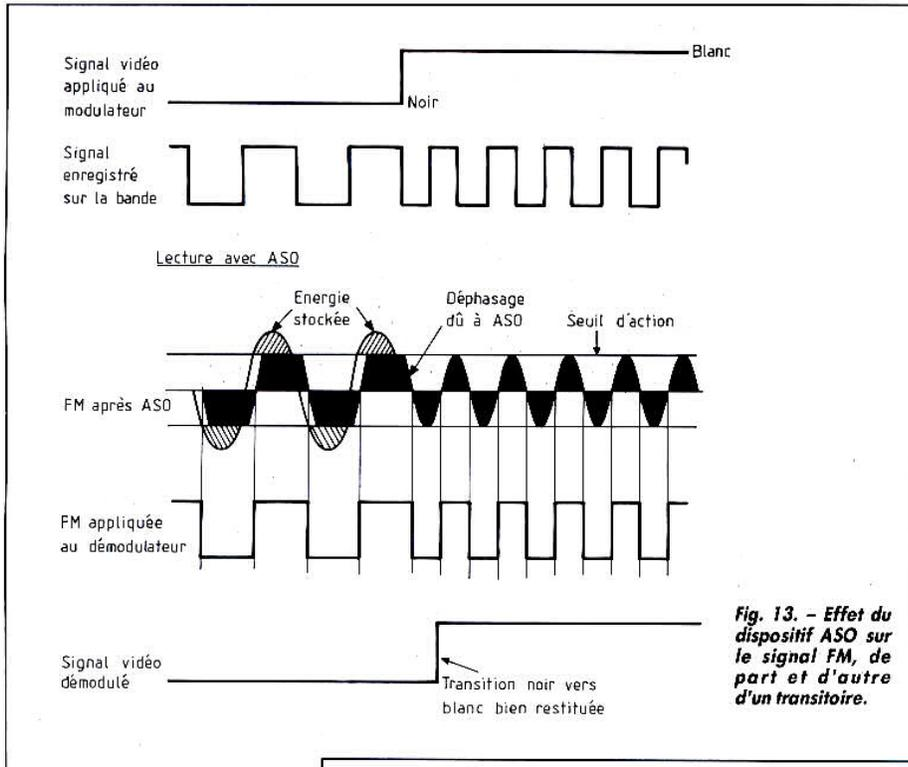
Fig. 13. - Effet du dispositif ASO sur le signal FM, de part et d'autre d'un transitoire.
