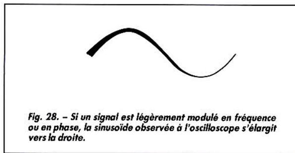
Fig. 28. - Si un signal est légèrement modulé en fréquence ou en phase, la sinusoïde observée à l'oscilloscope s'élargit vers la droite.
