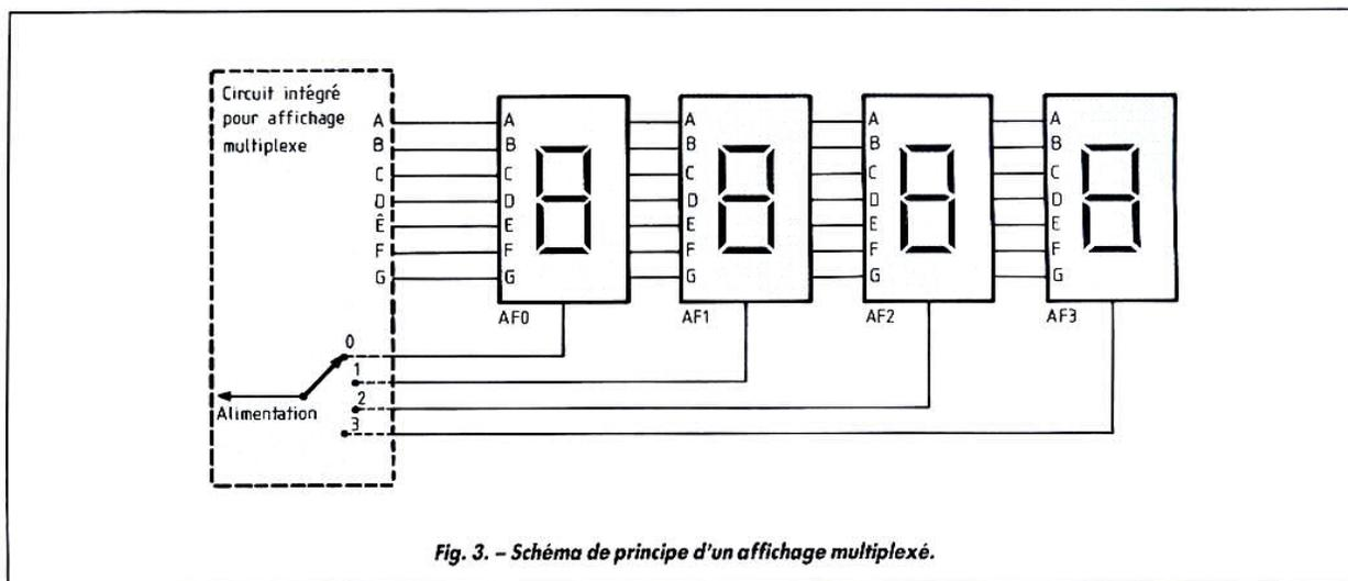
Fig. 3. - Schéma de principe d'un affichage multiplexé.
