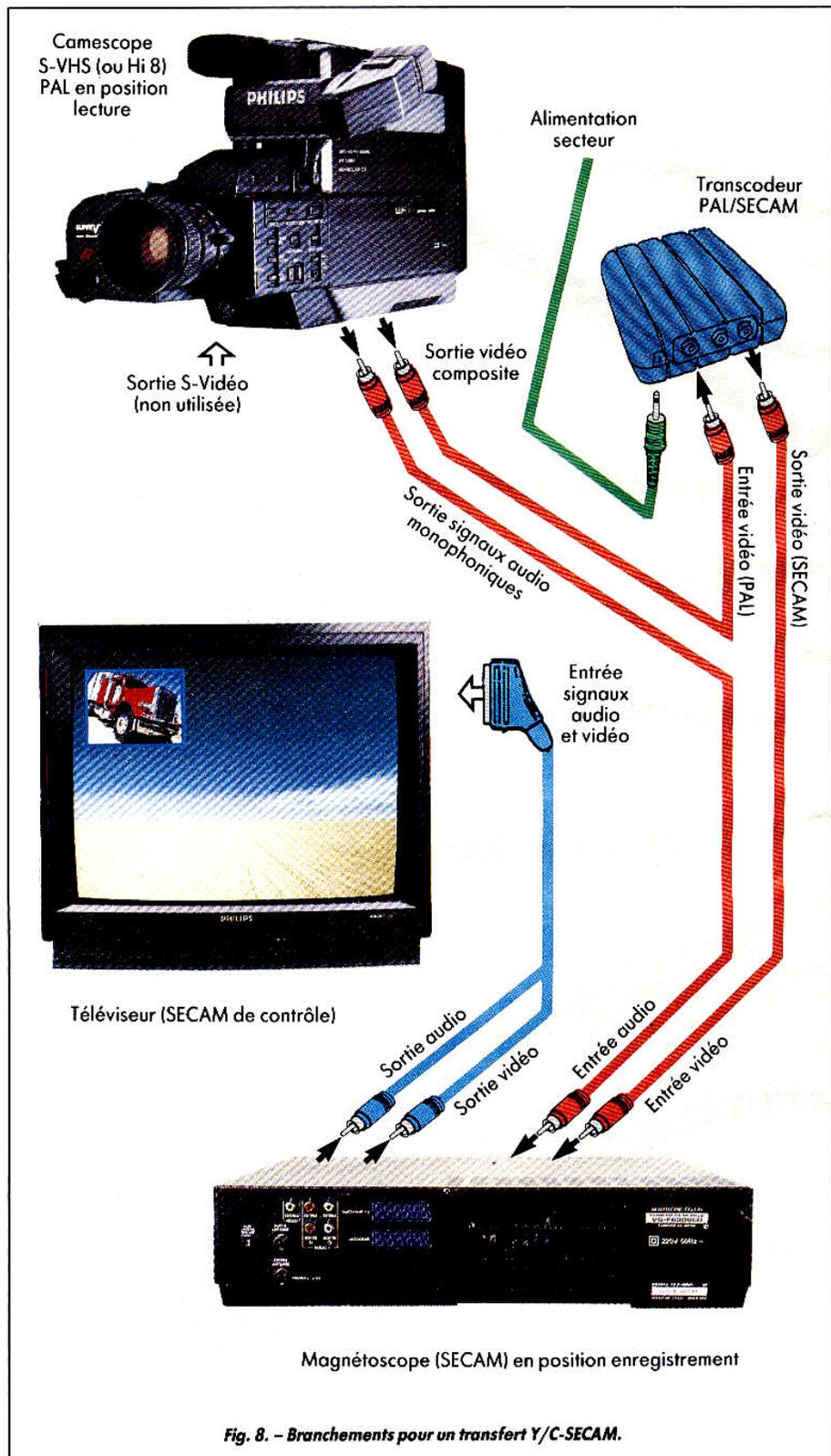
Fig. 8. – Branchements pour un transfert Y/C-SECAM.
