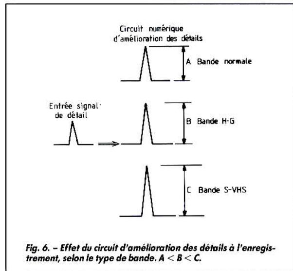
Fig. 6. - Effet du circuit d'amélioration des détails à l'enregistrement, selon le type de bande.  $A < B < C$ .
