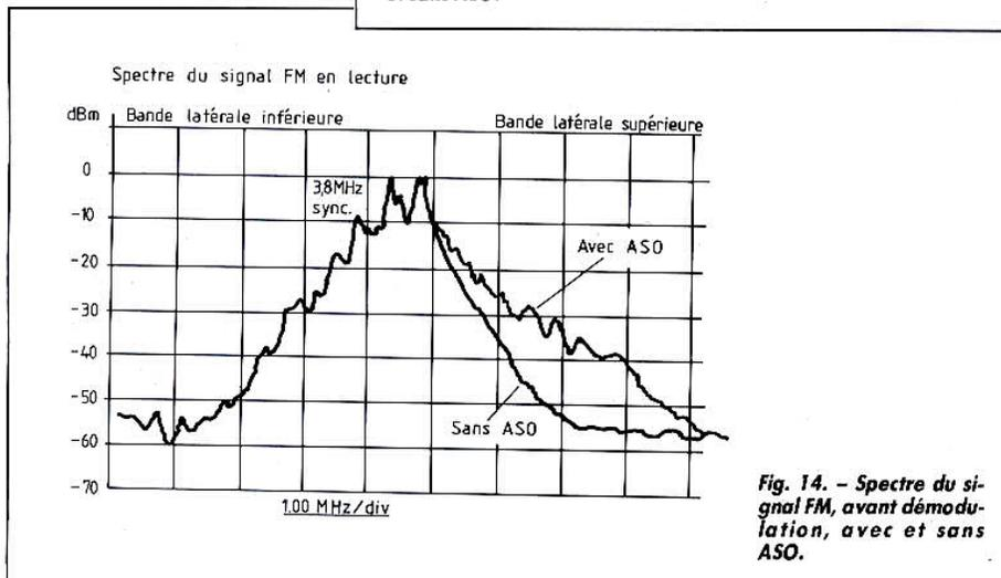
Fig. 14. - Spectre du signal FM, avant démodulation, avec et sans ASO.
