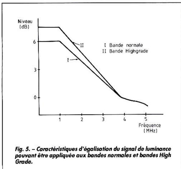
Fig. 5. - Caractéristiques d'égalisation du signal de luminance pouvant être appliquée aux bandes normales et bandes High Grade.
