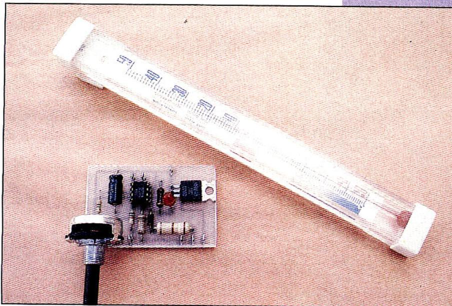
en revanche, le montage module la commande du triac, de façon à le rendre conducteur seulement pendant quelques alternances du secteur. De ce fait, la puissance appliquée à la résistance chauffante diminue sans toutefois être annulée. On arrive alors à une régulation de température au dixième de degré près sans déperdition énergétique.
