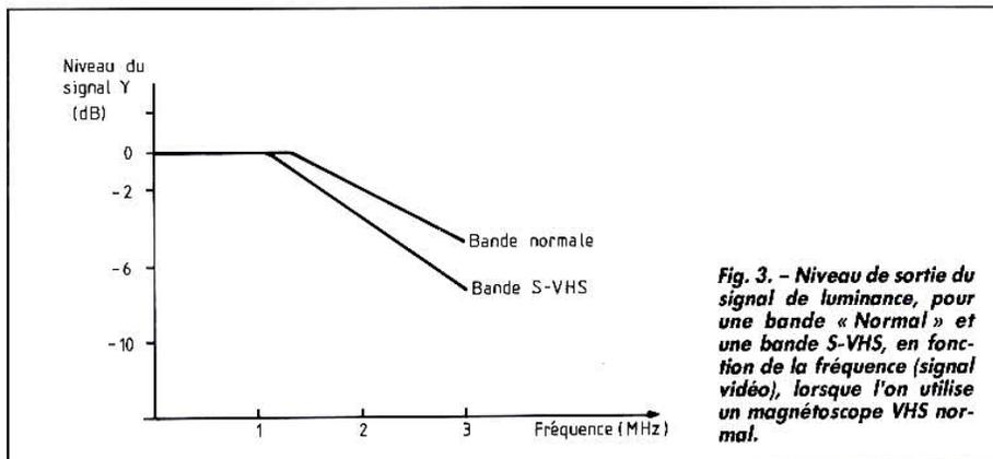
Fig. 3. - Niveau de sortie du signal de luminance, pour une bande « Normal » et une bande S-VHS, en fonction de la fréquence (signal vidéo), lorsque l'on utilise un magnétoscope VHS normal.
