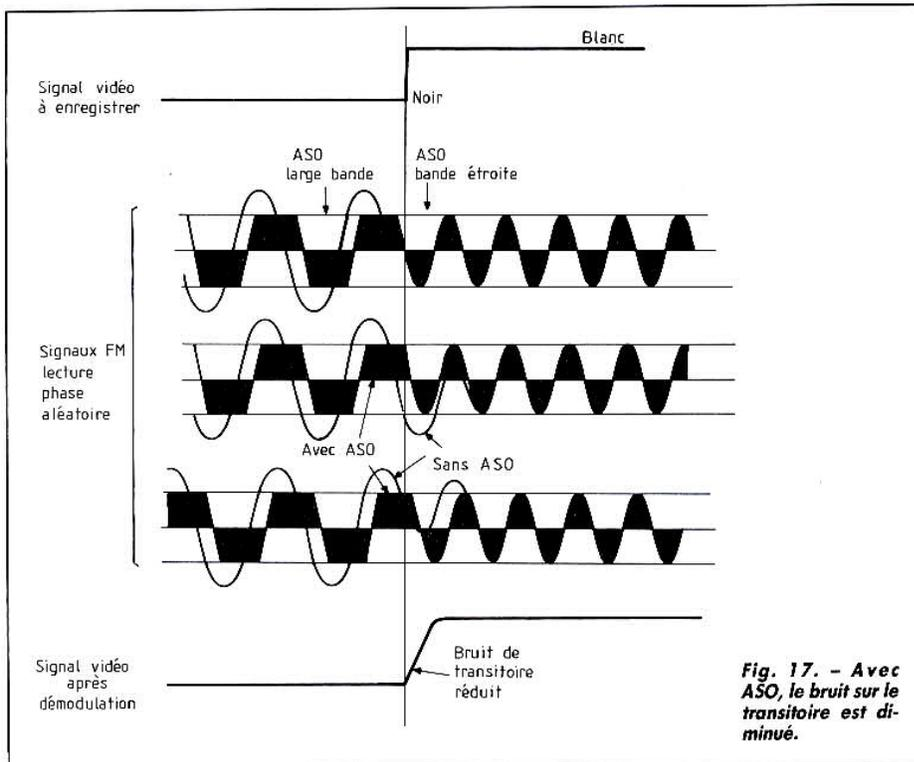
**Fig. 17.** - Avec ASO, le bruit sur le transitoire est diminué.
