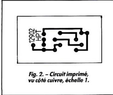
Fig. 2. - Circuit imprimé, vu côté cuivre, échelle 1.
