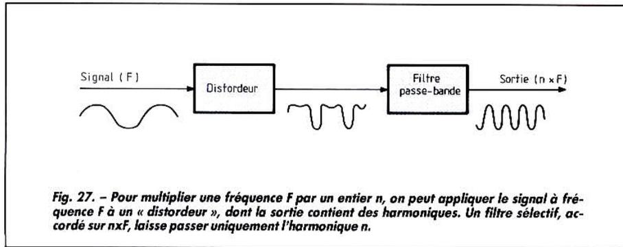
Fig. 27. - Pour multiplier une fréquence  $F$  par un entier  $n$ , on peut appliquer le signal à fréquence  $F$  à un « distordeur », dont la sortie contient des harmoniques. Un filtre sélectif, accordé sur  $nF$ , laisse passer uniquement l'harmonique  $n$ .
