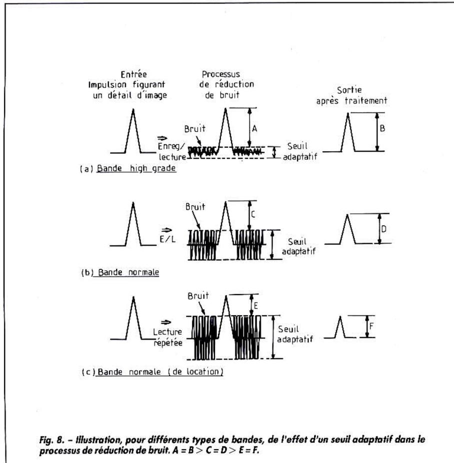
Fig. 8. - Illustration, pour différents types de bandes, de l'effet d'un seuil adaptatif dans le processus de réduction de bruit.  $A = B > C = D > E = F$ .
