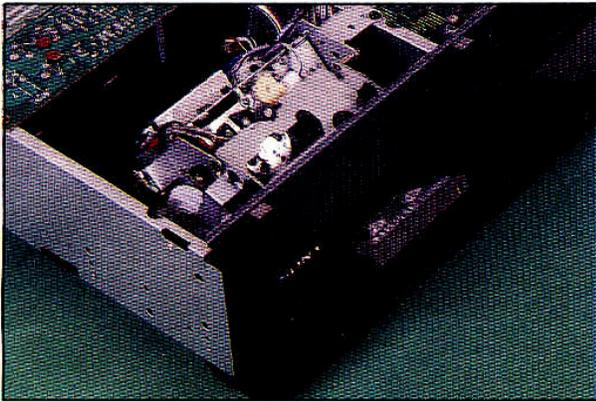
**Sony.** Introduction frontale de la cassette, elle entre dans une mécanique oblique qui laisse voir la cassette tourner au travers de la porte vitrée. Au-dessus du tambour, un petit cylindre de mousse enlève la poussière avant installation de la bande.
