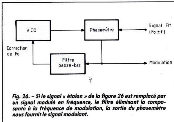
Fig. 26. - Si le signal « étalon » de la figure 26 est remplacé par un signal modulé en fréquence, le filtre éliminant la composante à la fréquence de modulation, la sortie du phasemètre nous fournit le signal modulé.
