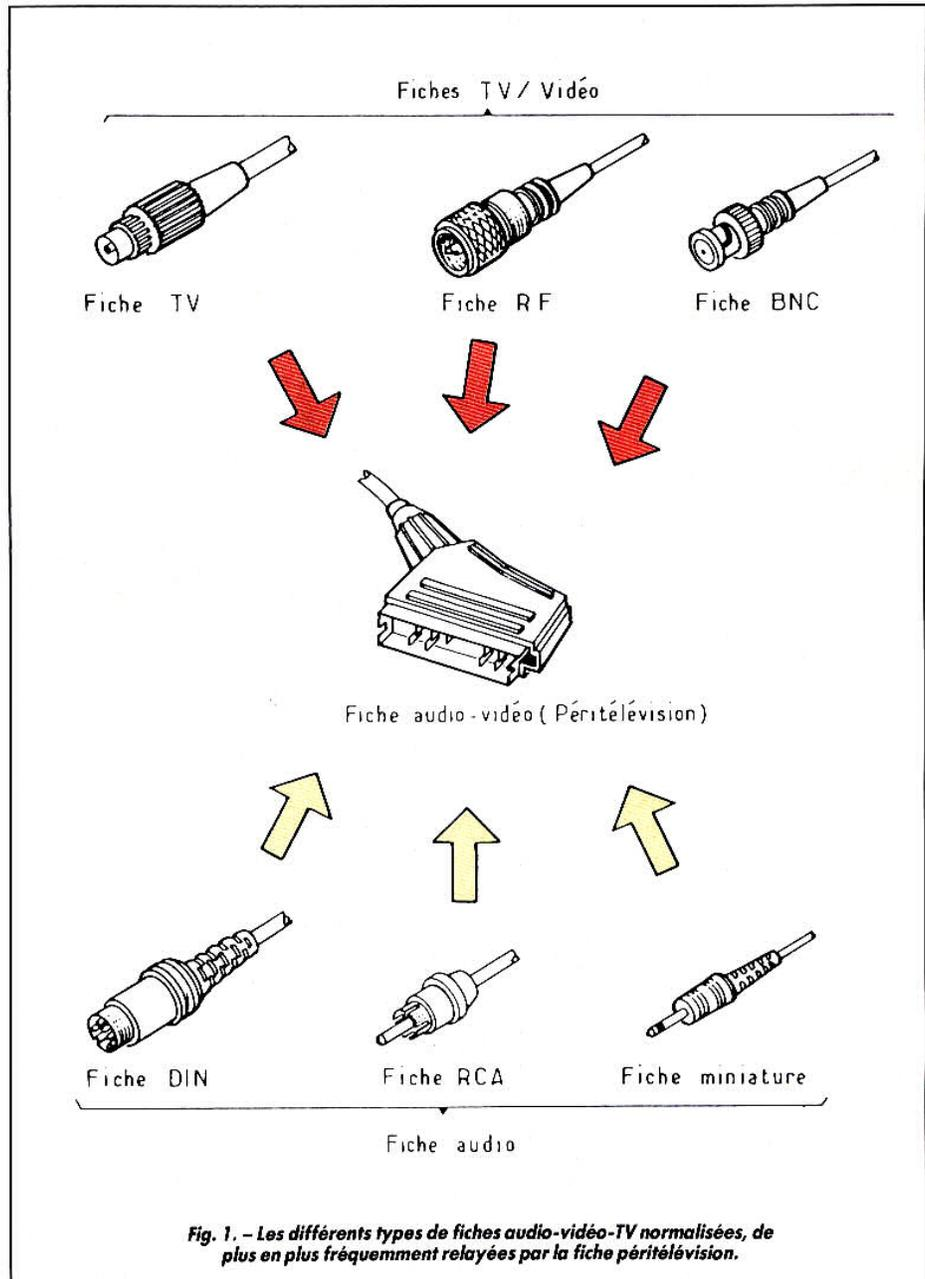
Fig. 1. – Les différents types de fiches audio-vidéo-TV normalisées, de plus en plus fréquemment relayées par la fiche péritélévision.
