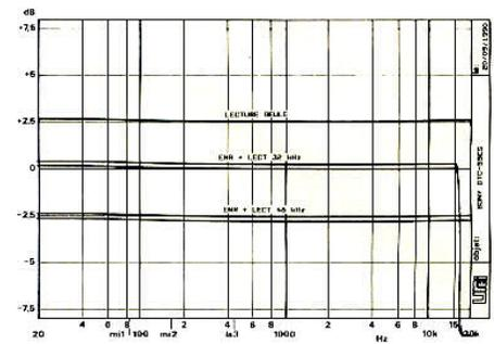
**Courbe de réponse en fréquence du magnétophone DAT Sony DTC-55ES.** L'échelle verticale est dilatée. En haut, lecture d'une bande enregistrée à partir d'un CD. Au milieu, lecture après enregistrement d'une fréquence glissante à 32 kHz de fréquence d'échantillonnage. En bas, même procédure, mais à 48 kHz. Remontée infime aux fréquences les plus basses.
