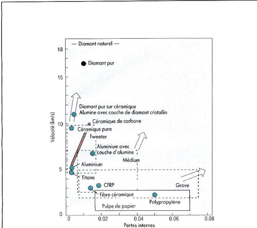
Fig. 2. - Equilibre entre la vitesse (en km/s) et les pertes dans le matériau constitutifs des diaphragmes ; en tirets, les zones convenant aux haut-parleurs de graves, de médium et d'aigu ; en trait plein, la zone couverte par les diaphragmes (membranes) en pulpe de papier (cellulose).
