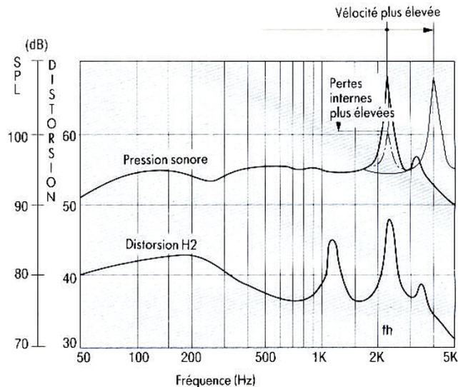
**Fig. 1. - Réponses en fréquence de divers types de diaphragmes : plus grande est la vélocité du son dans le matériau et plus élevée est la fréquence de résonance  $f_h$  ; plus les pertes dans le matériau sont grandes et plus la résonance est amortie.**
