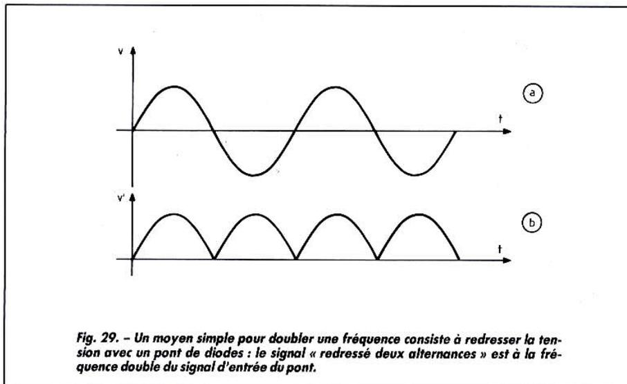
Fig. 29. - Un moyen simple pour doubler une fréquence consiste à redresser la tension avec un pont de diodes : le signal « redressé deux alternances » est à la fréquence double du signal d'entrée du pont.
