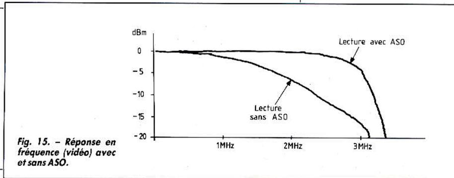
Fig. 15. - Réponse en fréquence (vidéo) avec et sans ASO.
