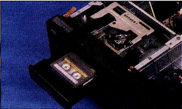
**JVC.** Une mécanique horizontale à chargement par tiroir. Au fond, le petit tambour et son cylindre nettoyant. C'est le concept magnétoscope en miniature.
