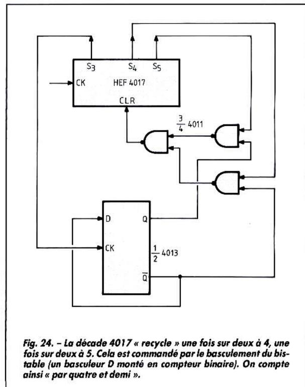
Fig. 24. - La décade 4017 « recycle » une fois sur deux à 4, une fois sur deux à 5. Cela est commandé par le basculement du bistable (un basculeur D monté en compteur binaire). On compte ainsi « par quatre et demi ».
