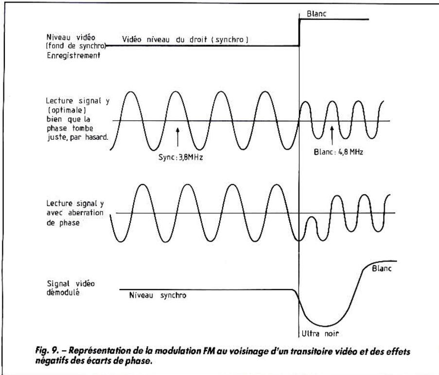
Fig. 9. - Représentation de la modulation FM au voisinage d'un transitoire vidéo et des effets négatifs des écarts de phase.
