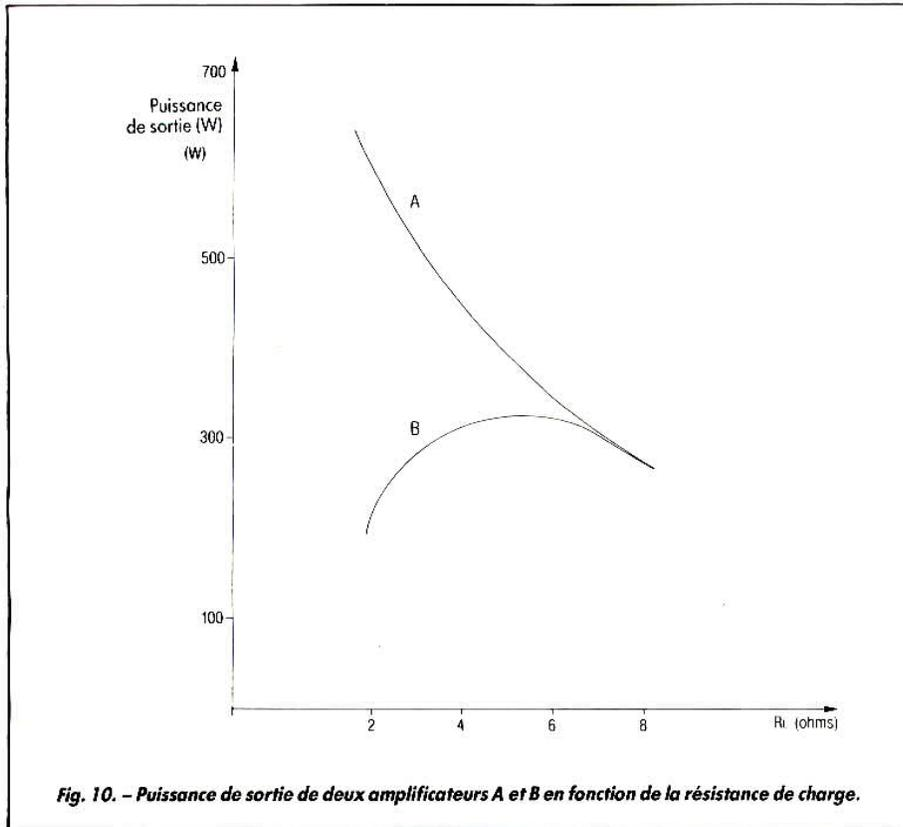
Fig. 10. - Puissance de sortie de deux amplificateurs A et B en fonction de la résistance de charge.
