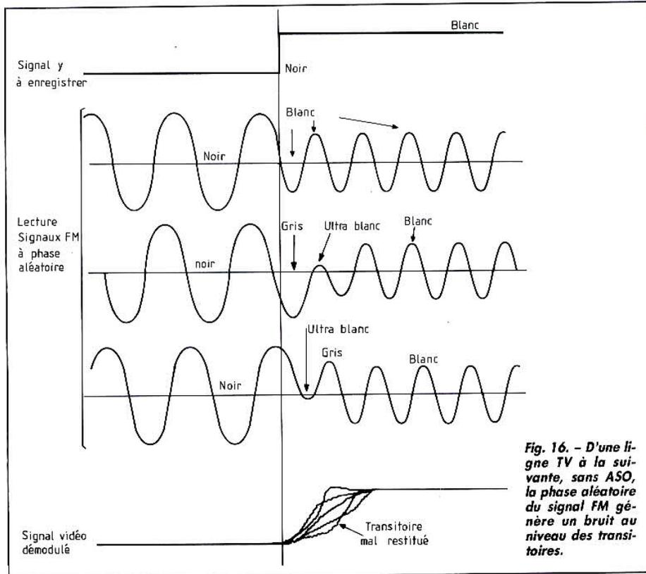
**Fig. 16.** - D'une ligne TV à la suivante, sans ASO, la phase aléatoire du signal FM génère un bruit au niveau des transitoires.
