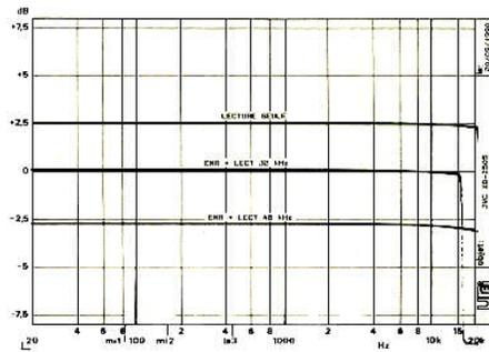
**Courbe de réponse en fréquence du magnétophone DAT JVC-Z505.** L'échelle verticale est dilatée. En haut, lecture d'une bande enregistrée à partir d'un CD. Au milieu, lecture, après enregistrement, d'une fréquence glissante à 32 kHz de fréquence d'échantillonnage. En bas, même procédure, mais à 48 kHz. Nous notons une très légère chute de niveau aux fréquences les plus hautes.
