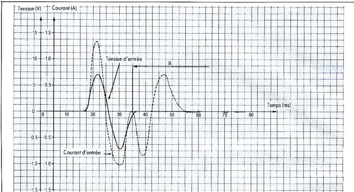
Fig. 8. - Variations instantanées, en fonction du temps, de la tension et du courant dans un haut-parleur au cours d'un cycle d'un signal à 50 Hz.
