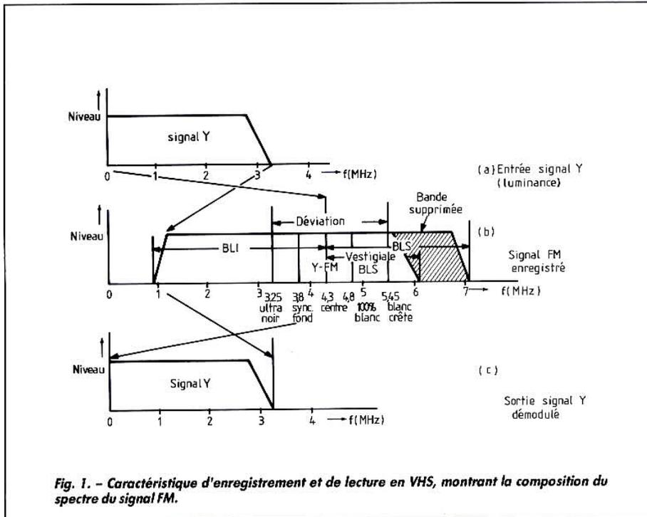
Fig. 1. - Caractéristique d'enregistrement et de lecture en VHS, montrant la composition du spectre du signal FM.
