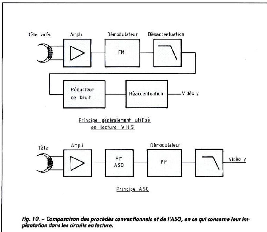
Fig. 10. - Comparaison des procédés conventionnels et de l'ASO, en ce qui concerne leur implantation dans les circuits en lecture.
