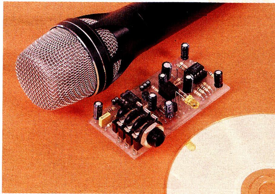
que deux photorésistances éclairées par une diode, à haut rendement de préférence. Le circuit ne présente pas de difficulté particulière. On utilisera des supports pour les circuits intégrés. Sur notre maquette, nous avons installé des contacts type « tulipe »
