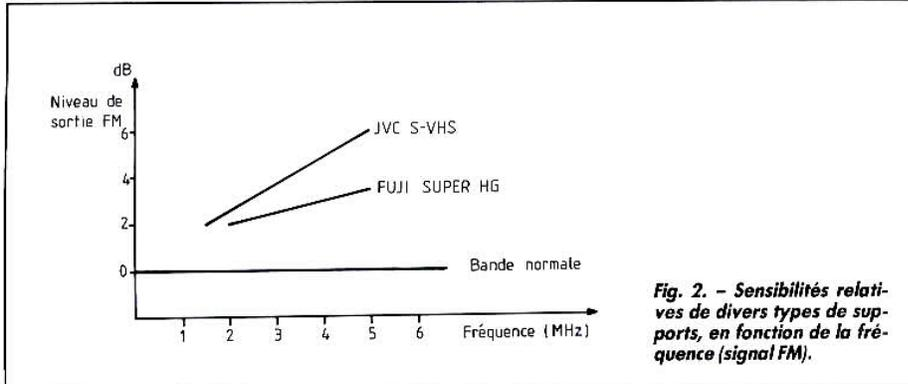
Fig. 2. - Sensibilités relatives de divers types de supports, en fonction de la fréquence (signal FM).
