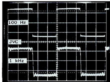
**Réponse aux signaux carrés en lecture d'une bande enregistrée à partir d'un CD sur le magnétophone DAT JVC-Z505.** En haut, 100 Hz, en bas, 1 kHz. L'échelle horizontale est de 2 ms/division pour la courbe du haut, 0,2 ms pour celle du bas. Réponse identique à celle de Sony.
