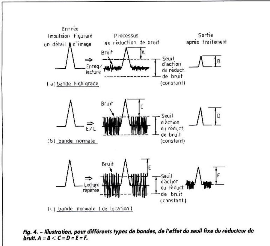
Fig. 4. - Illustration, pour différents types de bandes, de l'effet du seuil fixe du réducteur de bruit.  $A = B < C = D = E = F$ .
