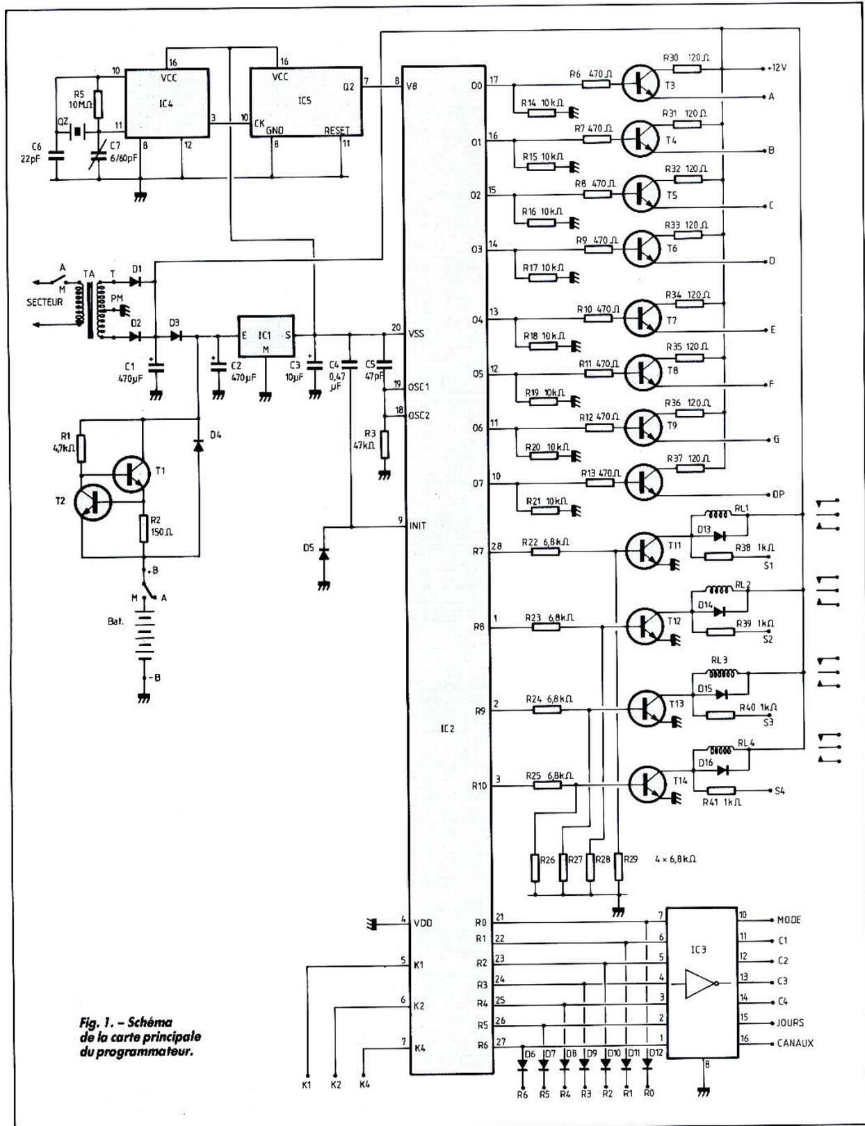
Fig. 1. - Schéma de la carte principale du programmeur.
