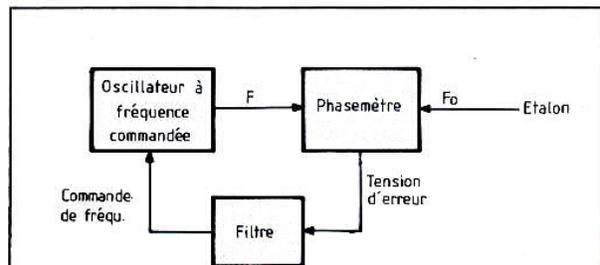
Fig. 25. - La « boucle verrouillée en phase » ou « Phase Locked Loop » (PLL) permet d'asservir la fréquence F d'un oscillateur commandé en fréquence à une fréquence « étalon »  $F_0$ , par comparaison de F et de  $F_0$  dans un phasemètre.
