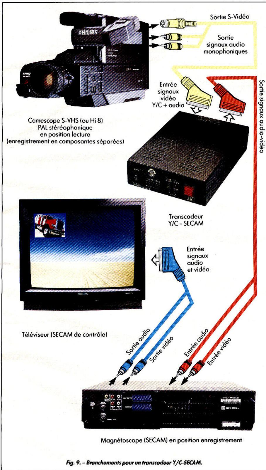
standard PAL, il s'avère indispensable d'opérer un transcodage PAL/SECAM quand on désire procéder au transfert d'enregistrements vidéo-8 sur un magnétoscope SECAM.
