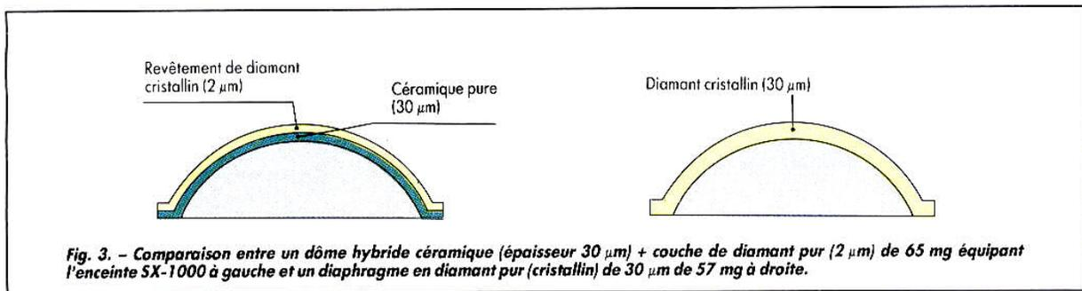
Fig. 3. - Comparaison entre un dôme hybride céramique (épaisseur 30 µm) + couche de diamant pur (2 µm) de 65 mg équipant l'enceinte SX-1000 à gauche et un diaphragme en diamant pur (cristallin) de 30 µm de 57 mg à droite.
