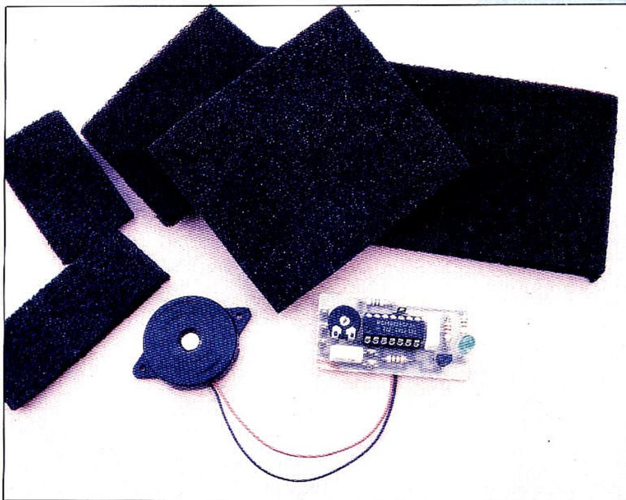
Pour détecter des variations de pression, il suffit donc de choisir une telle plaque de mousse de taille et de forme adéquates ; et de mettre un fil de chaque côté. Toute diminution de résistance entre les deux fils indiquera un écrasement, plus ou moins important, de la mousse.
