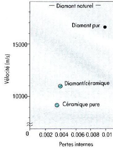
**Fig. 4. - Propriétés physiques des matériaux pour diaphragmes les plus récents considérés des points de vue vitesse et pertes internes. On pourra également se reporter au tableau I.**
