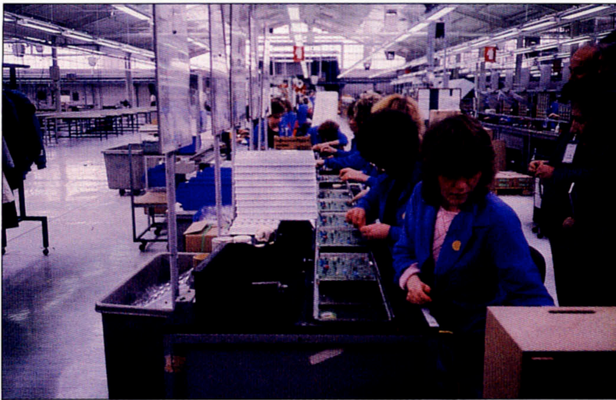
Salle claire et propre, beaucoup de monde en fin de chaîne pour la vérification des platines terminées.
