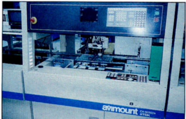
Une autre machine pour l'implantation automatique des composants.
