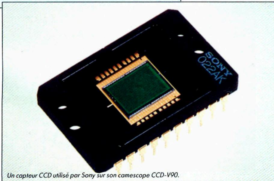
Un capteur CCD utilisé par Sony sur son camescope CCD-V90.
