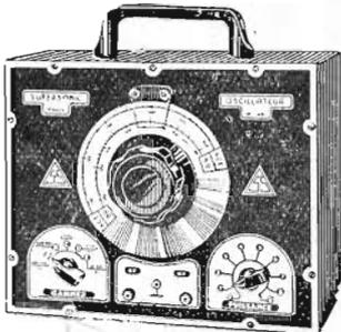
Oscillateur HAUTE FREQUENCE EN MONTAGE « Feed Back » de 100 kcs à 30 Mcs sans trous (3.000 m. à 10 m.), modulé à 400 périodes par la plaque. Atténuateur par potentiomètre blindé, alimentation tous courants entièrement isolée du coffret et du circuit de sortie. Réalisé pour le dépannage et l'étalonnage rap. des récepteurs de radio. Cet appareil est d'un transport facile. Prix ..... **7.750**
