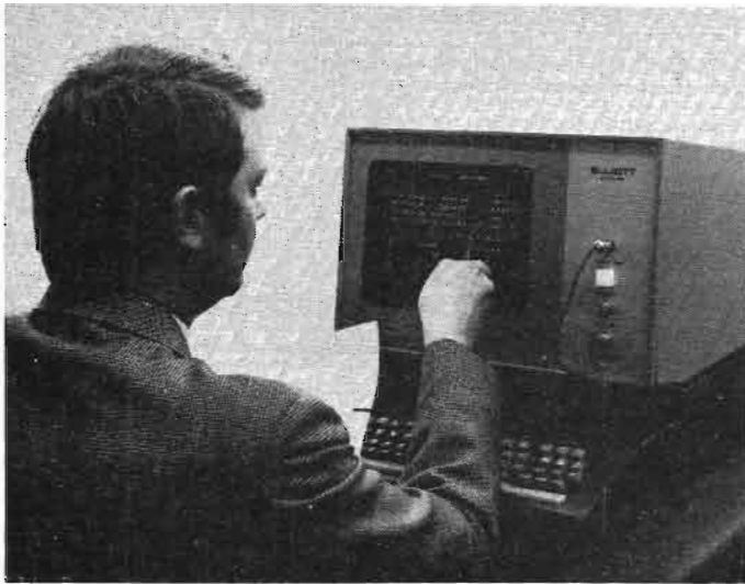
Photo 20. — Un périphérique essentiel : la console de visualisation (cliché Marconi-Elliott Computer Systems Ltd).
