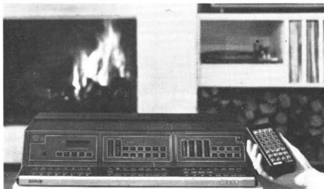
Photo C. - Barco C 3000. Un ampli-tuner aux allures de pupitre d'ordinateur. Non sans raison, il est géré par un micro-processeur. 32 fonctions commandées à distance.
