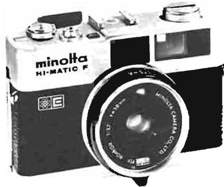
Fig. 3. — Caméra 24x36 mm à obturateur électronique programmé de 4 secondes à F : 2,7 à 1/700 sec à F : 13,5. Branchement automatique du flash avec exposition automatique. Télémètre. (Hi-Matic Minolta.)
