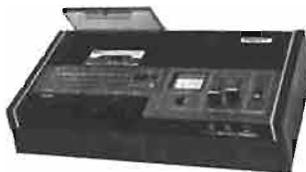
**Le magnétophone à cassettes Sony TC160.** — Magnétophone stéréo 4 pistes. Vitesse 4,8 cm/s. Réponse en fréquence : 20 à 16 000 Hz. Rapport signal/bruit : 49 dB. Distorsion harmonique : 2%. Entrées : micro : 0,2 mV/600 Ω. Aux. : 0,06 V/100 kΩ. Sortie : ligne. Casque : impédance 8 Ω. Dimensions : 400 x 127 x 276 mm.
