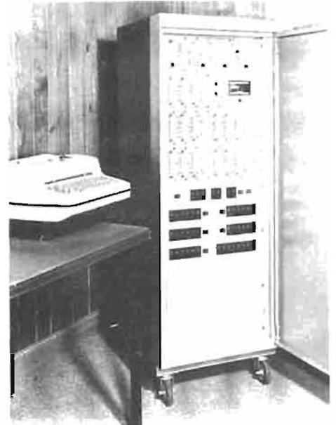
Photo n° 3 : les calculateurs analogiques ALPAM de la TELEMÉCANIQUE servent à la surveillance et au comptage de production de gaz, ainsi qu'à la simulation de systèmes naturels ou artificiels (chimie, biologie...) et à la résolution d'équations algébriques et différentielles en mécanique, électricité, chimie.
