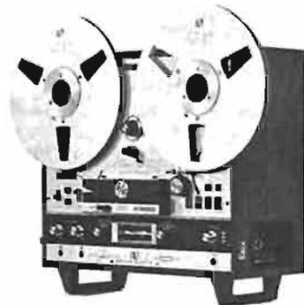
**Platine de magnétophone Akai 330D.** — Platine de magnétophone stéréophonique à 4 pistes et 3 vitesses. Inverseur de marche automatique. Vitesses : 4,75, 9,5, 19 cm/s. Diamètre max. des bobines 25 cm. 3 moteurs. 4 têtes magnétiques procédé « Cross field ». Entrées : microphone > 0,5 mV. Auxiliaire > 50 mV. Puissance : 2 x 1 W. 2 vu-mètres. 2 haut-parleurs. Bande passante à 19 cm/s : 30 à 26 000 Hz. Alimentation : 100 à 240 V, 50 Hz. Dimensions : 375 x 436 x 238 mm. Poids : 22 kg.
