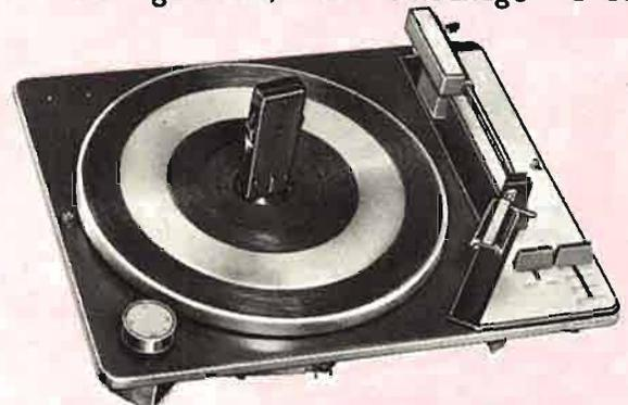
Changeur automatique tous disques, tous diamètres (17, 25 ou 30 cm), vitesses 16 - 33 - 45 - 78 tours, plateau grand diamètre à équilibrage dynamique, bras tubulaire compensé, pression réglable, moteur 110/220 V, dim. 380 x 305 mm, haut. sur platine 55, sous platine 85 mm, suspension souple en trois points. Fournie avec cellule stéréo céramique et les centreurs 33 et 45 tours (simples et chang.).
