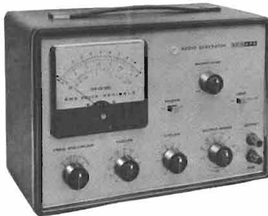
**Gamme de fréquences :** Elle couvre ce que l'on appelle les basses fréquences, mais dépasse largement, dans les deux sens, les fréquences audibles, puisqu'elle s'étend de 1 à 100 kHz.
