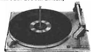
4 vitesses 16-33-45-78 tours - Plateau lourd rectifié - Changeur automatique tous disques - Fonctionnement manuel - Secteur 110/220 V - Rupteur de son - Protection de sécurité durant le transport - Le bras de lecture est équipé d'une cellule stéréo type professionnel, magnétique d'origine à pointe diamant - Livré avec câble de raccordement au secteur et cordon blindé avec fiches 5 pôles (DIN) - Centreurs 33-45 tours.
