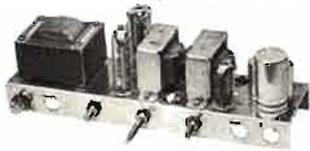
Constitué d'une double triode ECC83 et de 2 triodes-pentodes ECL86, alim. 110-220 V, contrôle GRAVES et AIGUES séparé, balance stéréo, niveau d'entrée prévu pour cellule stéréo céramique (ou cristal), encombr. 305 x 90 x 110 mm, le châssis très étroit (90) peut contenir dans l'épaisseur de n'importe quelle valise ou ébénisterie. Livré en pièces détachées pour montage par soi-même, avec 2 haut-parleurs 21 cm et schéma de montage. Prix ..... **149,00** + port et emballage 15,00
