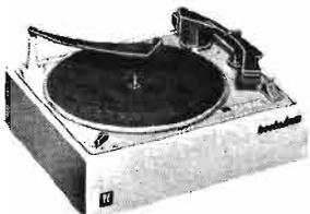
Changeur automat. monté sur socle, 16, 33, 45, 78 t., passe les disques tous diamètres (16 à 30 cm) dans n'importe quel ordre consécutif (dans une même vitesse), plateau laurd 268 mm, bras avec cellule magnét. stéréo SHURE M7DM, préampli magnét. incorporé, moteur 110/220 V - larg. 365, prof. 307, haut. 185 mm - livré avec cordon secteur et liaison BF (prise DIN 3 br.), axes changeurs 33 et 45 t. .... **299,00**
