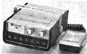
Circuits intégrés 3 watts, 6 canaux pré-réglés par touches, dont 1 canal équipé. Squelch très efficace. Contrôle émission-réception par voyant lumineux. Gainage antichoc. Miniaturisé au maximum
