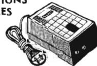
**STOLLE 3406**. Secteur 110/220 V. Sorties en courant continu stabilisé, commutable de 4-5-6-7-5-9 et 12 V par transistor puissance et diode Zener. Débit 400 mA.
