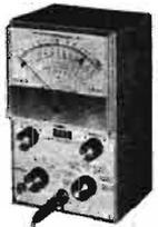
Voltmètre électronique, impédance d'entrée 11 mégohms • Mesure des tensions continues et alternatives en 7 gammes de 1,2 V à 1 200 V fin d'échelle • Résistances de 0,1 ohm à 1 000 mégohms • Livré avec sonde ..... 384,00
