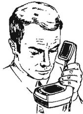
Ingénieuse combinaison du téléphone et de l'interphone. Liaison H.F. sans fil, même principe que le TMC-506 (ci-dessus). Appel sonore en interphone, conversation en duplex comme le téléphone (discretion vis-à-vis de l'entourage), très léger, fonctionne de 110 à 220 V sans commutation.
