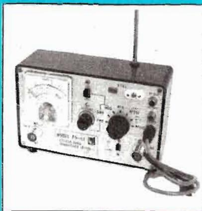
**FS117** - Laboratoire pour réglage, dépannage et mise au point d'émetteurs-récepteurs.
