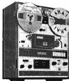
Magnétophone stéréo • Lecture automatique inversée • Contrôle automatique de volume • Freins magnétiques • Focalisation du champ magnétique • Position verticale et horizontale • Tête en verre et cristal de ferrite • 2 x 25 W • Multiplay • Monitoring • Play-back • Auto-reverse • BP 30 à 28 000 à 19,5 cm/s - 30 à 23 000 à 9,5 cm/s - 40 à 12 000 à 4,75 cm/s.
