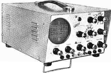
procurant sur tous les calibres une impédance d'entrée de 1 MΩ/20 pF. Une position « multipliée » par 10, porte cette impédance à 10 MΩ/12 pF. L'amplificateur est composé d'une entrée haute impédance par transistor à effet de champ (F.E.T.) suivie d'un amplificateur opérationnel intégré, permettant la visualisation de signaux jusqu'à 14 MHz (affaiblissement 2/3).
