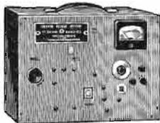
2 gammes de 14 à 27 MHz et de 100 à 235 MHz. HF pure et modulée en AM. Voltmètre de sortie. Atténuateur à piston. Alimentation secteur incorporée (110 volts). Vérifié, en très bon état de marche. Dim. : 26x33x17 cm. 270,00
