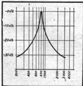
Fig. 2. — Courbe de transmission de circuit en double T.
