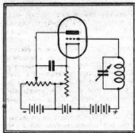
Oscillateur pour hyperfréquences utilisant une lampe à grille positive.
