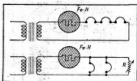
Fig. 2. — Stabilisation de la tension de chauffage par régulateur à fer-hydrogène.
