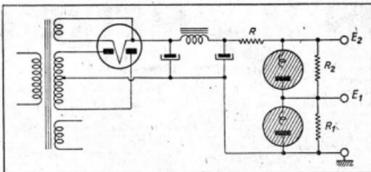
Fig. 2. — Stabilisation de la H.T. par lampes au néon.
