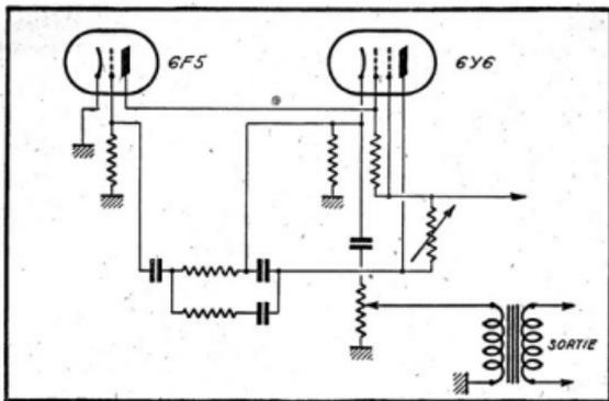
Fig. 5. — Schéma simplifié de l'oscillateur B.F. type 688 A de « General Radio ».
