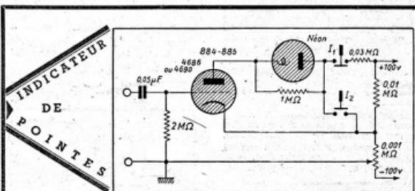
Dans l'industrie, on a quelquefois besoin d'un indicateur de limites qui signale l'augmentation variable quelconque à dépassé une grandeur donnée, et qui conserve son indication, lorsque la variable a repris sa valeur normale. Un tel cas peut se présenter, par exemple, dans l'exploitation de la radiodiffusion, pour signaler une surmodulation et maintenir cette indication jusqu'à ce qu'elle soit effacée manuellement.
