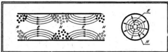
Coups longitudinale et transverse d'un guide d'ondes. Les lignes des champs électrique E et magnétique H changent de sens alternativement.
