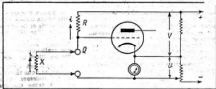
Fig. 1. — Schéma de principe du voltmètre à diode.
