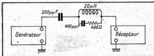
Fig. 3. — Mode d'injection des signaux à l'aide d'une antenne artificielle
