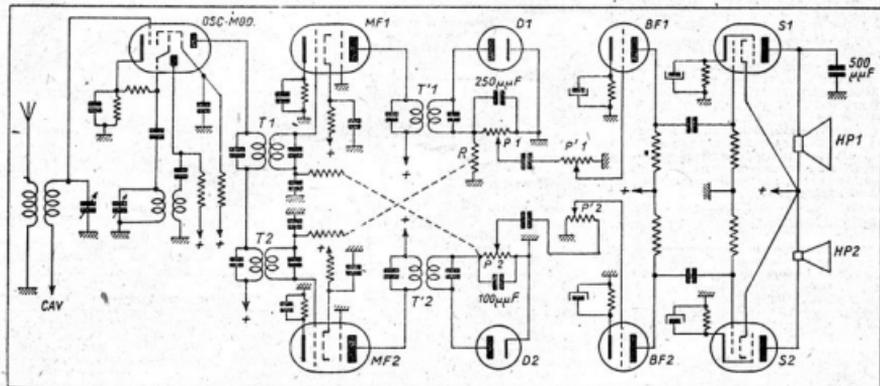
Fig. 2. — Schéma d'un récepteur réalisé selon le principe des deux canaux. En trait pointillé, connexions pour anti-fading croisé.
