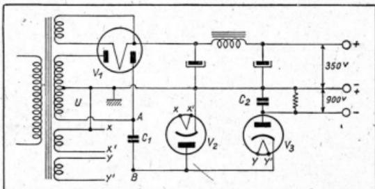
du type normal, en lui ajoutant simplement des enroulements de chauffage, ce qui est facile lorsque les fenêtres dans les tôles ne sont pas entièrement occupées.
