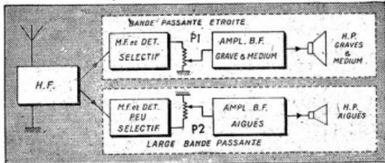
Fig. 1. — Principe du montage à deux canaux M.F. et B.F.
