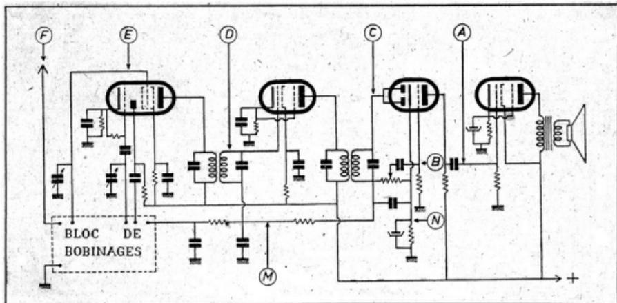
Fig. 2. — Schéma-type d'un récepteur avec indication des points de mesure.
