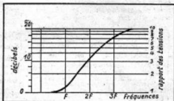
Fig. 7. — Courbe d'atténuation type (F est la fréquence de coupure choisie).
