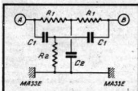
Fig. 1. — Circuit en double T qui s'avère être un filtre passe-bande.
