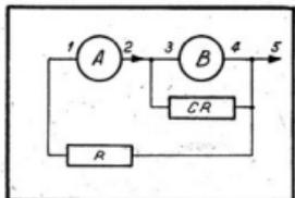
Fig. 6. — Circuits de réaction (R) et de contre-réaction (CR).
