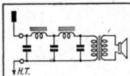
Fig. 5. — Montage direct du filtre passe-bas.
