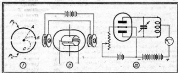
Le MAGNÉTRON. — I. Trajets des électrons en l'absence du champ magnétique en A ; dévié par un champ magnétique en B ; trajet devenant circulaire en C. — II. Vue d'un magnétron avec électro-aimants créant le champ nécessaire. — III. Montage d'un magnétron en oscillateur.
