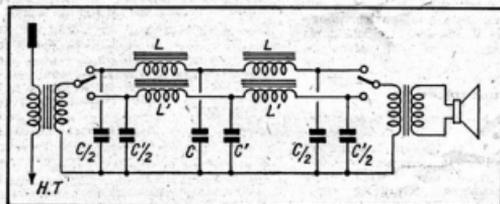
Fig. 6. — Filtre à deux fréquences de coupure.
