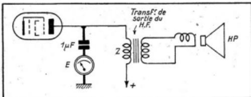
Fig. 1. — Mode de connexion du voltmètre E utilisé en wattmètre de sortie.
