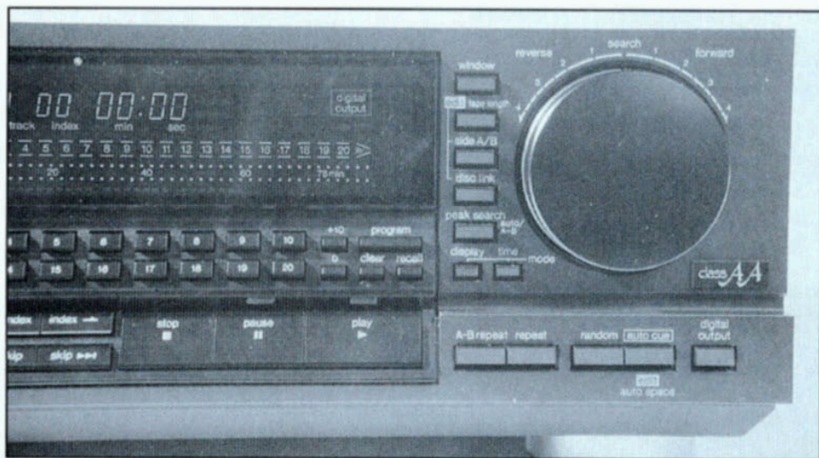
Un affichage très complet, réalisé grâce à la technique des tubes fluorescents, permet de tout visualiser. Il voisine avec une commande de recherche accélérée à bouton rotatif, sur ce modèle.
