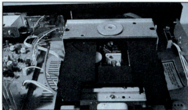
Un mécanisme simple et performant, réalisé en moulage synthétique armé de fibres.
