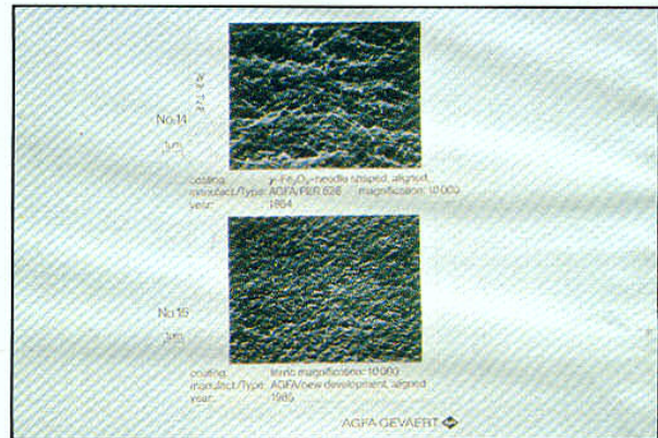
Fig. 11. – Comme figure 10, mais avec des bandes récentes (grossissement : 10 000) : – En haut, bande au Fe 2 O 3 -γ de 1984. – En bas, bande ferrique de 1985.
