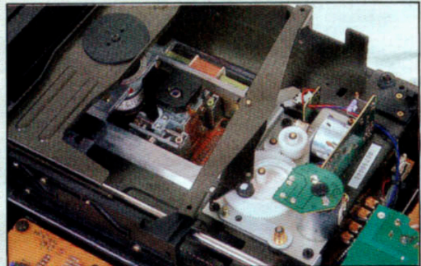
KENWOOD : une superbe mécanique : moteur linéaire, tête laser sur châssis de zamack moulé, chariot sur roulement à billes, tiroir mû par courroie crantée, etc.
