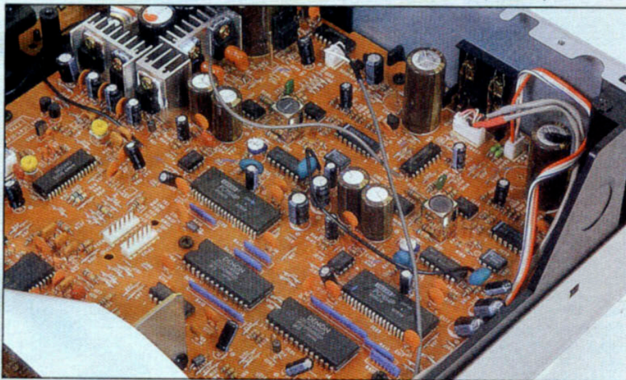
DENON : le double convertisseur à 20 bits du lecteur de CD Denon DCD-1520. Le filtre numérique 5813 à suréchantillonnage attaque en mode série des circuits spécifiques série/parallèle délivrant les 20 bits nécessaires au CNA. 18 bits sont décodés par les PCM 64, les deux derniers par des 5532 dont les résistances périphériques (réseau R-2R) sont commutées par des 4053.
