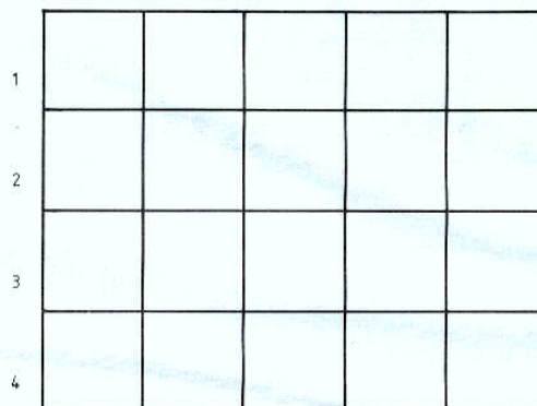
Fig. 1. – Processus 100 Hz. Exemple : quatre lignes, vingt cases. Temps d'écriture : 20 ms ; temps de lecture : 10 ms, effectué deux fois, différé de 10 ms par rapport à l'écriture.
