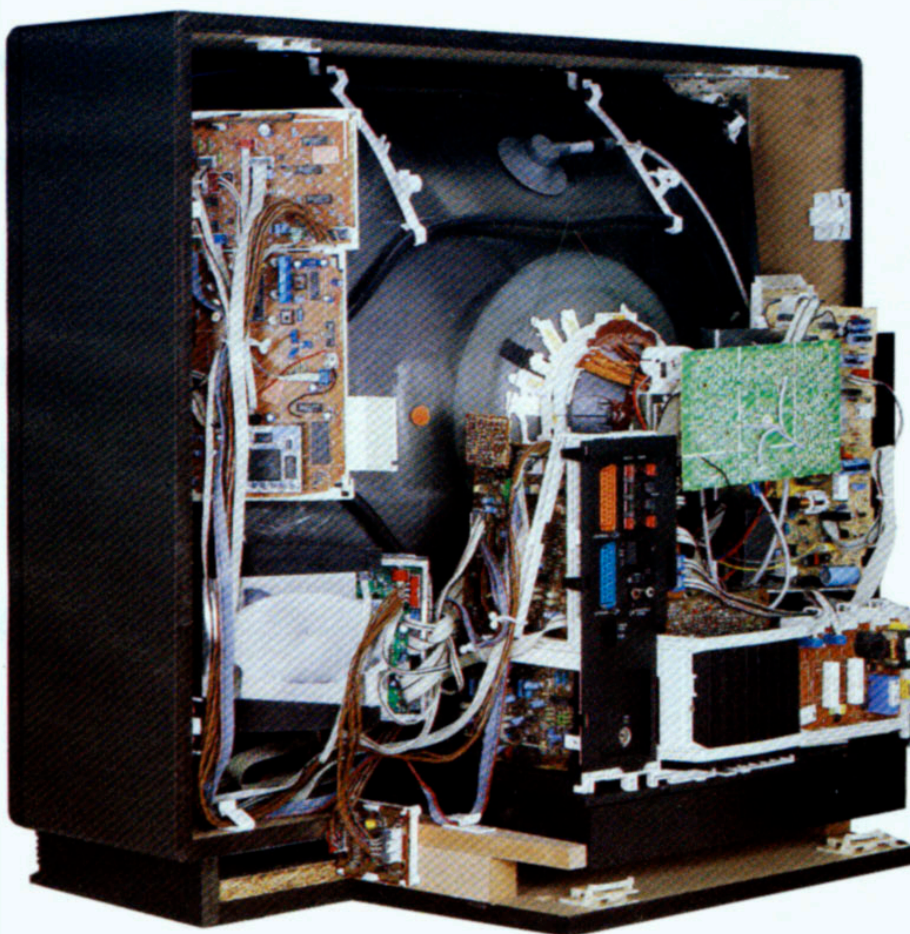
Vue arrière du téléviseur 33CE7539 100 Hz Philips. On distingue en partie gauche, en haut le module PIP, en bas le module de numérisation et de commande du dispositif de balayage (correction d'entrelacement). Les platines de balayage et d'alimentation 100 Hz, partiellement occultées, prennent place à la partie droite. En bas, ampli BF et filtre réseau.
