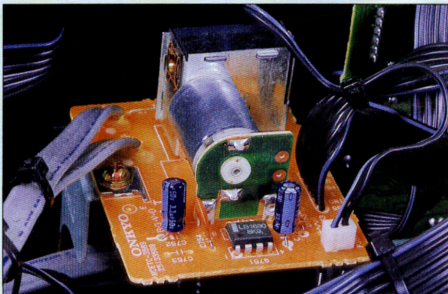
Un moteur dans un amplificateur, c'est celui du potentiomètre de volume, cet ampli est en effet télécommandé.
