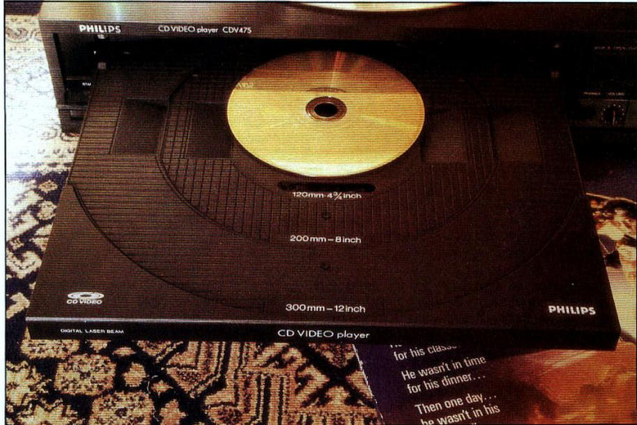
Le tiroir permet de caler les disques de diamètres 12, 20 et 30 cm. Pour les modèles 8 cm, une couronne de centrage est fournie.
