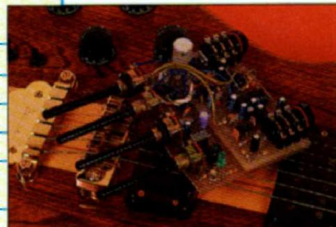
Réalisation flash : conditionnement de signal avec Flanger, page 117.
