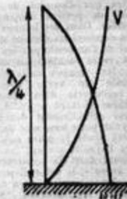
Fig. 30. — Courbes de V et I pour une antenne quart d'onde vibrant sur sa fondamentale. On voit que ces courbes sont décalées de 90°.
