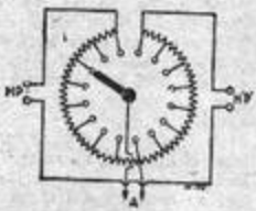
Fig. 81. — Schéma d'un fader pour le réglage du niveau de son: A, vers l'amplificateur, HP, M.P., haut-parleur.
