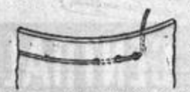
Fig. 5. — Mode de fixation du fil par simple perçage.
