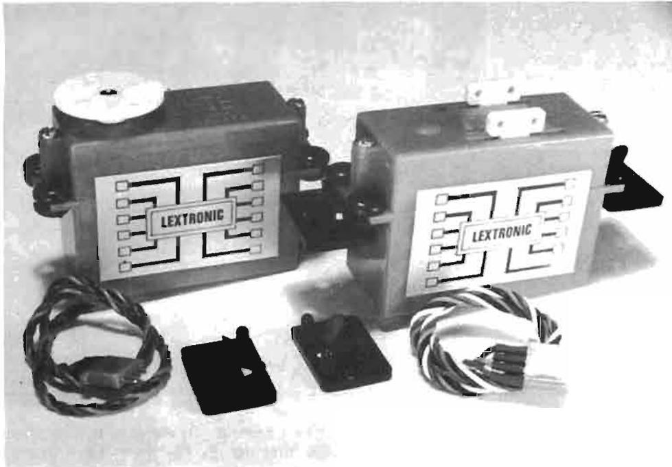
A gauche, le servo LX 75 L à mouvement rotatif.
