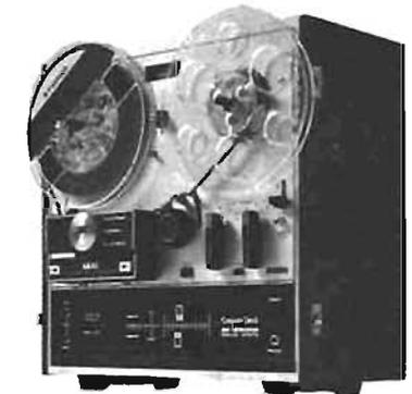
**Platine de magnétophone Akai X200D :** Magnétophone stéréophonique 4 pistes à dispositif autoreverse. 3 moteurs. Vitesses : 4,75, 9,5 et 19 cm/s. Réponse en fréquences : 30 à 26 000 Hz  $\pm$  3 dB à 19 cm/s. Distorsion : < 2% à 1 000 Hz. Rapport signal/bruit : > 50 dB. Entrées : micro : 0,5 mV; ligne : 50 mV. Sortie ligne : 1,23 V. 3 moteurs synchrones à hystérésis. Dimensions : 358 x 358 x 227 mm. Poids : 17 kg.
