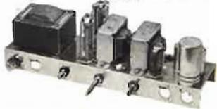
Constitué d'une double triode ECC83 et de 2 triodes-pentodes ECL86, alim. 110-220 V, contrôle GRAVES et AIGUES séparé, balance stéréo, niveau d'entrée prévu pour cellule stéréo céramique (ou cristal), encombr. 305 x 90 x 110 mm, le châssis très étroit (90) peut contenir dans l'épaisseur de n'importe quelle valise ou ébénisterie. Livré en pièces
