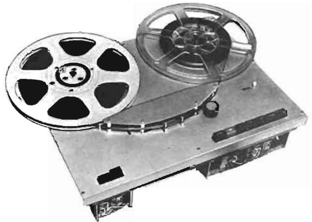
**C**ETTE platine, à laquelle devra être accouplée la partie électronique nécessaire au fonctionnement d'un magnétophone, comporte tous les éléments mécaniques et électromécaniques de l'enregistreur ainsi que les touches de commande.
