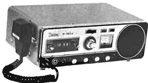
LA firme Zodiac met sur le marché un radiotéléphone fonctionnant sur la bande 27 MHz, le modèle B5024, destiné à être utilisé en station fixe, qui vient d'être homologué P.T.T. sous le n° 1215 PP.
